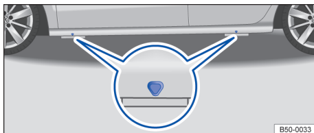
Fig. 199 Puntos de apoyo del gato.
