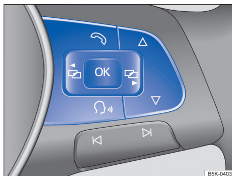
Fig. 18 Lado derecho del volante multifunción: botones para el mando de los menús y visualizaciones de información del instrumento combinado.
