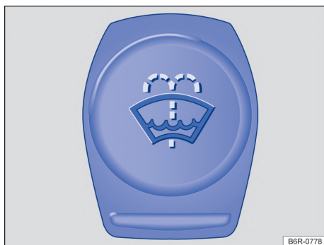
Fig. 181 En el compartimento del motor: tapa del tanque de agua de los lavaparabrisas.
