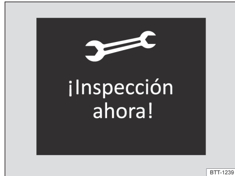
Fig. 16 En el display del instrumento combinado: ejemplo de indicación para un evento de servicio próximo a vencer (representación esquemática).
