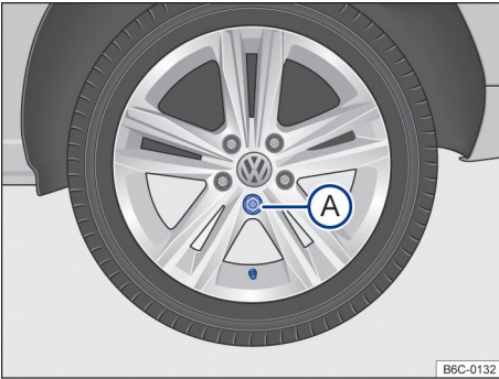
Fig. 195 Retire el tapacubos integral.
