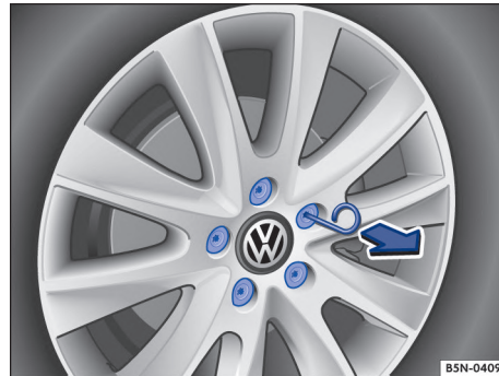
Fig. 196 Retirar las caperuzas de los tornillos de la rueda.
