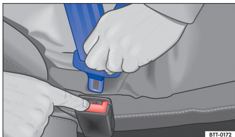
Fig. 30 Soltar la pestaña de encastre del cinturón de seguridad del cierre del cinturón.
