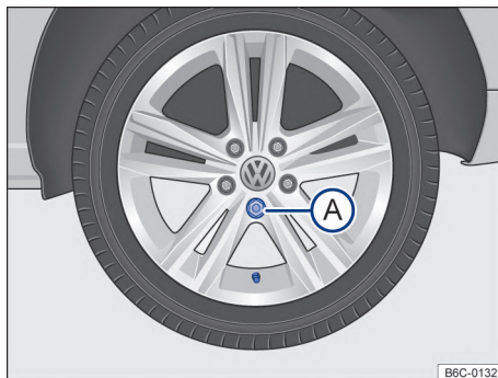
Fig. 201 Cambio de rueda: secuencia de desmontaje de los tornillos de la rueda.
