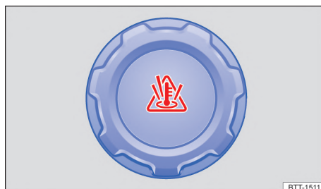
Fig. 185 En el compartimento del motor: tapa del depósito de expansión del líquido refrigerante del motor. ▶
