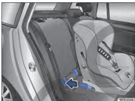
Fig. 40 Representación esquemática: montar el asiento para niños ISO-FIX con conectores.
