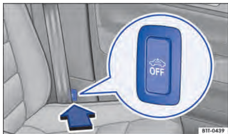
Fig. 48 Junto al asiento del conductor: tecla para desconectar la vigilancia del habitáculo y el sistema antirremolcado.
