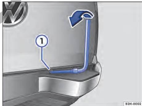
Fig. 206 Subir la rueda de repuesto mediante el cargabaterías.
