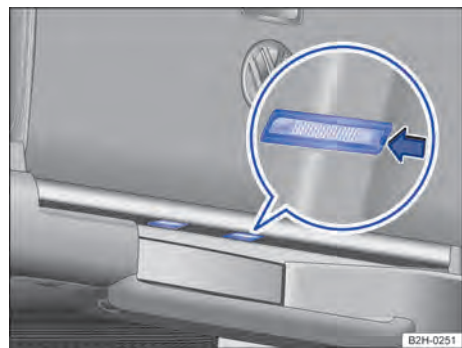
Fig. 159 En la chapa de cierre trasera, debajo de la compuerta de carga: luces de matrícula.
