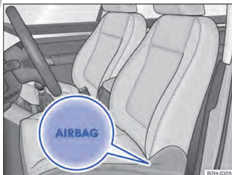
Fig. 32 Lateral de un asiento delantero: ubicación del airbag lateral para la cabeza y el tórax (variante 1).
