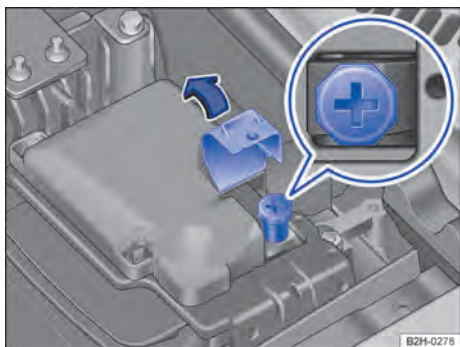
Fig. 168 En el lado izquierdo del vano motor: toma para la ayuda de arranque (polo positivo).
