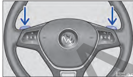
Fig. 94 Volante con levas de cambios para el Tiptronic.
