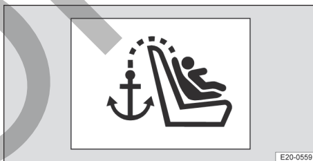
Fig. 41 Representación esquemática: distintivo del punto de fijación del cinturón Top Tether.
