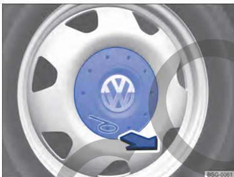
Fig. 195 Desmontar el tapacubos central tirando de él.
