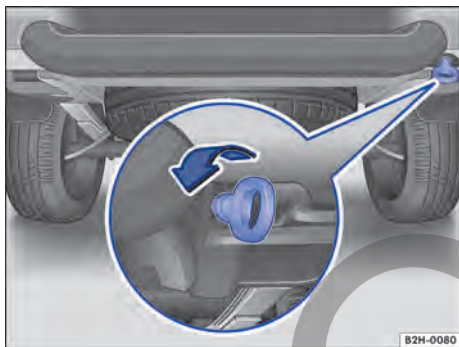
Fig. 170 En el lado derecho del paragolpes trasero: argolla de remolque enroscada.
