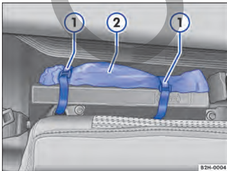
Fig. 142 Detrás del respaldo del asiento trasero: bolsa con herramientas de a bordo.
