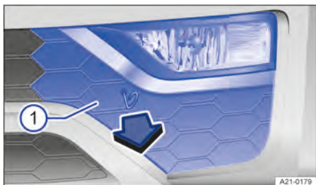
Fig. 151 En el paragolpes delantero: desmontar la cubierta.
