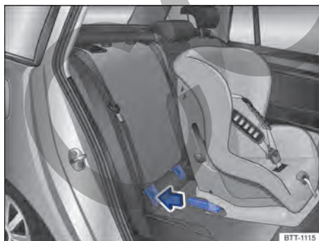
Fig. 38 Representación esquemática: montar el asiento para niños ISOFIX con conectores.
