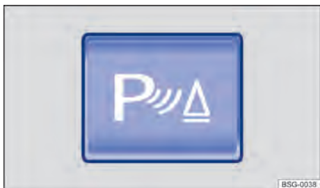
Fig. 108 En la consola central: tecla para conectar y desconectar la ayuda de aparcamiento (en función del equipamiento).
