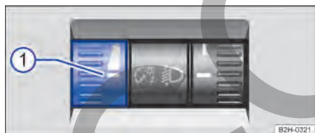
Fig. 74 Junto al volante: regulador de la iluminación de los instrumentos y los mandos.
