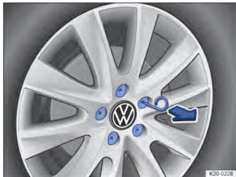
Fig. 196 Retirar las caperuzas de los tornillos de rueda.
