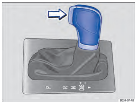
Fig. 92 Vehículos con el volante a la izquierda: palanca selectora del cambio automático con tecla de bloqueo (flecha). En los vehículos con el volante a la derecha, la disposición es simétrica.
