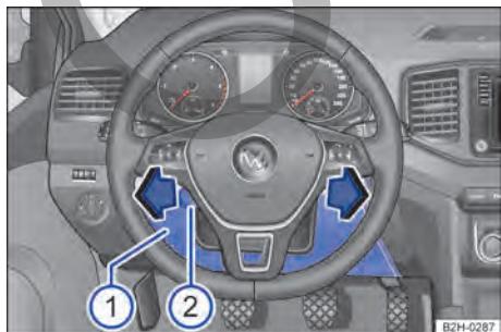
Fig. 164 En el lado del conductor, vehículos con el volante a la izquierda: caja de fusibles detrás del guarnecido del tablero de instrumentos.
