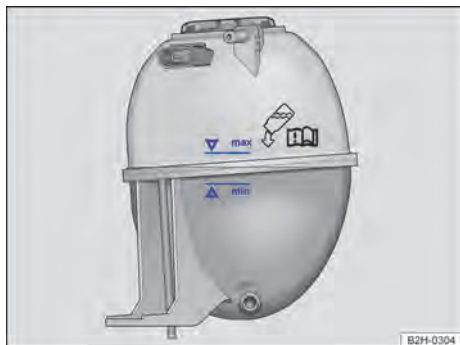
Fig. 184 En el vano motor: marca en el depósito de expansión del líquido refrigerante del motor (representación esquemática).
