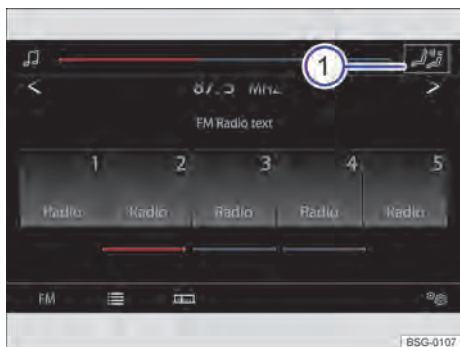
Fig. 119 Visualización en la pantalla de la consola central: botón de función para abrir la amplificación digital de la voz.
