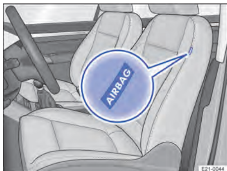
Fig. 33 Lateral de un asiento delantero: ubicación del airbag lateral para la cabeza y el tórax (variante 2).
