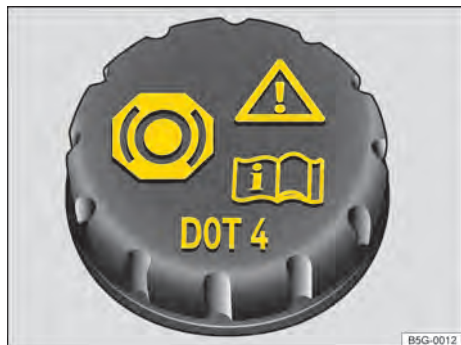
Fig. 186 En el vano motor: tapa del depósito del líquido de frenos.
