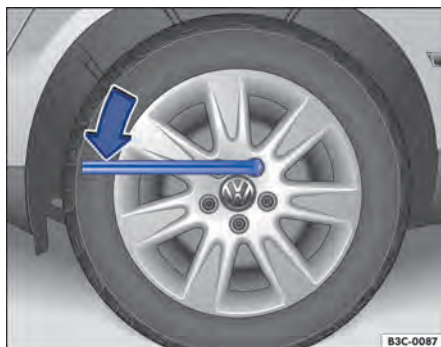
Fig. 197 Cambiar una rueda: aflojar los tornillos.
