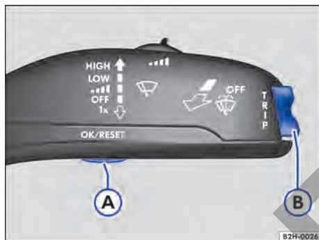
Fig. 14 En la palanca del limpiacristales: teclas para manejar los menús.
