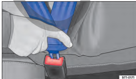
Fig. 18 Insertar la lengüeta del cinturón de seguridad en su cierre.
