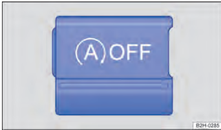
Fig. 90 En la consola central: tecla del sistema Start-Stop.
