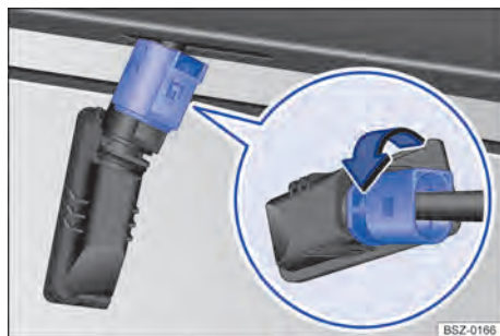
Fig. 160 Luz de matrícula: desmontaje del portalámparas.
