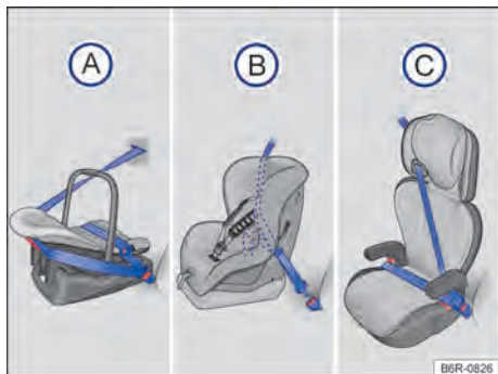
Fig. 42 Las ilustraciones (A), (B) y (C) muestran la fijación del sistema de retención infantil solo con el cinturón de seguridad del vehículo.
