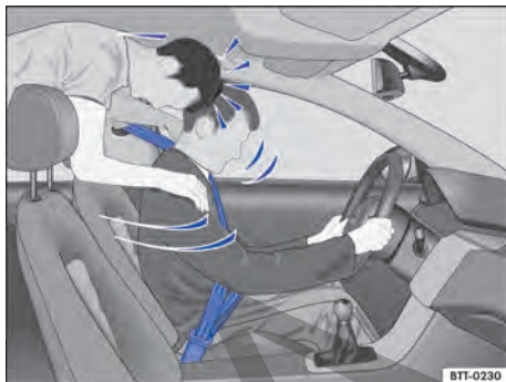
Fig. 28 El pasajero sin cinturón de seguridad en el asiento trasero es lanzado hacia adelante sobre el conductor con cinturón de seguridad.
