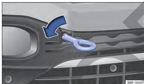
Fig. 218 En el parachoques delantero a la derecha: enrosque la argolla de remolque.
