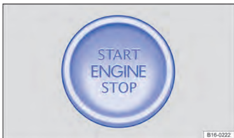
Fig. 95 En la parte inferior de la consola central: tecla de arranque para poner en marcha el motor
