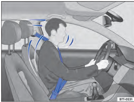
Fig. 29 Conductor protegido por el cinturón de seguridad correctamente colocado en una maniobra de frenado súbita.
