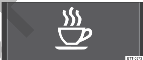
Fig. 18 En el display del instrumento combinado: símbolo del sistema de detección del cansancio.
