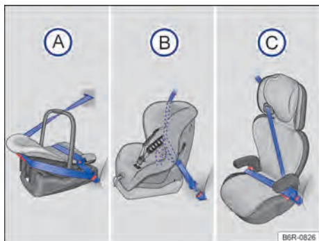
Fig. 34 Las ilustraciones (A), (B) y (C) muestran la fijación del sistema de retención infantil solo con el cinturón de seguridad del vehículo.
