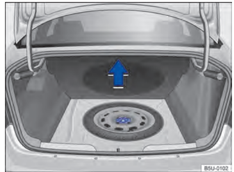
Fig. 147 En el maletero, por debajo del revestimiento del piso: rueda de emergencia y herramientas de a bordo.
