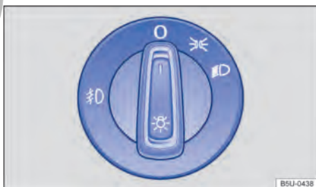
Fig. 62 Al lado del volante: interruptor de luces.
