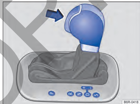
Fig. 82 Palanca selectora de la transmisión automática con tecla de bloqueo (flecha).
