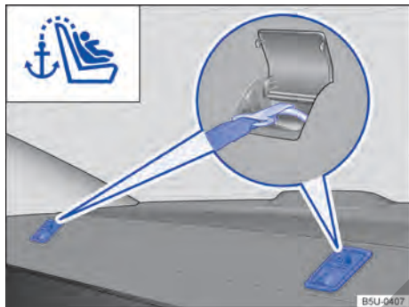
Fig. 37 Ojales de retención para el cinturón de fijación superior en la cubierta del maletero.
