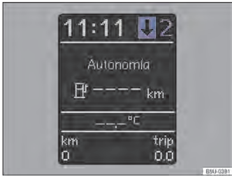
Fig. 77 En el panel de instrumentos : indicador de cambio de marcha (variante 2).
