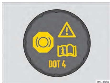
Fig. 177 En el compartimento del motor: tapón de cierre del depósito del líquido de frenos.
