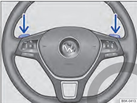
Fig. 84 Volante con selectores basculantes de Tiptronic.
