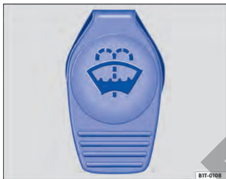
Fig. 172 En el compartimento del motor: tapa del tanque de agua de los lavaparabrisas.
