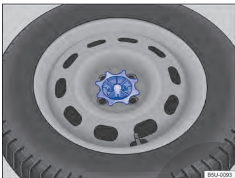
Fig. 184 En el maletero: manivela para fijación de la rueda de emergencia.
