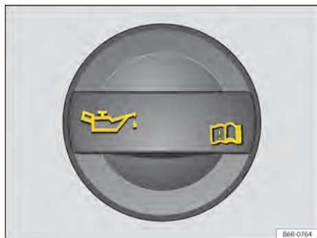
Fig. 174 En el compartimento del motor: tapón de la boca de llenado del aceite del motor.
