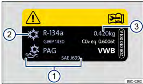
Fig. 207 Información del aire acondicionado.
