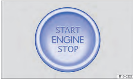
Fig. 87 En la parte inferior de la consola central: tecla de arranque para poner en marcha el motor
