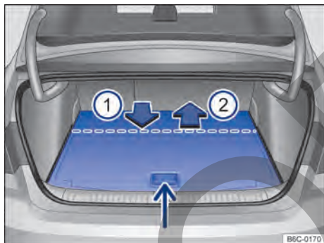
Fig. 149 En el maletero: regular la altura del piso variable del maletero.
