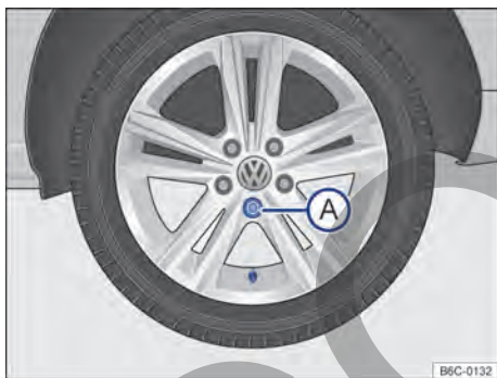
Fig. 202 Cambio de rueda: secuencia de desmontaje de los tornillos de la rueda.
