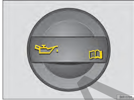
Fig. 185 En el compartimento del motor: tapón de la boca de llenado del aceite del motor.
