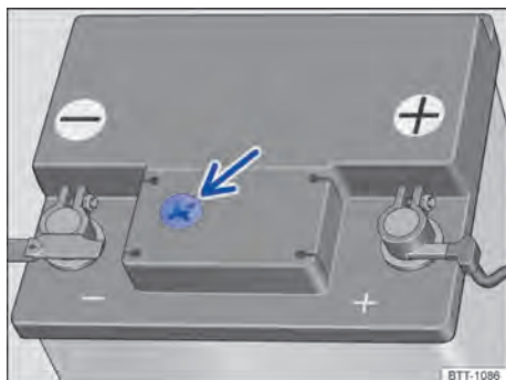
Fig. 189 En el compartimento del motor: ejemplo de posición del visor en el lado superior de la batería del vehículo.
