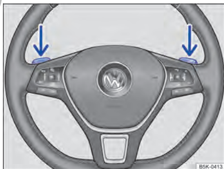
Fig. 92 Volante con selectores basculantes de Tiptronic.
