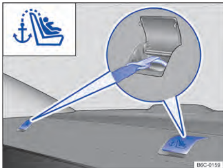
Fig. 43 Ojales de retención para el cinturón de fijación superior en la cubierta del maletero.
