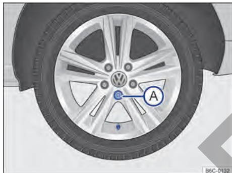
Fig. 197 Retire el tapacubos integral.
