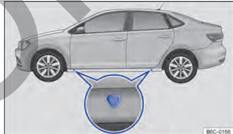
Fig. 200 Puntos de apoyo del gato.
