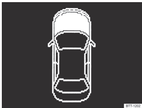
Fig. 179 En la pantalla del cuadro de instrumentos: capó del motor abierto o no cerrado correctamente.
