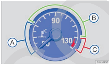
Fig. 49 Indicador de temperatura del líquido refrigerante del motor en el cuadro de instrumentos.
