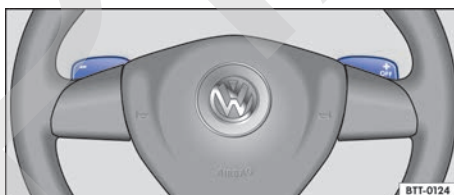
Fig. 103 Volante con levas de cambio para el Tiptronic.
