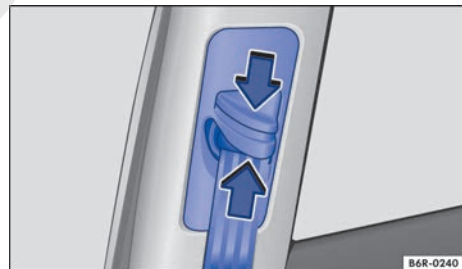
Fig. 26 Junto a los asientos delanteros: regulador de la altura del cinturón.
