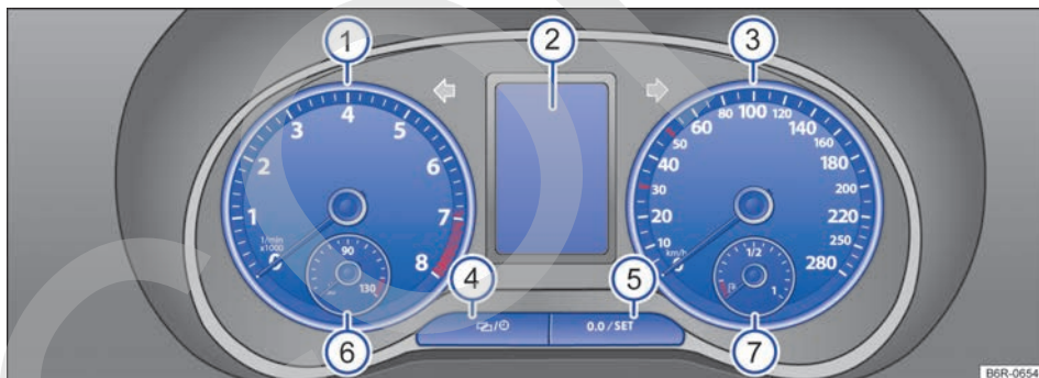
Fig. 46 Cuadro de instrumentos en el tablero de instrumentos: variante 2.
