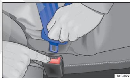
Fig. 23 Soltar la lengüeta del cierre del cinturón.
