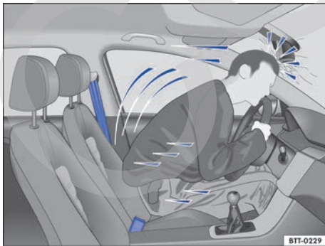
Fig. 19 El conductor sin el cinturón de seguridad colocado sale lanzado hacia adelante.
