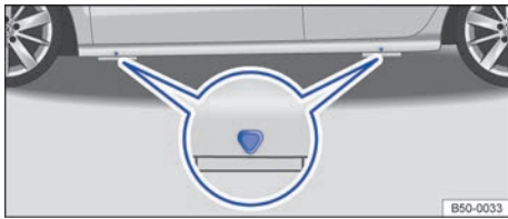
Fig. 201 Puntos de apoyo para el gato.
