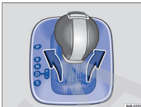
Fig. 104 Desmontar la cubierta de la corredera de la palanca selectora.
