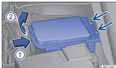
Fig. 168 En la parte delantera izquierda del vano motor: cubierta de la caja de fusibles.
