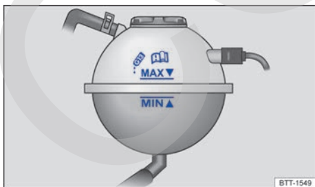
Fig. 183 En el vano motor: marcas en el depósito de expansión del líquido refrigerante del motor (representación esquemática).
