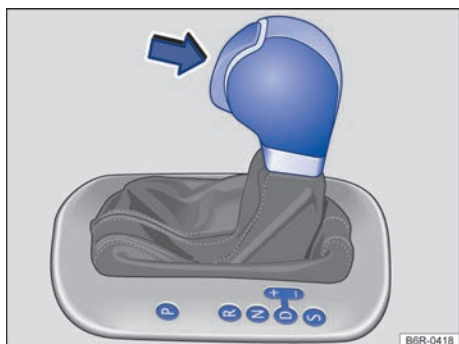
Fig. 101 Vehículo con el volante a la izquierda: palanca selectora del cambio automático con tecla de bloqueo (flecha). En los vehículos con el volante a la derecha, la disposición es simétrica.
