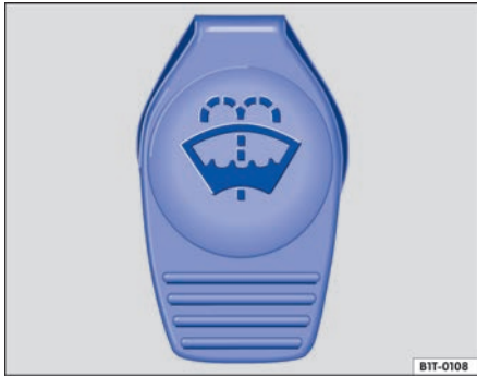
Fig. 180 En el vano motor: tapa del depósito del líquido lavacrystales.
