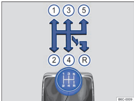
Fig. 100 Esquema de las marchas de un cambio manual de 5 marchas (variante 2).
