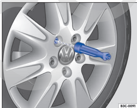
Fig. 203 Cambio de rueda: desensrosar los tornillos de rueda con el mango del destornillador.
