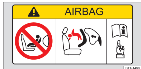
Fig. 36 Representación esquemática: etiqueta adhesiva relativa al airbag en el parasol.
