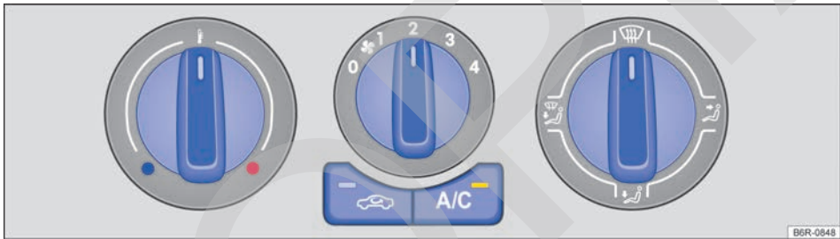
Fig. 91 En la parte superior de la consola central: panel de mandos del climatizador manual o del sistema de calefacción y ventilación.
