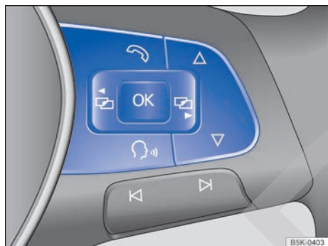
Fig. 51 Lado derecho del volante multifunción: teclas para utilizar los menús y las indicaciones informativas del cuadro de instrumentos.
