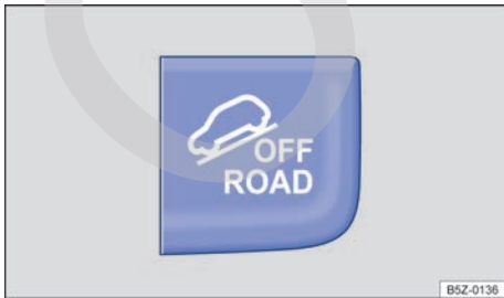
Fig. 107 En la consola central: tecla para activar y desactivar el modo off-road de forma manual.
