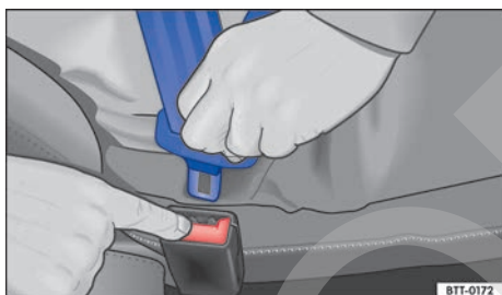
Fig. 10 Soltar la pestaña de encastre del cinturón de seguridad del cierre del cinturón.
