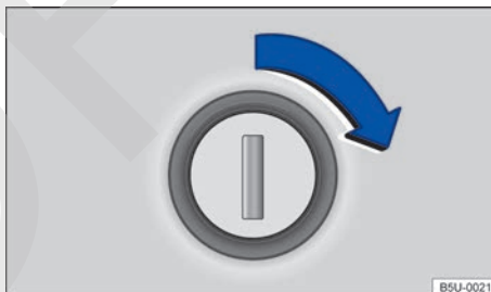
Fig. 60 Tapa trasera: abrir la tapa por el cilindro de la cerradura.
