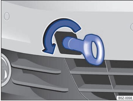
Fig. 159 En el parachoques delantero a la derecha: enrosque la argolla de remolque.
