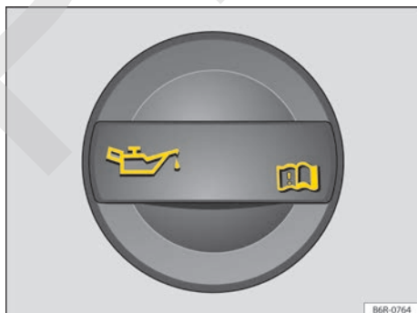
Fig. 168 En el compartimento del motor: tapón de la boca de llenado del aceite del motor.
