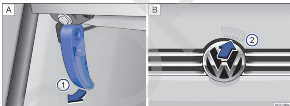
Fig. 164 A: palanca de desbloqueo en la zona reposapiés del lado del conductor ①. B: palanca de desbloqueo en la parte interior de la tapa del compartimento del motor ②.
