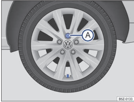
Fig. 186 Cambio de rueda: secuencia de desmontaje de los tornillos de la rueda.
