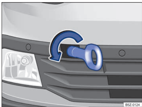
Fig. 161 En el parachoques delantero a la derecha: enrosque la argolla de remolque.
