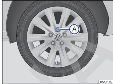
Fig. 182 Retire el tapacubos integral.
