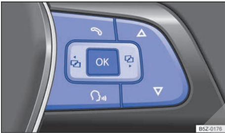
Fig. 45 Lado derecho del volante multifunción: teclas de mando de los menús del panel de instrumentos.
