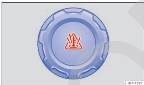
Fig. 168 En el vano motor: tapa del depósito de expansión del líquido refrigerante del motor (representación esquemática).
