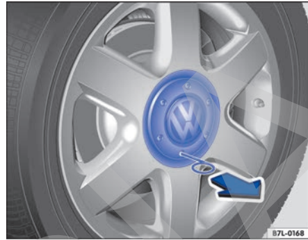
Fig. 179 Desmontar el tapacubos central tirando de él.
