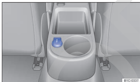
Fig. 129 Toma de corriente de 12 voltios en la parte trasera de la consola central.
