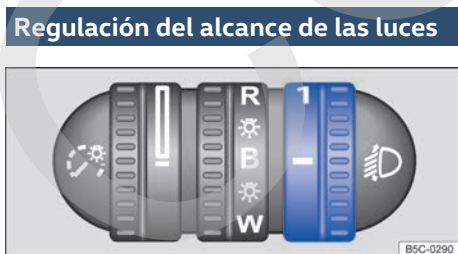
Fig. 76 Junto al volante: regulador del alcance de las luces.
