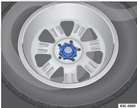
Fig. 177 En el maletero: ruedecilla para fijar la rueda de repuesto.
