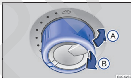
Fig. 61 En el revestimiento interior del techo: mando para abrir y cerrar el techo de cristal, así como para ajustar la posición deflectora del mismo.
