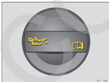
Fig. 166 En el vano motor: tapa de la boca de llenado de aceite.
