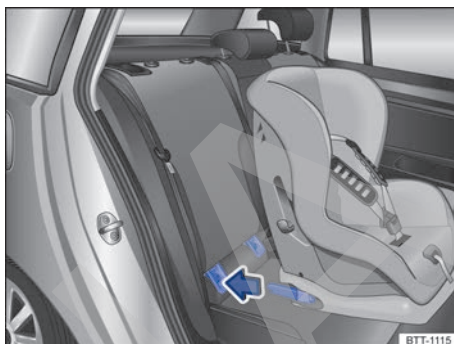
Fig. 44 Representación esquemática: montaje de un asiento para niños ISOFIX con conectores.
