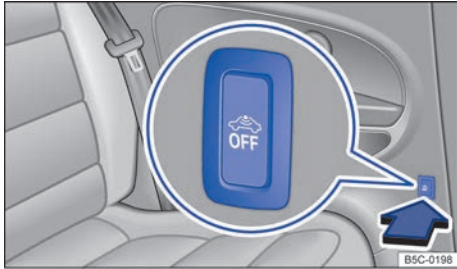
Fig. 56 Junto al asiento del conductor: tecla para desconectar la vigilancia del habitáculo y el sistema antirremolcado.
