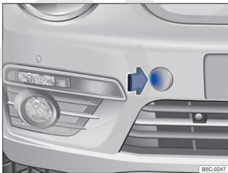
Fig. 158 En el lado derecho del paragolpes delantero: retirar la tapa.
