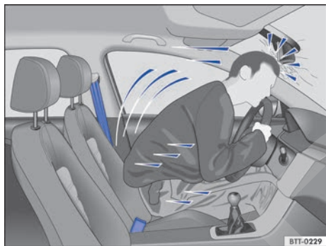
Fig. 25 El conductor sin el cinturón de seguridad colocado sale lanzado hacia adelante.
