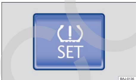
Fig. 172 En la guantera: tecla del sistema de control de los neumáticos.
