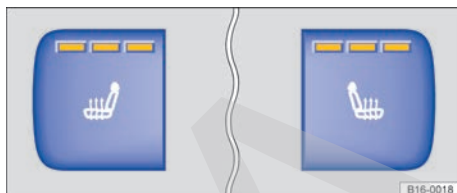
Fig. 89 En la consola central: teclas de la calefacción de los asientos delanteros (variante 1).
