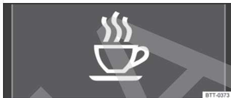
Fig. 16 En la pantalla del cuadro de instrumentos: símbolo de detección del cansancio.
