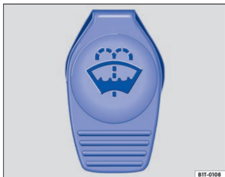
Fig. 164 En el vano motor: tapa del depósito del líquido lavacrystales.
