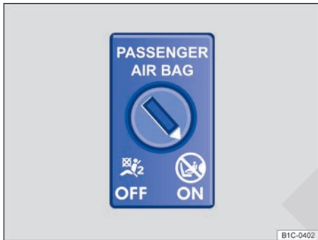
Fig. 35 En el lateral del tablero de instrumentos del lado del acompañante: conmutador de llave para activar y desactivar el airbag frontal del acompañante.
