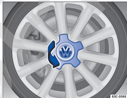
Fig. 180 Desmontar el tapacubos central girándolo.
