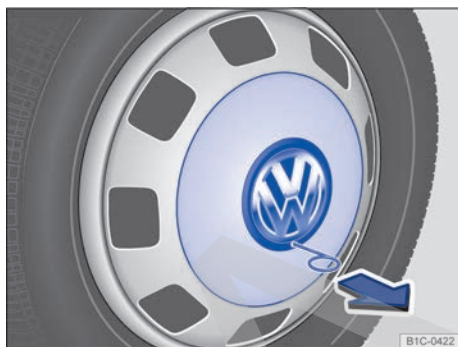
Fig. 182 Desmontar el tapacubos integral (variante 2)
