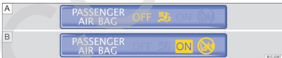
Fig. 32 En la parte superior de la consola central: testigo de control de la desactivación A o de la activación B del airbag frontal del acompañante.
