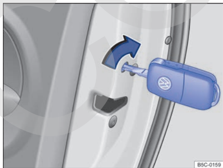
Fig. 55 En el frontal de la puerta del acompañante: bloqueo de emergencia de la puerta del acompañante con la llave del vehículo.
