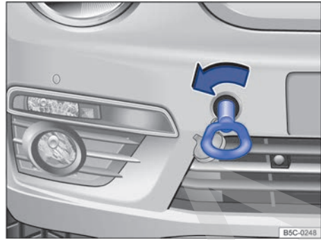
Fig. 159 En el lado derecho del paragolpes delantero: enroscar la argolla de remolque.
