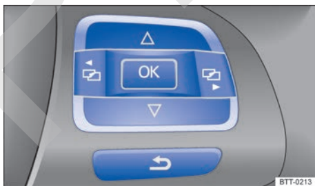
Fig. 19 Lado derecho del volante multifunción: teclas para utilizar los menús y las indicaciones informativas del cuadro de instrumentos.
