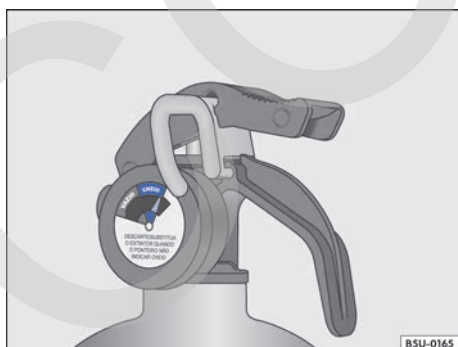
Fig. 25 En el extintor de incendio: indicador de carga (manómetro).
