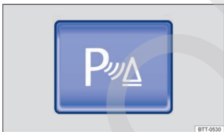
Fig. 104 En la parte superior de la consola central: pulsador para activar y desactivar el control de distancia de aparcamiento (Park Pilot).
