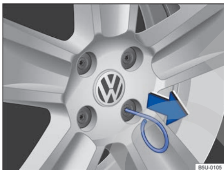
Fig. 183 Retirar las caperuzas de los tornillos de rueda.
