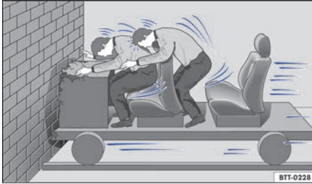
Fig. 5 Un vehículo con los ocupantes del vehículo sin cinturones de seguridad choca contra el muro.
