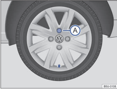
Fig. 188 Cambio de rueda: secuencia de desmontaje de los tornillos de la rueda.
