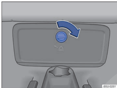
Fig. 141 En el piso del asiento trasero: acceso a la caja de fijación de las herramientas de a bordo.
