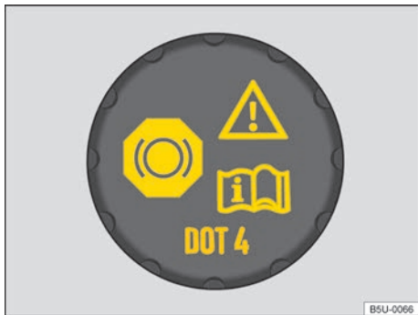
Fig. 173 En el compartimento del motor: tapón de cierre del depósito del líquido de frenos.
