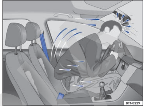
Fig. 6 El conductor sin cinturón de seguridad es lanzado hacia adelante.
