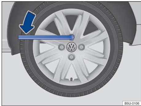
Fig. 185 Cambio de rueda: aflojar los tornillos de la rueda.
