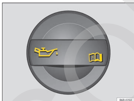
Fig. 170 En el compartimento del motor: tapón de la boca de llenado del aceite del motor.
