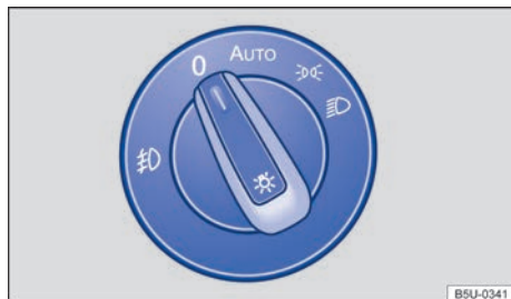
Fig. 74 En el panel: conmutador de las luces.
