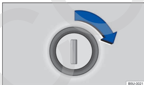
Fig. 58 Bombín de cierre para bloquear y desbloquear la tapa del compartimento de carga.
