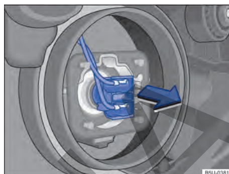
Fig. 112 Acceso a la bombilla del farol bajo.
