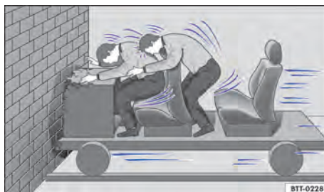
Fig. 23 Un vehículo con los ocupantes del vehículo sin cinturones de seguridad choca contra el muro.
