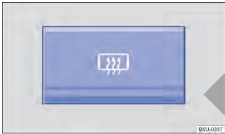
Fig. 84 En la consola central: botón del desempañador de la luneta.
