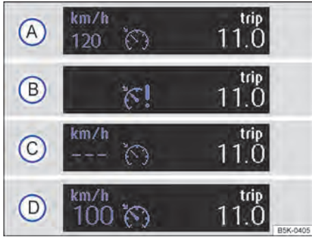
Fig. 95 En el display del panel de instrumentos: indicadores del estado del GRA.
