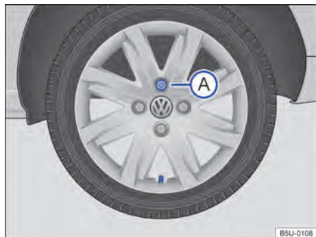
Fig. 185 Cambio de rueda: secuencia de desmontaje de los tornillos de la rueda.
