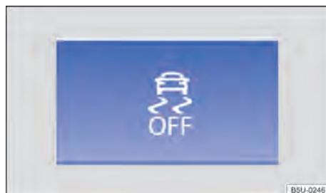
Fig. 104 En la consola central: tecla para desactivar y activar el ASR de forma manual.
