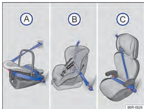
Fig. 37 Las ilustraciones (A), (B) y (C) muestran la fijación del sistema de retención infantil sólo con el cinturón de seguridad del vehículo.
