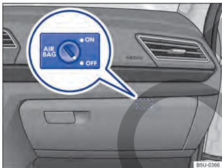
Fig. 36 En la guantera: interruptor desaccionado por la llave para apagar y encender el airbag frontal del pasajero.
