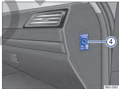
Fig. 10 Con la puerta del acompañante abierta (vehículos con el volante a la izquierda): conmutador de llave en el tablero de instrumentos (disposición simétrica en los vehículos con el volante a la derecha).
