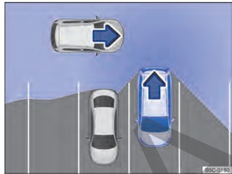
Fig. 132 Representación esquemática del asistente de salida del aparcamiento: zona vigilada alrededor del vehículo que está desapareando.
