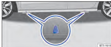
Fig. 194 Puntos de apoyo para el gato
