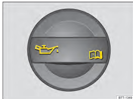
Fig. 174 En el vano motor: tapa de la boca de llenado de aceite del motor (representación esquemática).
