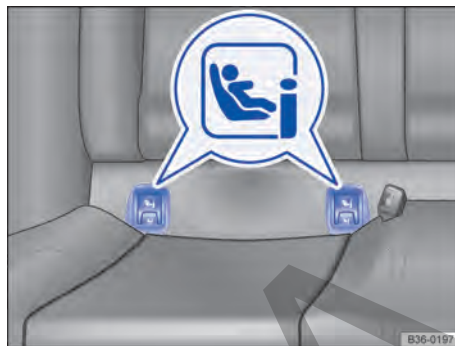
Fig. 47 Señalización de los puntos de anclaje i-Size para los asientos para niños.
