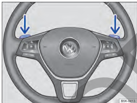
Fig. 109 Volante con levas de cambios para el Tiptronic.
