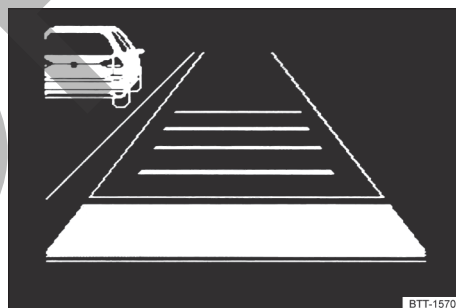
Fig. 118 En la pantalla del cuadro de instrumentos: vehículo detectado que circula más lentamente que el propio por el carril izquierdo (representación esquemática).
