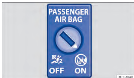
Fig. 38 En el tablero de instrumentos, en el lado del acompañante: conmutador de llave para desactivar y activar el airbag frontal del acompañante.
