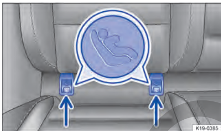
Fig. 45 Señalización de los puntos de anclaje ISOFIX para los asientos para niños.
