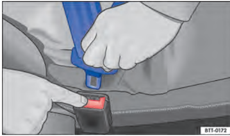
Fig. 30 Soltar la lengüeta del cierre del cinturón.
