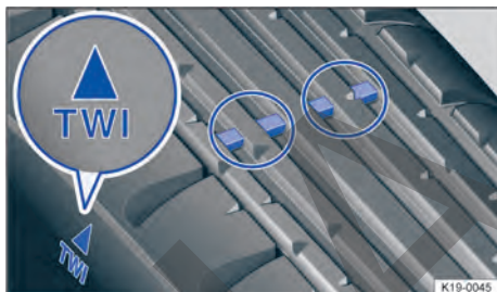
Fig. 183 Perfil del neumático: indicadores de desgaste.
