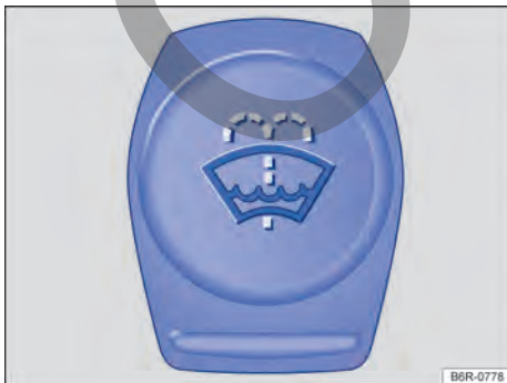
Fig. 172 En el vano motor: tapa del depósito del líquido lavacrystales.
