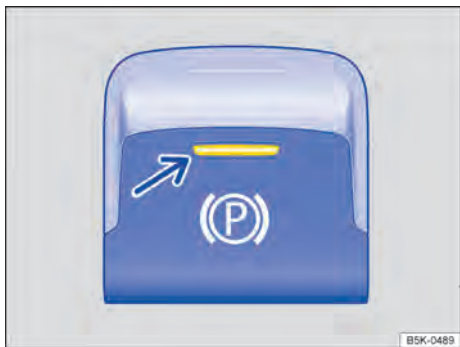
Fig. 127 En la consola central: tecla del freno de estacionamiento electrónico (representación esquemática).
