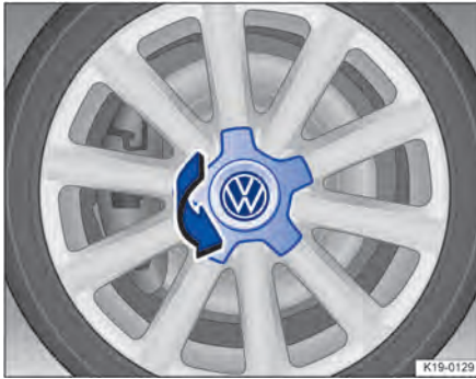
Fig. 186 Desmontar el tapacubos central girándolo.
