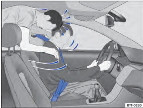
Fig. 27 El ocupante del asiento trasero sin el cinturón de seguridad colocado sale lanzado hacia delante topando contra el conductor, que sí lo lleva colocado.
