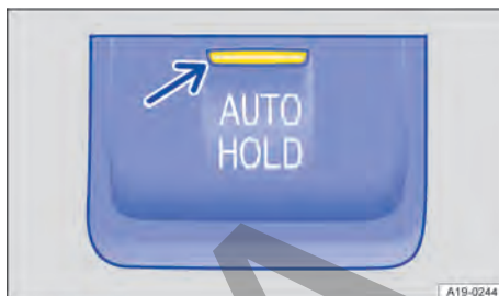
Fig. 128 En la consola central: tecla de la función Auto-Hold (representación esquemática).
