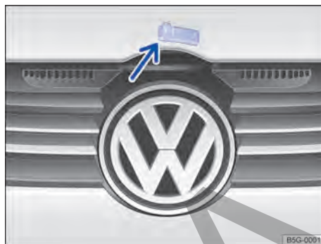
Fig. 168 Encima de la parrilla del radiador: palanca de accionamiento del capó delantero.
