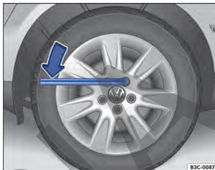
Fig. 189 Cambio de rueda: aflojar los tornillos de rueda.
