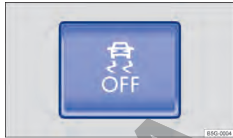
Fig. 134 En la consola central: tecla para conectar y desconectar manualmente el ASR o el ESC Sport (en función del equipamiento).
