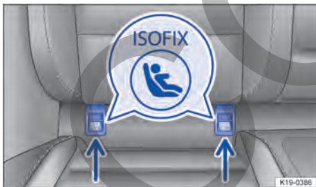
Fig. 46 Señalización de los puntos de anclaje ISOFIX para los asientos para niños.
