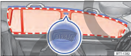
Fig. 41 En el lado izquierdo del vehículo: ubicación y zona de despliegue del airbag para la cabeza.
