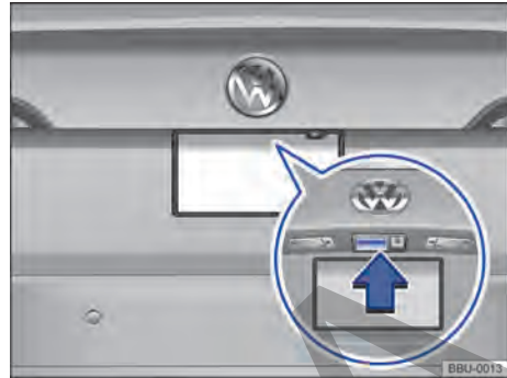
Fig. 66 En el portón del maletero: pulsador para abrir el portón.
