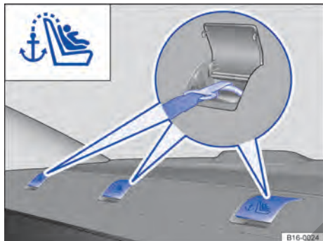
Fig. 49 En la bandeja trasera detrás del asiento trasero: argollas de sujeción para el cinturón de fijación superior.
