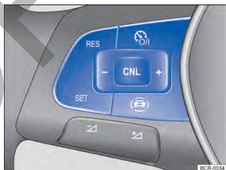
Fig. 117 Lado izquierdo del volante multifunción: teclas para manejar el limitador de velocidad.
