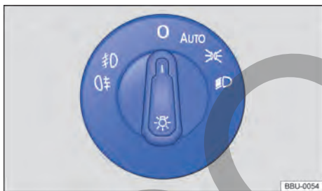
Fig. 85 Junto al volante: mando de las luces (una variante).
