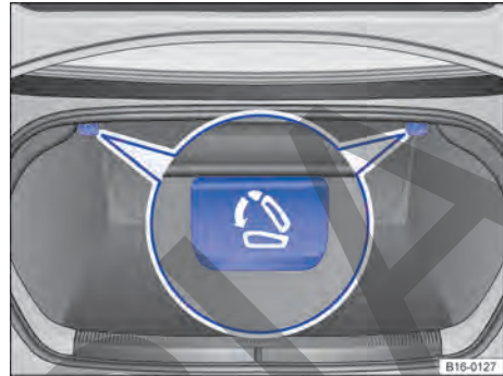
Fig. 75 En el maletero: palanca de desbloqueo desde el maletero.
