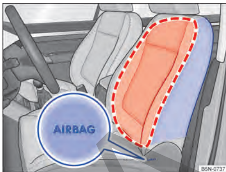
Fig. 40 Lateral de un asiento delantero: ubicación y zona de despliegue del airbag lateral.
