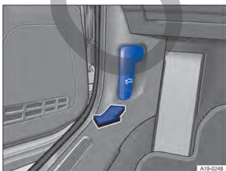
Fig. 167 En la zona reposapiés del lado del conductor: palanca de desbloqueo del capó delantero (representación esquemática).
