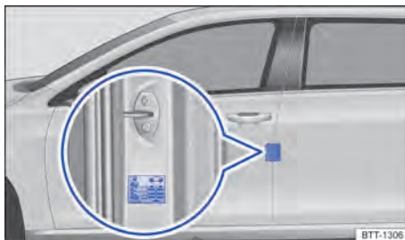
Fig. 182 En el pilar de la puerta del conductor: adhesivo de la presión de los neumáticos (o en la cara interior de la tapa del depósito de combustible).
