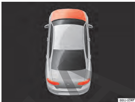
Fig. 171 En la pantalla del cuadro de instrumentos: capó delantero abierto o no cerrado correctamente (representación esquemática).
