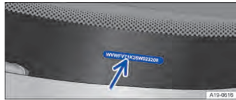
Fig. 207 En el parabrisas: número de identificación del vehículo.
