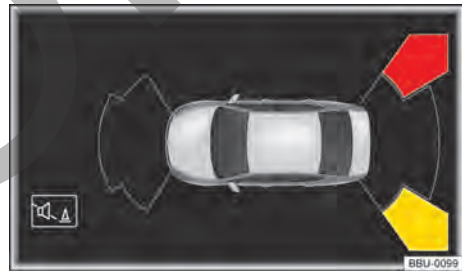
Fig. 133 En la pantalla del sistema de infotainment: visualización del asistente de salida del aparcamiento (en función del equipamiento).
