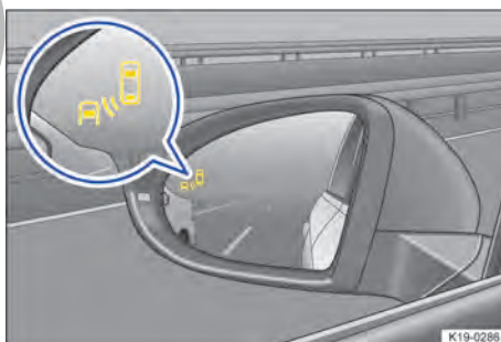
Fig. 126 En el retrovisor exterior: indicación del detector de ángulo muerto.
