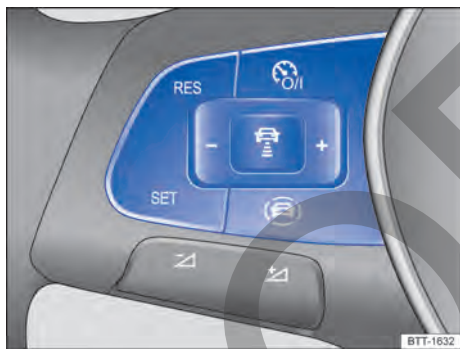
Fig. 123 Lado izquierdo del volante multifunción: teclas para manejar el ACC.
