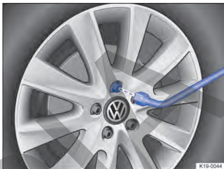
Fig. 200 Cambio de rueda: desenrosar los tornillos de rueda con la llave de rueda.
