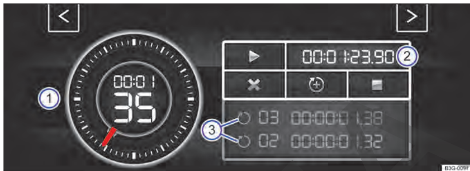
Fig. 20 En la pantalla del sistema de infotainment: cronómetro, botones de función y tiempos de las vueltas.
