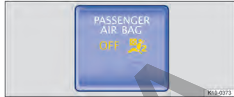
Fig. 34 En la consola central: testigo de control de la desactivación del airbag frontal del acompañante.
