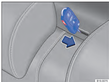
Fig. 67 Detrás del respaldo del asiento trasero: realizar un desbloqueo de emergencia del respaldo del asiento trasero.
