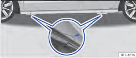
Fig. 197 Puntos de apoyo para el gato.
