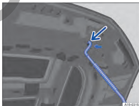
Fig. 170 En el capó delantero: alojamiento de la varilla de sujeción del capó.
