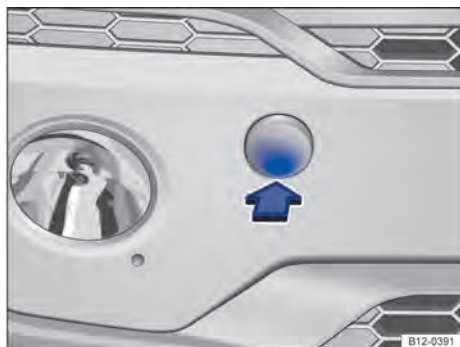
Fig. 150 En el parachoques delantero a la derecha: suelte y desmonte la cubierta.
