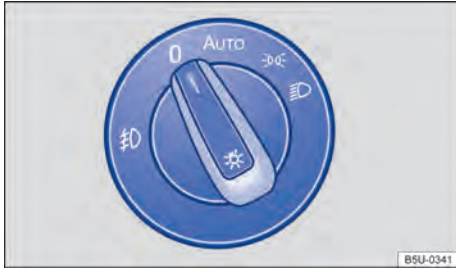
Fig. 62 En el panel: conmutador de las luces.
