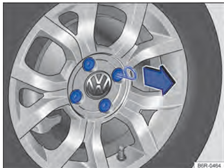
Fig. 170 Retirar las caperuzas de los tornillos de rueda.
