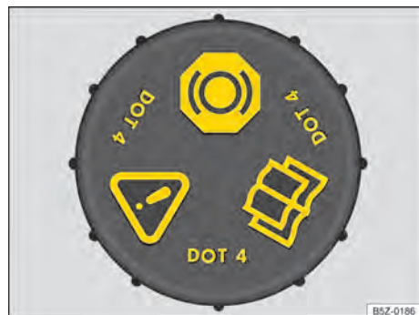
Fig. 160 En el compartimento del motor: tapón de cierre del depósito del líquido de frenos (variante 2). ▶
