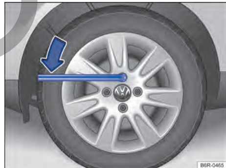
Fig. 171 Cambio de rueda: aflojar los tornillos de la rueda.
