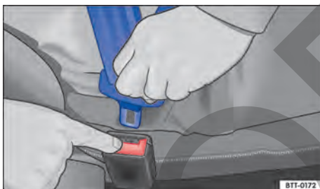
Fig. 28 Soltar la pestaña de encastre del cinturón de seguridad del cierre del cinturón.
