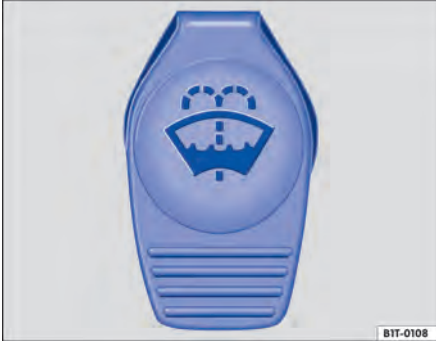
Fig. 154 En el compartimento del motor: tapón de cierre del depósito de agua de los lavavidrios.
