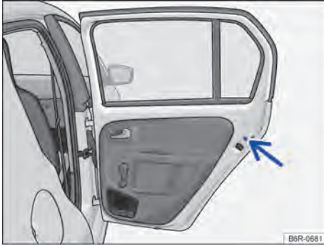
Fig. 38 En la puerta trasera (lado derecho): ubicación del seguro para niños.
