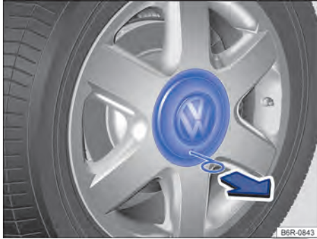
Fig. 168 Retirar el cubrerrueda de la rueda de aleación ligera.
