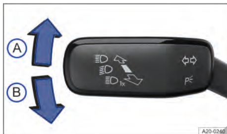
Fig. 84 En el lado izquierdo de la columna de dirección: palanca de los intermitentes y de la luz de carretera.
