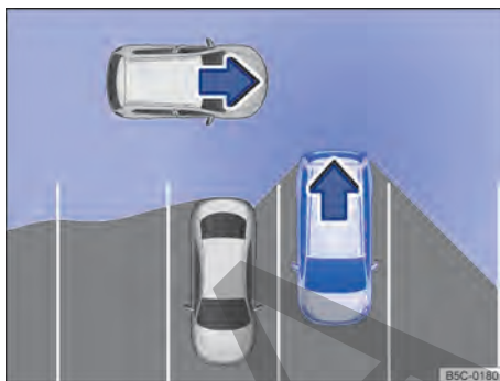
Fig. 131 Representación esquemática del asistente de salida del aparcamiento: zona vigilada alrededor del vehículo que está desaparcando.
