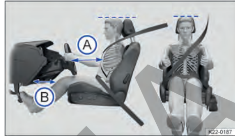
Fig. 24 Representación esquemática: distancia correcta entre el conductor y el volante, colocación correcta de la banda del cinturón y ajuste correcto del apoyacabezas.
