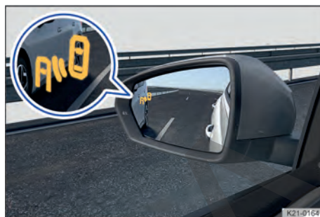
Fig. 125 En los retrovisores exteriores: indicación del detector de ángulo muerto.
