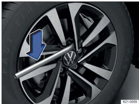
Fig. 186 Cambio de rueda: aflojar los tornillos de rueda.
