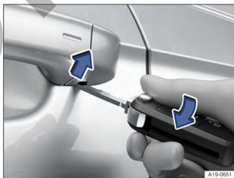
Fig. 57 Manilla de la puerta del conductor: desprender la caperuzca haciendo palanca.
