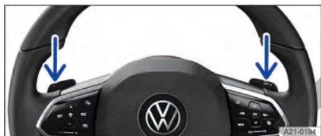
Fig. 106 Volante con levas de cambios para el Tiptronic.
