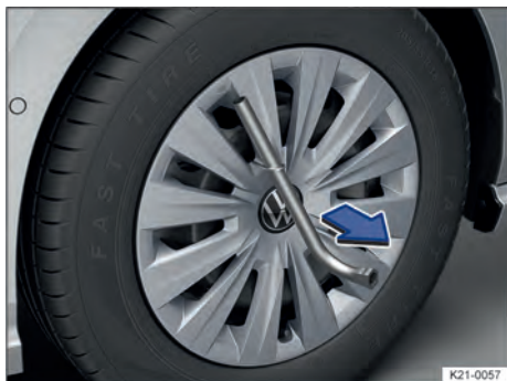
Fig. 184 Desmontar el tapacubos integral.
