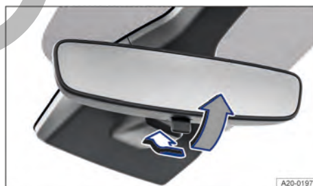
Fig. 89 En el parabrisas: retrovisor interior antideslumbrante manual.
