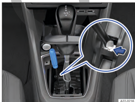
Fig. 107 Realizar un desbloqueo de emergencia de la palanca selectora (variante 1).
