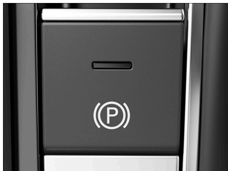
Fig. 126 En la consola central: tecla del freno de estacionamiento electrónico.
