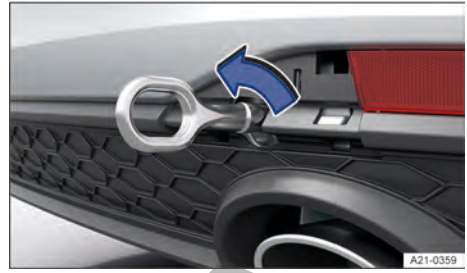
Fig. 164 En el lado derecho del paragolpes trasero: enroscar la argolla de remolque, variante 2.
