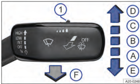
Fig. 86 En el lado derecho de la columna de dirección: manejo del limpiaparabrisas.
