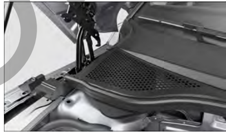
Fig. 199 Entre el vano motor y el parabrisas: caja de aguas (representación esquemática).
