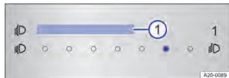
Fig. 85 En el sistema de infotainment: regulador táctil para la regulación del alcance de las luces.
