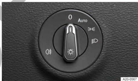
Fig. 82 Junto al volante: mando de las luces (una variante).
