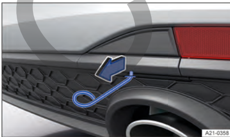
Fig. 163 En el lado derecho del paragolpes trasero: retirar la tapa, variante 2.
