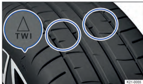
Fig. 182 Perfil del neumático: indicadores de desgaste.
