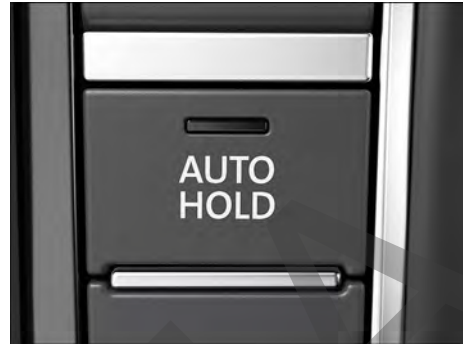
Fig. 127 En la consola central: tecla de la función Auto Hold.
