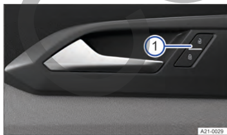
Fig. 56 En la puerta del conductor: tecla del cierre centralizado (representación esquemática).
