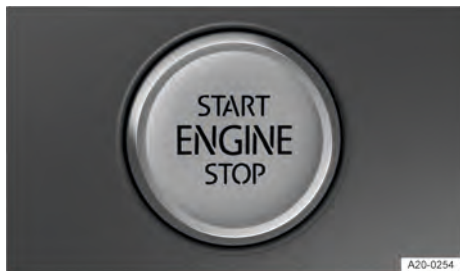
Fig. 100 En la parte inferior de la consola central: pulsador de encendido y arranque para poner el motor en marcha.
