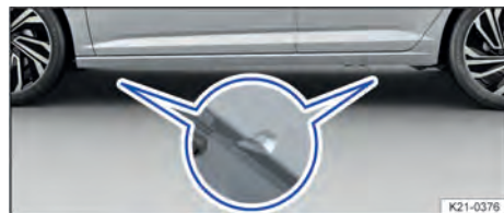
Fig. 190 Puntos de apoyo para el gato (variante 1).
