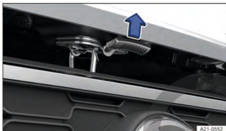
Fig. 166 Encima de la parrilla del radiador: palanca de accionamiento del capó delantero (representación esquemática).
