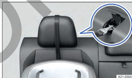
Fig. 44 En el respaldo del asiento trasero: colocación de la banda del cinturón de fijación superior (Top Tether) simple si los apoyacabezas no se pueden ajustar.
