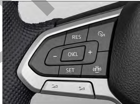
Fig. 111 Lado izquierdo del volante multifunción (variante 1).
