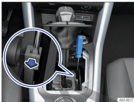
Fig. 108 Realizar un desbloqueo de emergencia de la palanca selectora (variante 2).
