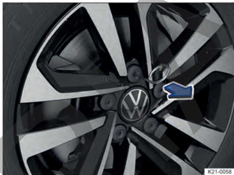
Fig. 185 Retirar las caperuzas de los tornillos de rueda.
