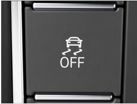
Fig. 133 En la consola central: tecla para conectar y desconectar manualmente el ASR o el ESC Sport (en función del equipamiento).
