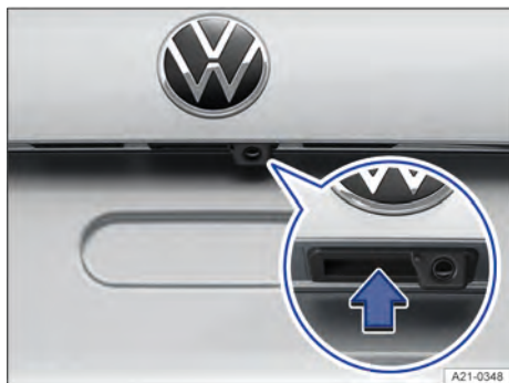
Fig. 62 En el portón trasero: pulsador para abrir el portón.
