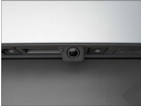
Fig. 200 En la parte trasera del vehículo: cámara de marcha atrás en la manilla con pulsador (representación esquemática).
