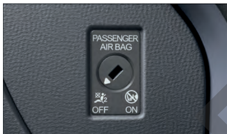
Fig. 33 En el tablero de instrumentos, en el lado del acompañante: conmutador de llave para desactivar y activar el airbag frontal del acompañante.
