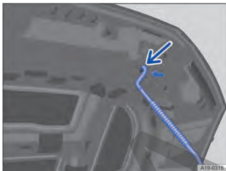
Fig. 168 En el capó delantero: alojamiento de la varilla de sujeción del capó (representación esquemática).
