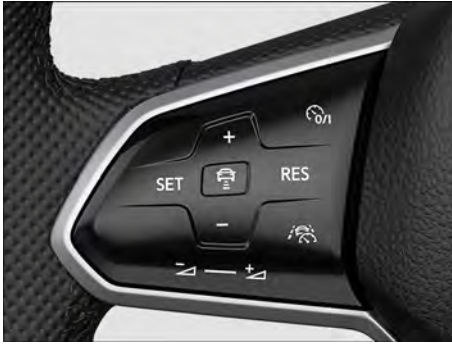
Fig. 112 Lado izquierdo del volante multifunción (variante 2).
