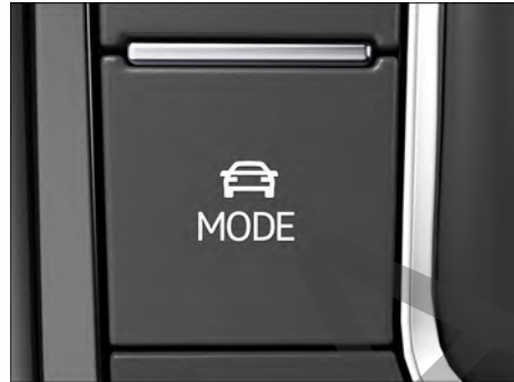
Fig. 109 En la consola central: tecla MODE para seleccionar los perfiles de conducción.
