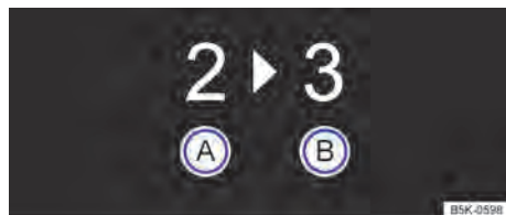
Fig. 96 En la pantalla del cuadro de instrumentos: recomendación de marcha.
