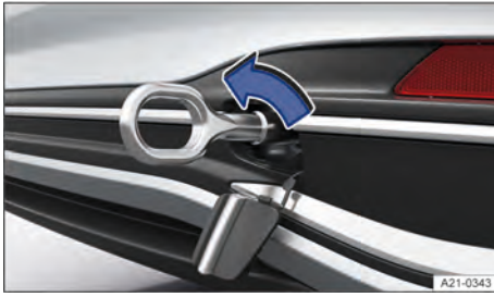
Fig. 162 En el lado derecho del paragolpes trasero: enroscar la argolla de remolque, variante 1.
