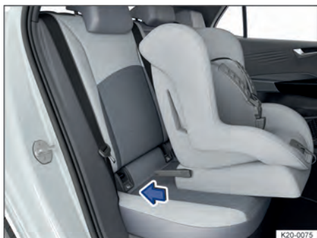
Fig. 42 Representación esquemática: montaje de un asiento para niños con conectores.
