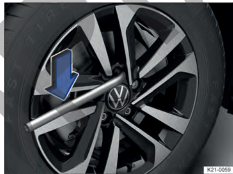
Fig. 196 Cambio de rueda: desenroscar los tornillos de rueda con la llave de rueda.
