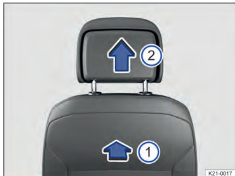
Fig. 74 Representación esquemática: desmontaje de los apoyacabezas delanteros.
