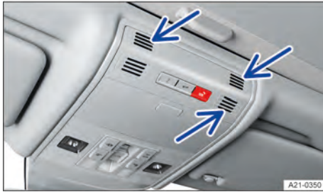
Fig. 60 En la consola del techo: sensores de la vigilancia del habitáculo (flechas).
