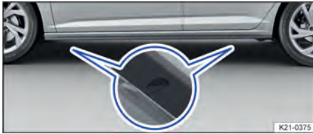
Fig. 191 Puntos de apoyo para el gato (variante 2).
