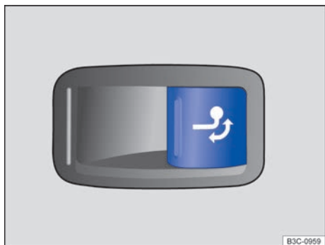
Fig. 262 En el lado derecho del maletero: tecla para desbloquear el enganche de bola.
