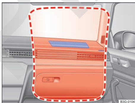
Fig. 16 Ubicación y zona de despliegue del airbag frontal del acompañante.
