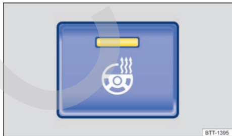
Fig. 137 En la parte inferior de la consola central: tecla para la calefacción del volante.
