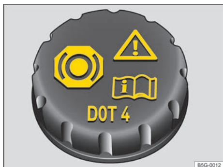
Fig. 303 En el vano motor: tapa del depósito del líquido de frenos.
