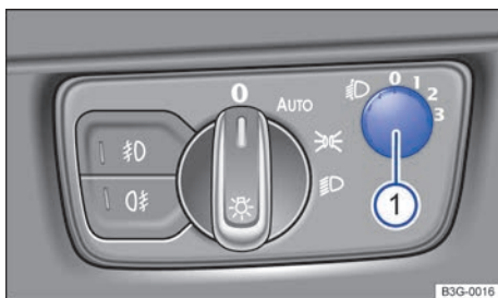
Fig. 119 Junto al volante: regulador del alcance de las luces .
