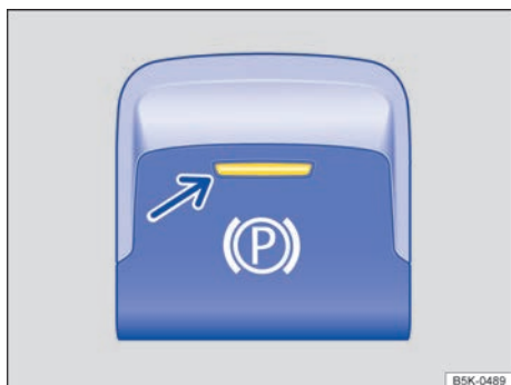
Fig. 184 En la parte inferior de la consola central: tecla del freno de estacionamiento electrónico.
