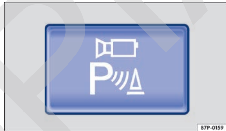
Fig. 187 En la parte superior de la consola central: tecla para conectar y desconectar el ParkPilot (en función del equipamiento).
