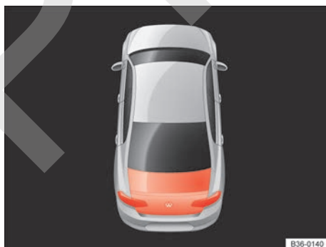
Fig. 89 En la pantalla del cuadro de instrumentos: portón del maletero abierto o no cerrado correctamente (berlina).
