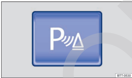
Fig. 186 En la parte superior de la consola central: tecla para conectar y desconectar el ParkPilot (en función del equipamiento).
