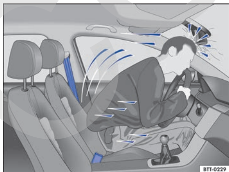
Fig. 6 El conductor sin el cinturón de seguridad colocado sale lanzado hacia delante.
