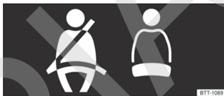
Fig. 3 En la pantalla del cuadro de instrumentos: indicación del estado de los cinturones de seguridad de las plazas traseras.
