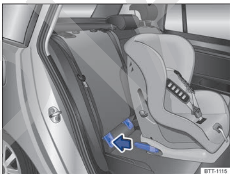
Fig. 28 Representación esquemática: montaje de un asiento para niños ISOFIX con conectores.
