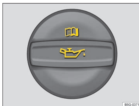
Fig. 300 En el vano motor: tapa de la boca de llenado de aceite del motor (representación esquemática).
