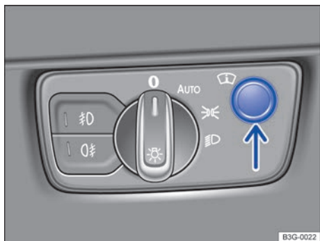
Fig. 57 Junto al volante: regulador del Head-up-Display (flecha).
