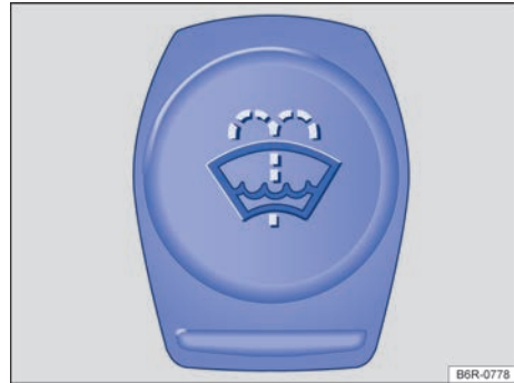
Fig. 298 En el vano motor: tapa del depósito del lavacrystalales.
