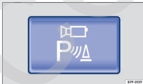
Fig. 205 En la parte superior de la consola central: tecla para conectar manualmente el sistema de visión periférica. ▶
