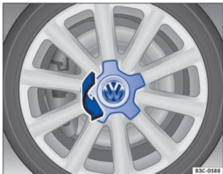
Fig. 315 Desmontar el tapacubos central girándolo.
