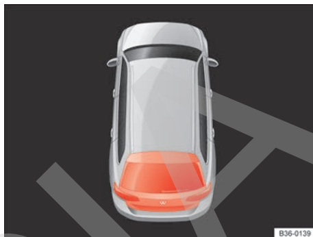
Fig. 88 En la pantalla del cuadro de instrumentos: portón del maletero abierto o no cerrado correctamente (Variant).
