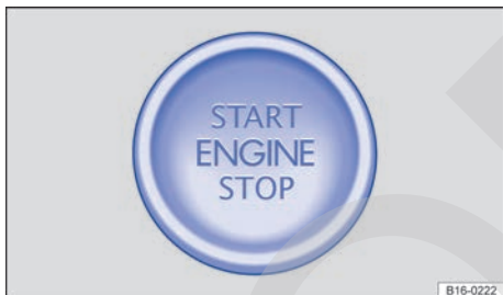
Fig. 145 En la parte inferior de la consola central: pulsador de encendido y arranque para poner el motor en marcha.
