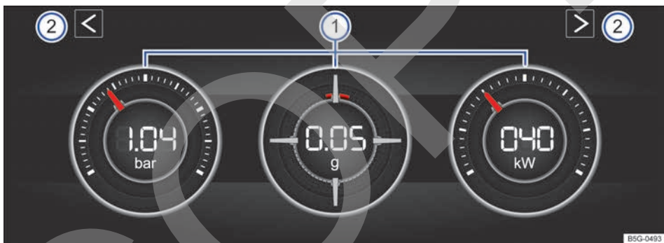
Fig. 69 En la pantalla del sistema de infotainment: monitor de potencia.
