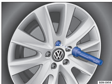
Fig. 324 Cambio de rueda: desenroscar los tornillos de rueda con el mango del destornillador.
