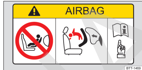
Fig. 25 Representación esquemática: etiqueta adhesiva relativa al airbag en el parasol.
