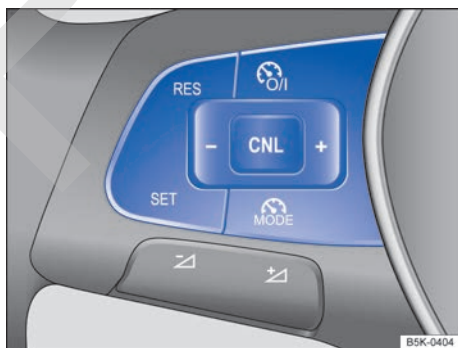
Fig. 165 Lado izquierdo del volante multifunción: teclas para manejar el limitador de velocidad.
