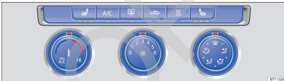
Fig. 132 En la parte superior de la consola central: mandos del climatizador manual y del sistema de calefacción y ventilación.
