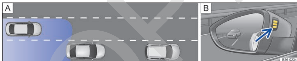
Fig. 180 [A] Situación en un adelantamiento con tráfico en la parte trasera. [B] Indicador óptico en el retrovisor exterior izquierdo.
