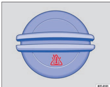
Fig. 302 En el vano motor: tapa del depósito de expansión del líquido refrigerante del motor.
