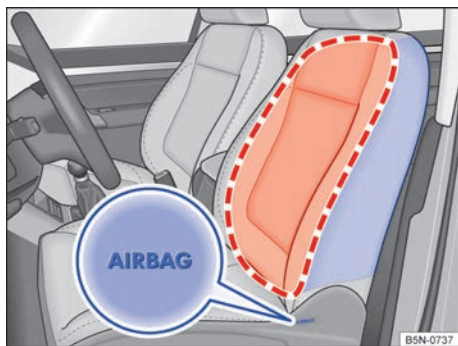
Fig. 19 Lateral de un asiento delantero: ubicación y zona de despliegue del airbag lateral.
