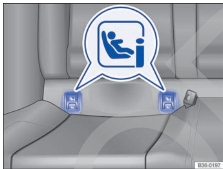
Fig. 27 En el asiento del vehículo: señalización de los puntos de anclaje ISOFIX para los asientos para niños.
