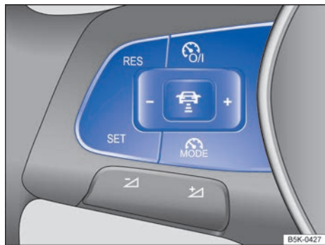
Fig. 168 Lado izquierdo del volante multifunción: teclas para manejar el ACC.
