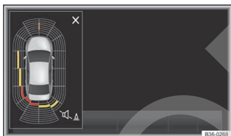
Fig. 189 Visualización del ParkPilot en la pantalla: visualización reducida.
