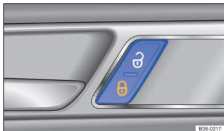
Fig. 77 En la puerta del conductor: tecla del cierre centralizado.
