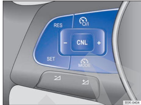
Fig. 162 Lado izquierdo del volante multifunción: teclas para manejar el GRA.
