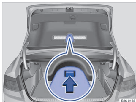
Fig. 36 En el portón del maletero: soporte del triángulo de preseñalización (berlina).
