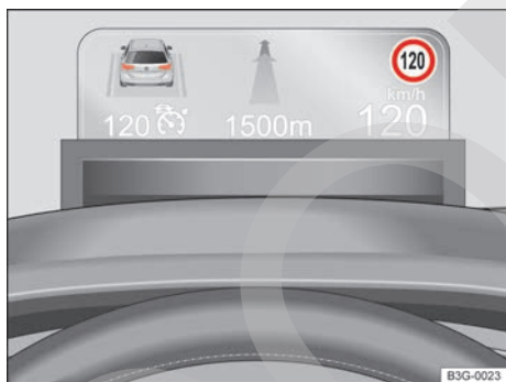
Fig. 58 En el tablero de instrumentos, encima del volante: ejemplos de indicaciones en el Head-up-Display.
