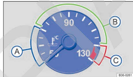
Fig. 63 Indicador de la temperatura del líquido refrigerante del motor: (A) zona fría; (B) zona normal; (C) zona de advertencia.
