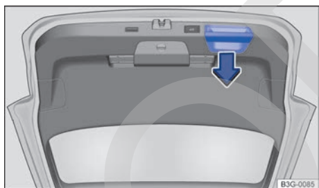
Fig. 93 Portón del maletero abierto: asidero para tirar hacia abajo (Variant).
