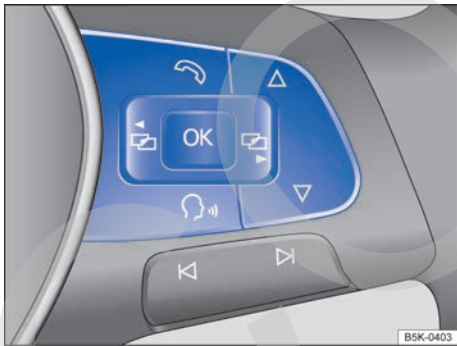
Fig. 67 Lado derecho del volante multifunción: teclas para utilizar los menús y las indicaciones informativas del cuadro de instrumentos.
