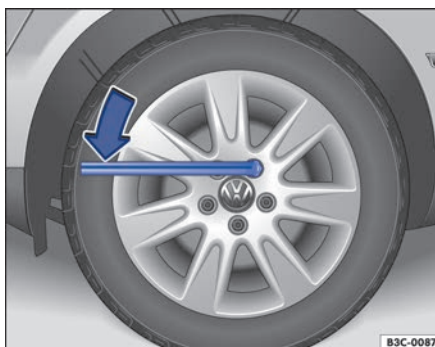
Fig. 318 Cambio de rueda: aflojar los tornillos de rueda.
