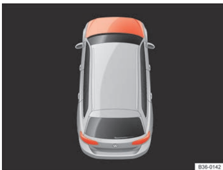
Fig. 297 En la pantalla del cuadro de instrumentos: capó del motor abierto o no cerrado correctamente.
