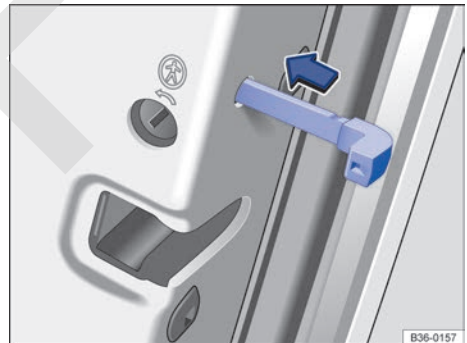
Fig. 87 En el frontal de la puerta trasera derecha: bloqueo de emergencia del vehículo con la llave de emergencia.
