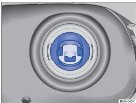
Fig. 267 Representación esquemática: protección en la boca de llenado del depósito de combustible para no repostar equivocadamente.
