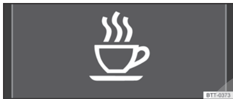
Fig. 60 En la pantalla del cuadro de instrumentos: símbolo de detección del cansancio.
