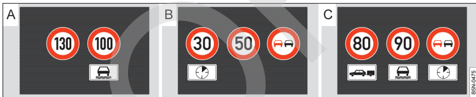
Fig. 61 En la pantalla del cuadro de instrumentos: ejemplos de limitaciones de velocidad o prohibiciones de adelantamiento reconocidas con sus respectivos paneles complementarios.
