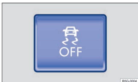
Fig. 209 En la consola central: tecla para desconectar y conectar manualmente el ASR, el ASR junto con el ESC, o el ESC Sport.
