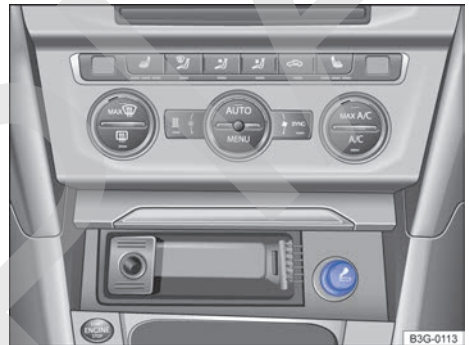
Fig. 222 En la parte delantera de la consola central: encendedor en el cenicero (variante 1).
