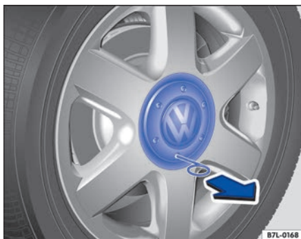
Fig. 314 Desmontar el tapacubos central tirando de él.
