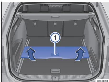
Fig. 238 En el maletero: desmontar el piso desplazable del maletero. ▶
