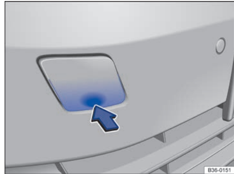
Fig. 293 En el lado derecho del paragolpes delantero: retirar la tapa.
