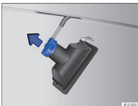
Fig. 151 Luz de la placa de licencia: retirar el portalámparas.
