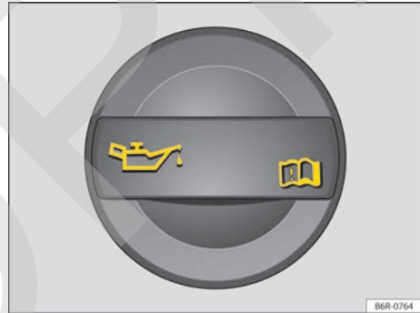
Fig. 105 En el compartimento del motor: tapa de la abertura para llenado de aceite de motor.
