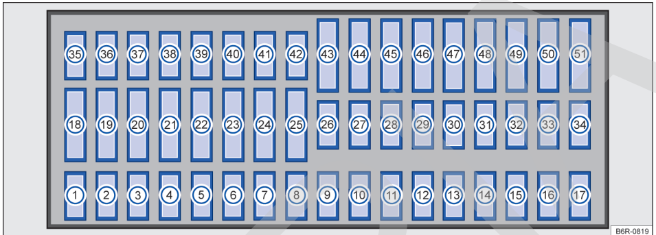
Fig. 143 Caja de fusibles.
