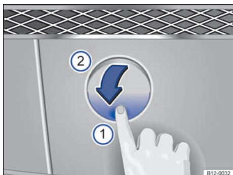
Fig. 153 En el parachoques delantero a la derecha: aflojar y desmontar la cubierta.
