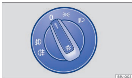
Fig. 54 En el panel: conmutador de las luces.
