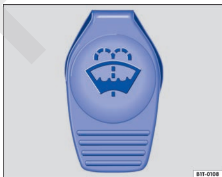
Fig. 58 En el compartimento del motor: tapón de cierre del depósito de agua de los lavavidrios.
