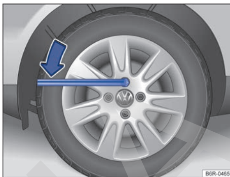
Fig. 137 Cambio de rueda: aflojar los tornillos de la rueda.
