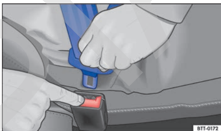
Fig. 42 Soltar la pestaña de encastre del cinturón de seguridad del cierre del cinturón.
