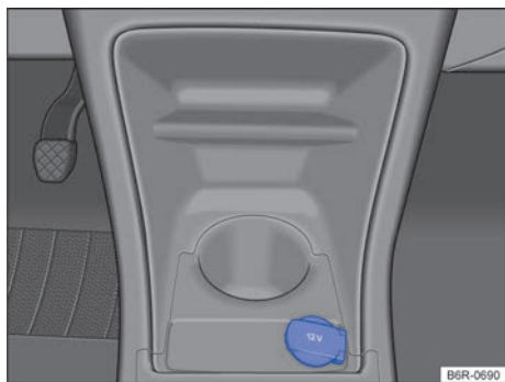
Fig. 80 En la consola central delantera: toma de corriente de 12 V.
