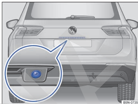
Fig. 177 En la parte trasera del vehículo: ubicación de la cámara del asistente de marcha atrás.
