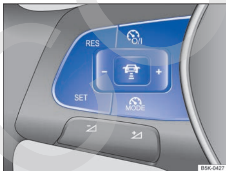
Fig. 152 Lado izquierdo del volante multifunción: teclas para manejar el ACC.
