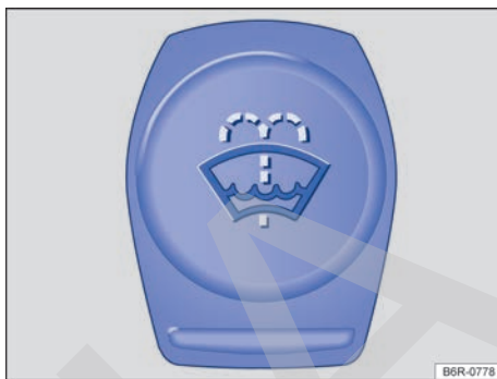
Fig. 242 En el vano motor: tapa del depósito del lavacristales.
