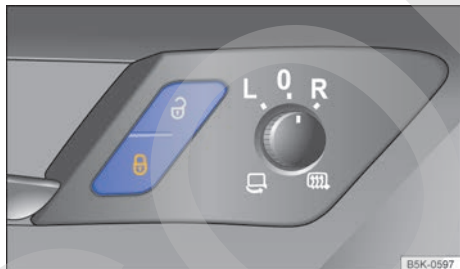
Fig. 62 En la puerta del conductor: tecla del cierre centralizado.
