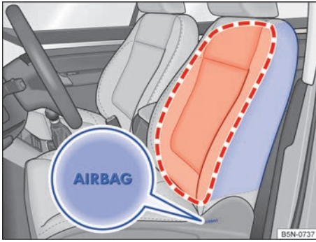
Fig. 46 Lateral de un asiento delantero: ubicación y zona de despliegue del airbag lateral.
