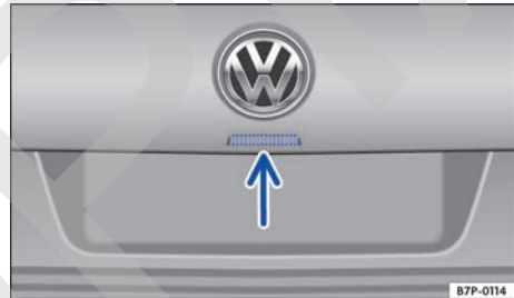
Fig. 75 En el portón del maletero: pulsador para abrir el portón.
