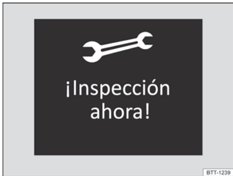
Fig. 19 En la pantalla del cuadro de instrumentos: ejemplo de visualización de un aviso de servicio (representación esquemática).
