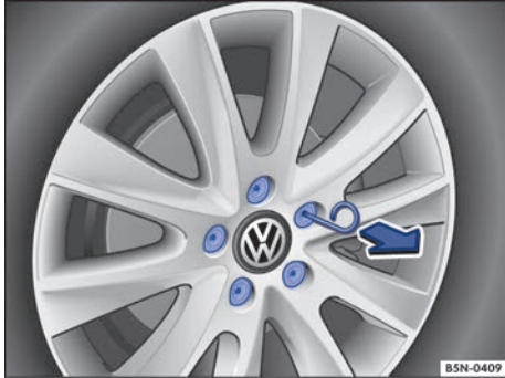
Fig. 259 Quitar las caperuzas de los tornillos de rueda.
