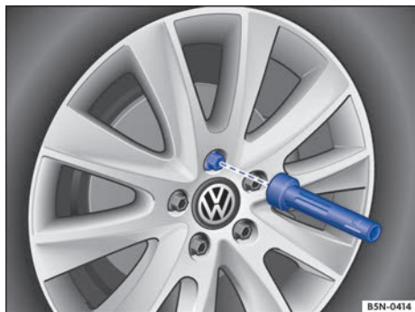
Fig. 264 Cambio de rueda: desenroscar los tornillos de rueda con el mango del destornillador.
