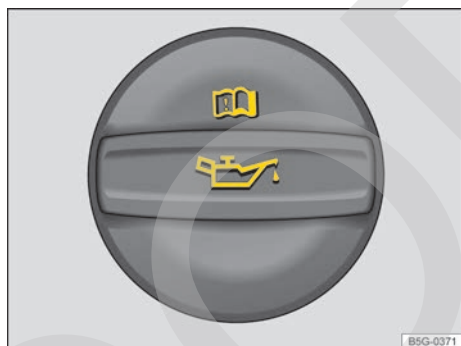
Fig. 244 En el vano motor: tapa de la boca de llenado de aceite del motor (representación esquemática).
