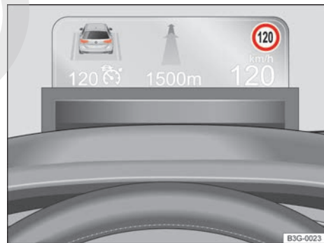
Fig. 14 En el tablero de instrumentos, encima del volante: Head-up-Display. ▶
