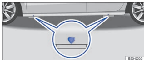
Fig. 262 Puntos de apoyo para el gato.
