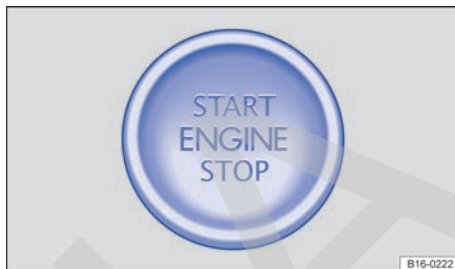
Fig. 128 En la parte inferior de la consola central: pulsador de encendido y arranque para poner el motor en marcha.
