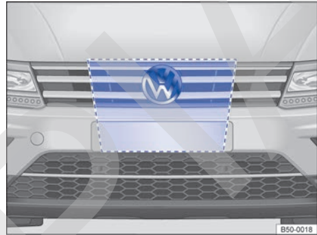
Fig. 151. En la parrilla del radiador, detrás del emblema de Volkswagen: sensor de radar y zona que hay que dejar libre alrededor del sensor de radar.
