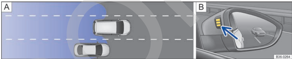
Fig. 162 [A] Situación en un adelantamiento e incorporación posterior al carril derecho. [B] Indicador óptico en el retrovisor exterior derecho.
