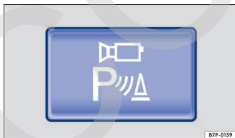
Fig. 184 En la parte superior de la consola central: tecla para conectar manualmente el sistema de visión periférica. ▶
