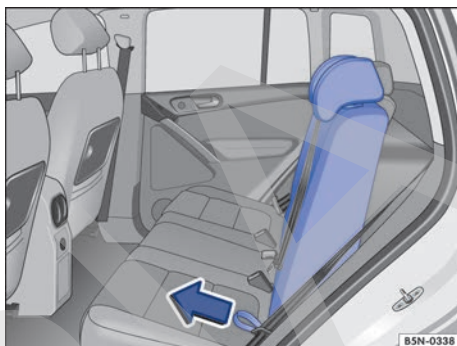
Fig. 91 Abatir y levantar el respaldo del asiento trasero.
