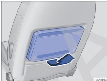
Fig. 102 En el asiento delantero: abrir la mesita plegable.
