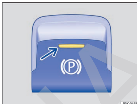
Fig. 165 En la parte inferior de la consola central: tecla del freno de estacionamiento electrónico.
