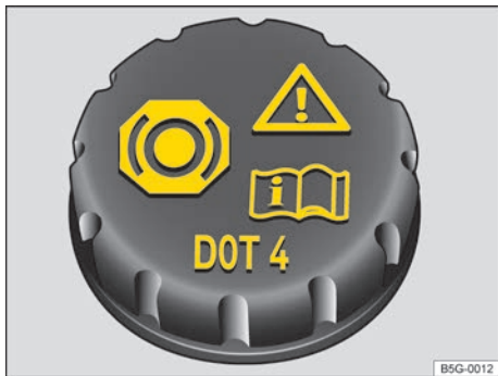
Fig. 247 En el vano motor: tapa del depósito del líquido de frenos.
