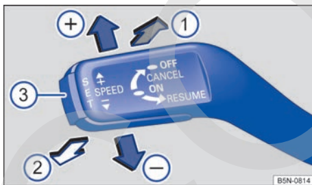
Fig. 144 En el lado izquierdo de la columna de dirección: palanca del GRA.
