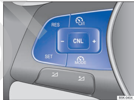
Fig. 145 Lado izquierdo del volante multifunción: teclas para manejar el GRA.
