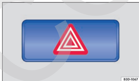
Fig. 57 En la parte superior de la consola central: pulsador para conectar y desconectar los intermitentes de emergencia.
