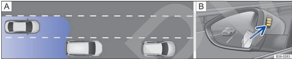
Fig. 161 [A] Situación en un adelantamiento con tráfico en la parte trasera. [B] Indicador óptico en el retrovisor exterior izquierdo.
