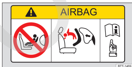
Fig. 52 Representación esquemática: etiqueta adhesiva relativa al airbag en el parasol.
