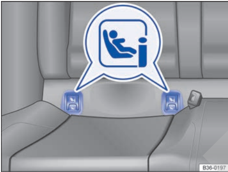
Fig. 54 En el asiento del vehículo: señalización de los puntos de anclaje ISOFIX para los asientos para niños.
