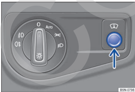
Fig. 13 Junto al volante: regulador del Head-up-Display (flecha).
