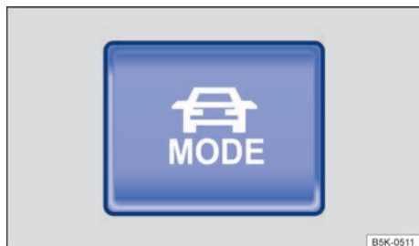
Fig. 137 En la parte inferior de la consola central: tecla de selección del perfil de conducción.
