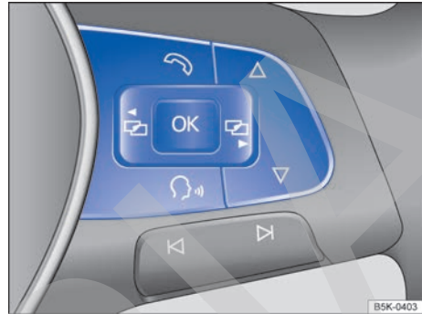
Fig. 22 Lado derecho del volante multifunción: teclas para utilizar los menús y las indicaciones informativas de la pantalla del cuadro de instrumentos.
