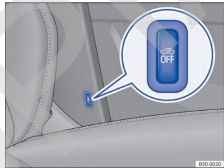
Fig. 65 Junto al asiento del conductor: tecla para desconectar la vigilancia del habitáculo y el sistema antirremolcado.
