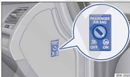
Fig. 44 En el tablero de instrumentos del lado del acompañante: conmutador de llave para activar y desactivar el airbag frontal del acompañante.
