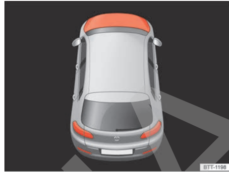
Fig. 241 En la pantalla del cuadro de instrumentos: capó del motor abierto o no cerrado correctamente (representación esquemática).
