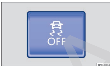
Fig. 187 En la consola central: tecla para desconectar y conectar manualmente el ASR, el ASR junto con el ESC, o el ESC Sport.
