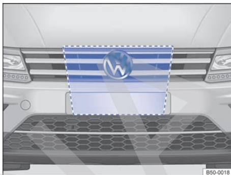
Fig. 157 En la parrilla del radiador, detrás del emblema de Volkswagen: sensor de radar y zona que hay que dejar libre alrededor del sensor de radar.
