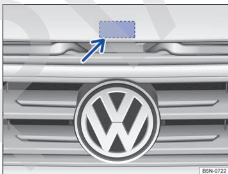
Fig. 240 Encima de la parrilla del radiador: palanca de apertura del capó del motor.
