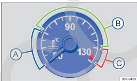
Fig. 18 En el cuadro de instrumentos: indicador de temperatura del líquido refrigerante del motor (representación esquemática).
