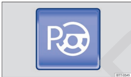
Fig. 178 En la parte inferior de la consola central: tecla para conectar el sistema de aparcamiento asistido.
