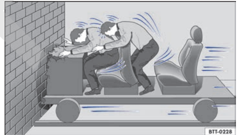
Fig. 18 El vehículo choca contra el muro. Los ocupantes no llevan colocado el cinturón de seguridad.
