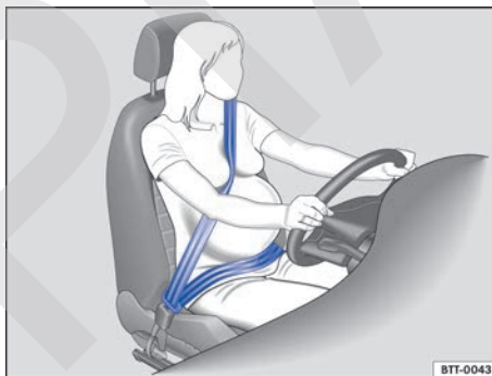
Fig. 25 Colocación correcta de la banda del cinturón en el caso de mujeres embarazadas.
