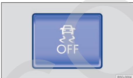
Fig. 112 En la consola central: tecla para desconectar y conectar manualmente el ASR.
