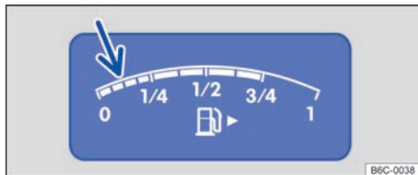
Fig. 48 En el cuadro de instrumentos: indicador del nivel de gasolina o gasóleo.
