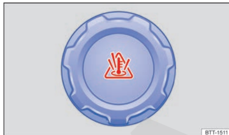
Fig. 184 En el vano motor: tapa del depósito de expansión del líquido refrigerante del motor (representación esquemática).
