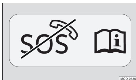
Fig. 126 Adhesivo pegado posteriormente en el vehículo que indica la desactivación permanente de los servicios Car-Net.
