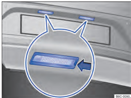
Fig. 131 En el parachoques trasero: luz de la placa de licencia.
