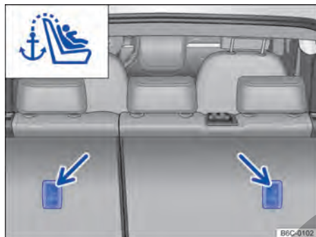
Fig. 44 Ojales de retención para el cinturón de fijación superior en el lado de atrás del asiento trasero.
