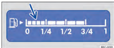
Fig. 12 En el display del instrumento combinado analógico: indicador del nivel de combustible (variante 1).
