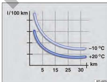
Fig. 86 Consumo de combustible en l/100 km en 2 temperaturas ambiente distintas.
