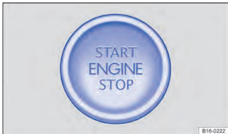
Fig. 89 En la parte inferior de la consola central: tecla de arranque para poner en marcha el motor
