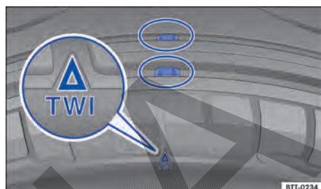
Fig. 155 Perfil del neumático: indicadores de desgaste.
