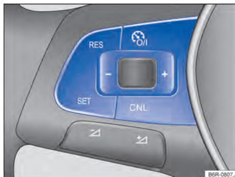
Fig. 97 Lado izquierdo del volante multifunción: teclas para comandar el GRA.
