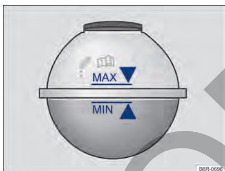
Fig. 124 En el compartimento del motor: marca en el depósito de expansión del líquido refrigerante del motor.
