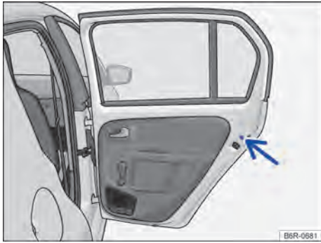
Fig. 37 En la puerta trasera (lado derecho): ubicación del seguro para niños.
