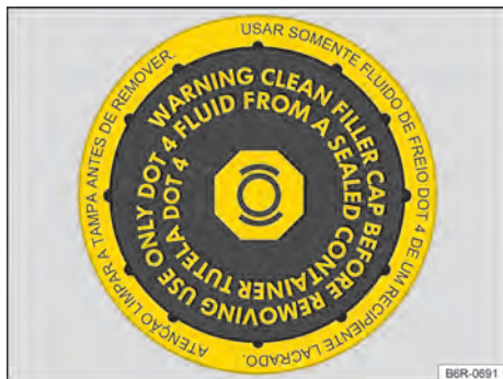
Fig. 126 En el compartimento del motor: tapón de cierre del depósito del líquido de frenos (variante 1).
