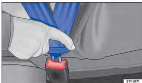
Fig. 26 Introducir la pestaña de encastre del cinturón de seguridad en el cierre del cinturón.
