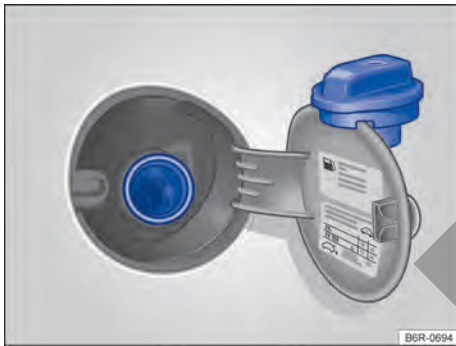
Fig. 97 Portezuela del depósito de combustible abierta con el tapón de cierre del depósito de combustible colgado.
