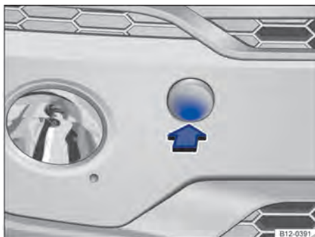
Fig. 117 En el parachoques delantero a la derecha: suelte y desmonte la cubierta.
