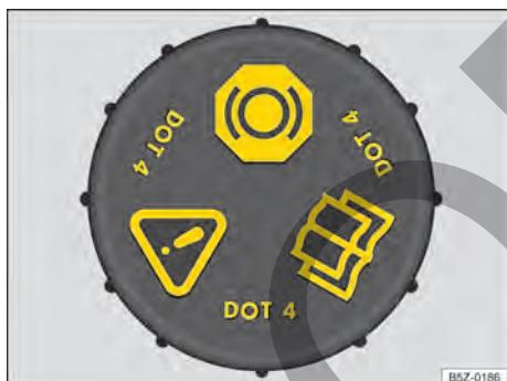
Fig. 127 En el compartimento del motor: tapón de cierre del depósito del líquido de frenos (variante 2).
