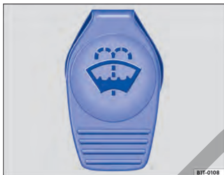
Fig. 121 En el compartimento del motor: tapón de cierre del depósito de agua de los lavavidrios.
