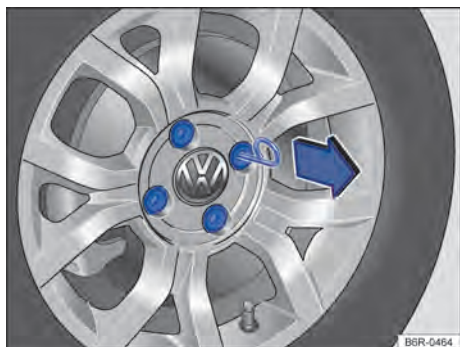
Fig. 137 Retirar las caperuzas de los tornillos de rueda.
