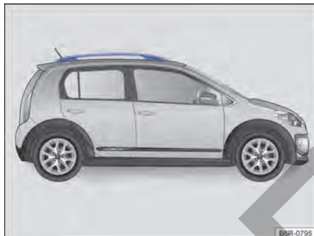
Fig. 96 Soportes longitudinales del maleteros de techo (ambos lados).
