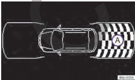
Fig. 88 Indicación del display del control de distancia de estacionamiento delantero y trasero en la radio (no disponible para algunas versiones).
