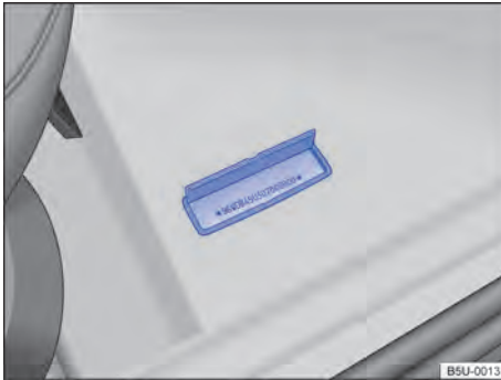
Fig. 215 Delante del asiento del acompañante delantero: número de identificación del vehículo (número del chasis) en el piso, delante del asiento del acompañante delantero.
