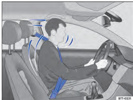
Fig. 26 Conductor protegido por el cinturón de seguridad correctamente colocado en una maniobra de frenado súbita.
