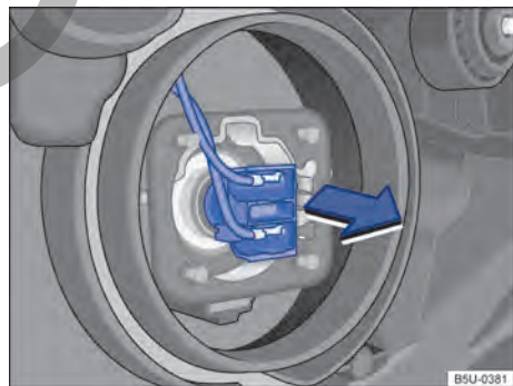
Fig. 176 Acceso a la bombilla del faro bajo.
