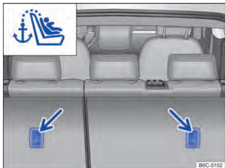
Fig. 42 Ojales de retención para el cinturón de fijación superior en el lado de atrás del asiento trasero.
