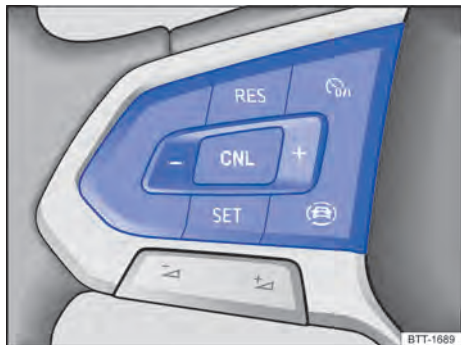
Fig. 91 Lado izquierdo del volante multifunción: teclas para comandar el GRA.
