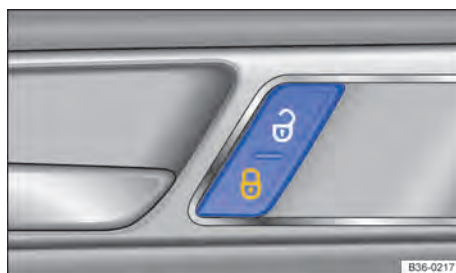
Fig. 51 En la puerta del conductor: tecla del cierre centralizado.
