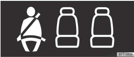
Fig. 21 Indicador de estatus del cinturón de seguridad para los asientos traseros en el display del instrumento combinado.
