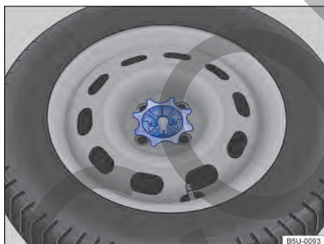
Fig. 186 En el maletero: manivela para fijación de la rueda de emergencia.
