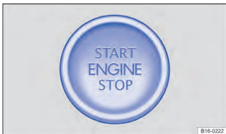
Fig. 85 En la parte inferior de la consola central: tecla de arranque para poner en marcha el motor
