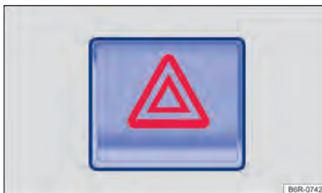
Fig. 45 En la parte superior de la consola central: interruptor de las luces de advertencia.
