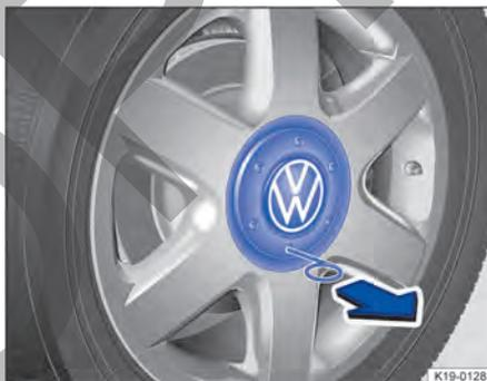
Fig. 162 Desmontar el tapacubos central tirando de él.
