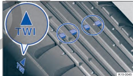
**Fig. 160** Perfil del neumático: indicadores de desgaste.
