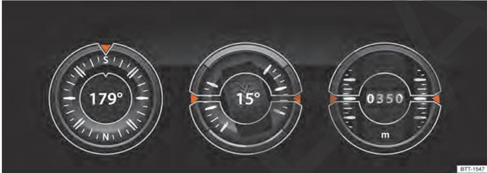
Fig. 93 En el sistema de infotainment: indicador Offroad.
