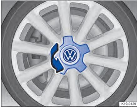
**Fig. 163** Desmontar el tapacubos central girándolo.
