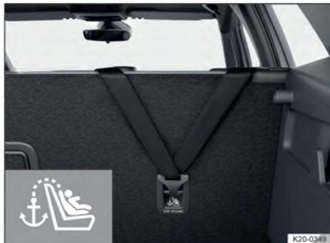
Fig. 38 En el maletero: cinturón de fijación superior enganchado.
