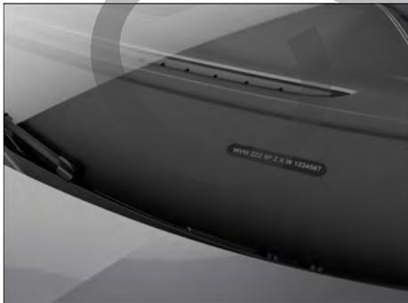
**Fig. 177** En el parabrisas: número de identificación del vehículo.
