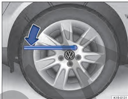
Fig. 166 Cambio de rueda: aflojar los tornillos de rueda.
