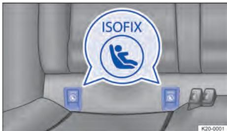
**Fig. 36** Señalización de los puntos de anclaje ISOFIX para los asientos para niños en las plazas del asiento trasero.
