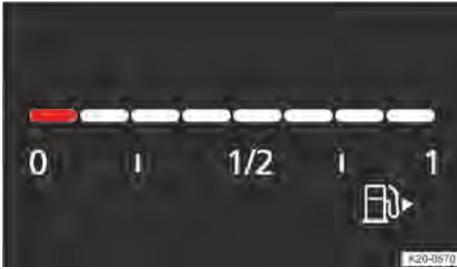
**Fig. 13** Indicador del nivel de combustible en el cuadro de instrumentos digital (variante 2, representación esquemática).
