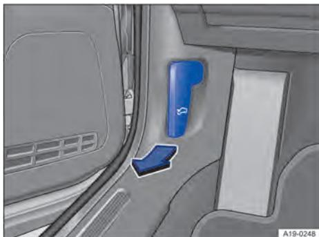
**Fig. 145** En la zona reposapiés del lado del conductor: palanca de desbloqueo del capó delantero (representación esquemática).
