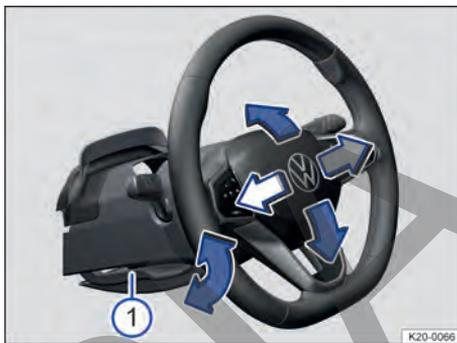
**Fig. 55** Debajo del volante, en el guardac遨 de la columna de dirección: palanca para el ajuste manual de la posición del volante.
