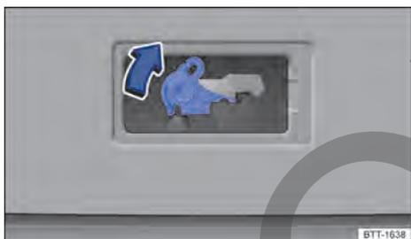
Fig. 52 En el maletero: desbloqueo de emergencia del portón.
