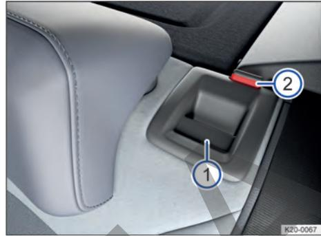
Fig. 60 En el respaldo del asiento trasero: tecla de desbloqueo.
