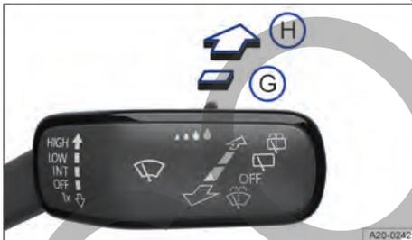
Fig. 73 En el lado derecho de la columna de dirección: manejo del limpialuneta.
