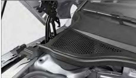
**Fig. 174** Entre el vano motor y el parabrisas: caja de aguas (representación esquemática).
