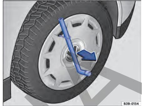
**Fig. 164** Desmontar el tapacubos integral.
