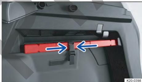
**Fig. 39** En el lado derecho del maletero: soporte del triángulo de preseñalización.
