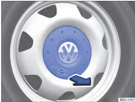
Fig. 190 Desmontar la taza de rueda central.
