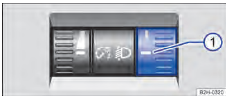
Fig. 74 Junto al volante: regulador del alcance de las luces ①.
