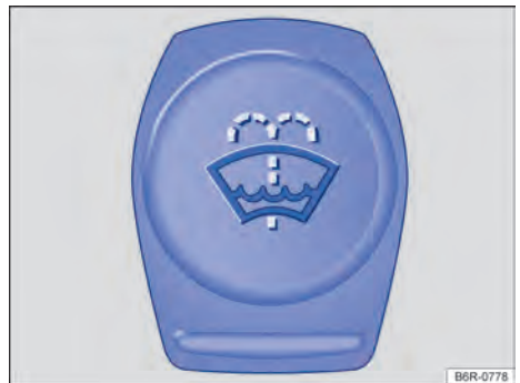
Fig. 173 En el compartimento del motor: tapa del depósito del líquido lavacrystales.
