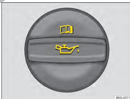
Fig. 177 En el compartimento del motor: tapa de la boca de llenado de aceite del motor (representación esquemática).
