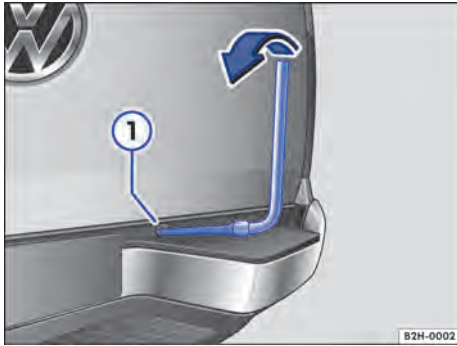
Fig. 195 Controlar el cable elevador con el malacate.
