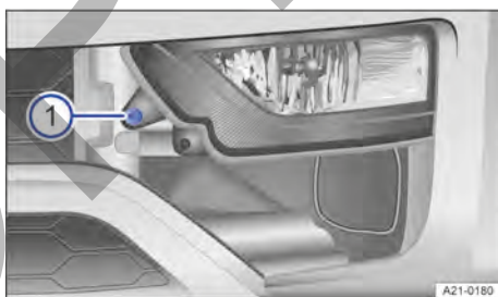
Fig. 147 En el paragolpes delantero: desmontar el faro.
