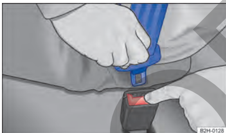
Fig. 22 Soltar la lengüeta del cierre del cinturón.
