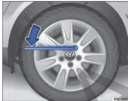
Fig. 192 Cambio de rueda: aflojar los tornillos de rueda.
