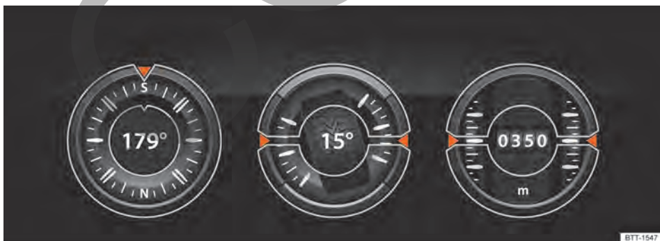
Fig. 100 En el sistema de infotainment: indicador Offroad.
