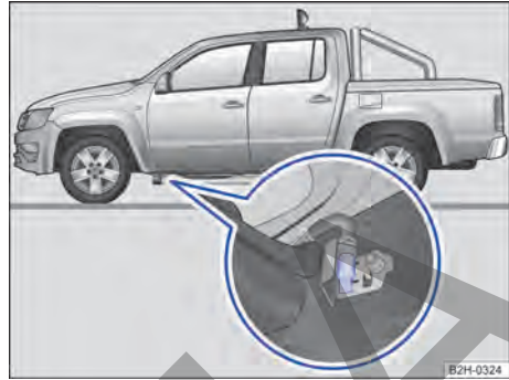
Fig. 133 En los bajos del vehículo, en el larguero: tornillo de desagüe del filtro de gasoil (en función del equipamiento).
