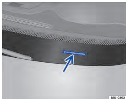
Fig. 214 En el parabrisas: número de identificación del vehículo.
