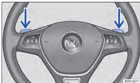
Fig. 95 Volante con palancas de cambio para el Tiptronic.
