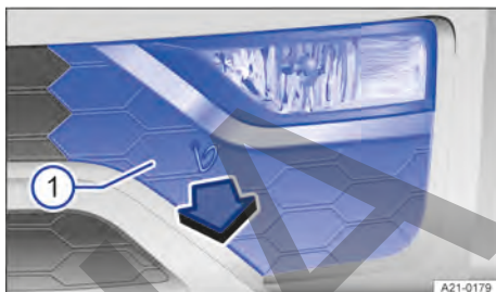
Fig. 146 En el paragolpes delantero: desmontar la cubierta.
