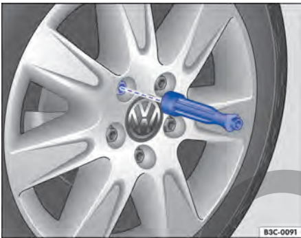
Fig. 209 Cambio de rueda: desenroscar los tornillos de rueda con el mango del destornillador.
