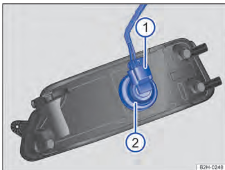
Fig. 148 Cambiar la lámpara del faro.
