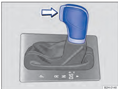
Fig. 93 Vehículo con el volante a la izquierda: palanca selectora del cambio automático con tecla de bloqueo (flecha). En los vehículos con el volante a la derecha, la disposición es simétrica.
