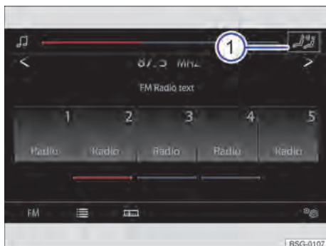
Fig. 120 Visualización en la pantalla de la consola central: botón de función para acceder a la amplificación digital de la voz.
