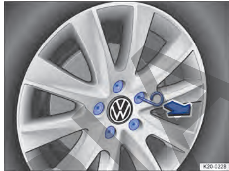
Fig. 191 Retirar las tapas de los tornillos de rueda.
