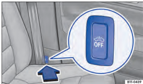
Fig. 49 Junto al asiento del conductor: tecla para desconectar la vigilancia del habitáculo y el sistema antirremolcado.
