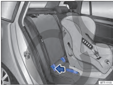
Fig. 39 Representación esquemática: montaje de un asiento para niños ISOFIX con conectores.
