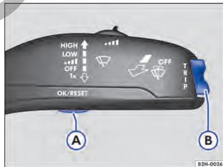
Fig. 13 En la palanca del limpiaparabrisas: teclas para manejar los menús.
