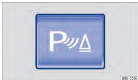
Fig. 109 En la consola central: tecla para conectar y desconectar la ayuda de estacionamiento (en función del equipamiento).
