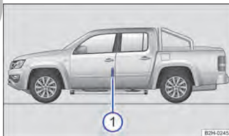
Fig. 187 En la puerta del conductor ①: adhesivo de la presión de los neumáticos (o en el lado interior de la tapa del tanque de combustible).
