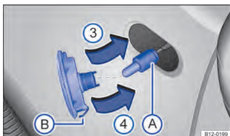
Fig. 153 Luz de giro lateral: sustituir la lámpara.
