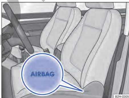
Fig. 33 Lateral de un asiento delantero: ubicación del airbag lateral para la cabeza y el tórax (variante 1).
