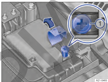
Fig. 163 En el lado izquierdo del compartimento del motor debajo de una cubierta: toma para la ayuda de arranque (polo positivo).
