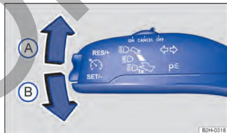
Fig. 73 En el lado izquierdo de la columna de dirección: palanca de las luces de giro y de la luz alta.
