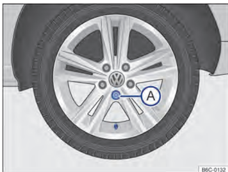
Fig. 197 Retire el tapacubos integral. ▶
