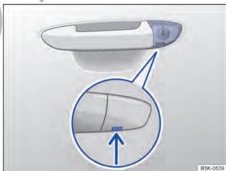
Fig. 53 Manilla de la puerta del conductor: botón de cierre cubierto.
