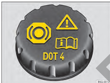
Fig. 188 En el compartimento del motor: tapón de cierre del depósito del líquido de frenos.
