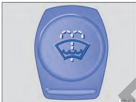
Fig. 183 En el compartimento del motor: tapón de cierre del depósito de agua de los lavavidrios.
