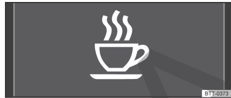
Fig. 16 En el display del instrumento combinado: símbolo del sistema de detección del cansancio.
