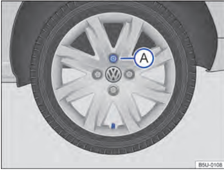
Fig. 218 Cambio de rueda: secuencia de desmontaje de los tornillos de la rueda.
