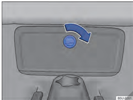
Fig. 171 En el piso del asiento trasero: acceso a la caja de fijación de las herramientas de a bordo.
