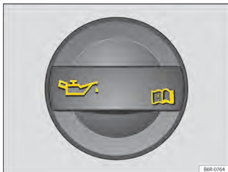
Fig. 200 En el compartimento del motor: tapón de la boca de llenado del aceite del motor.
