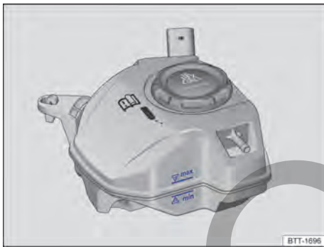
Fig. 225 En el compartimento del motor: marca en el depósito de expansión del líquido refrigerante del motor.
