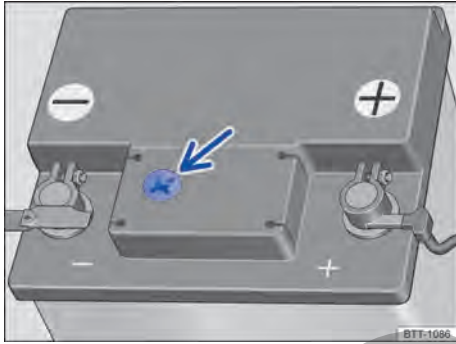
Fig. 228 En el compartimento del motor: ejemplo de posición del visor en el lado superior de la batería del vehículo.
