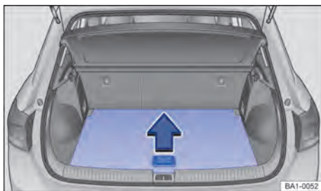
Fig. 193 En el maletero: levantar el piso del maletero. ▶
