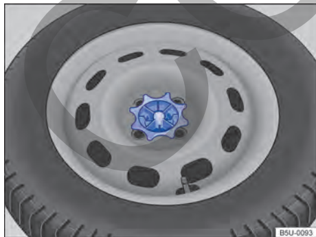
Fig. 234 En el maletero: manivela para fijación de la rueda de emergencia.
