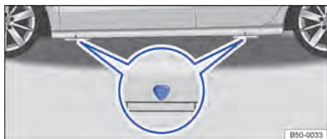
Fig. 238 Puntos de apoyo del gato.
