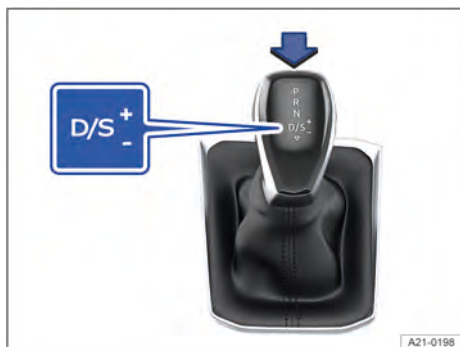
Fig. 90 Palanca selectora del cambio automático con tecla de bloqueo (flecha).
