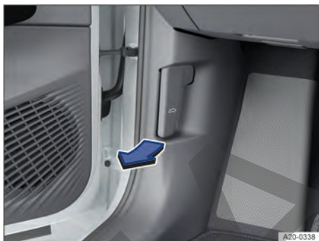
Fig. 149 En la zona reposapiés del lado del conductor: palanca de desbloqueo del capó delantero (representación esquemática).
