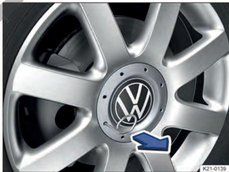
Fig. 168 Desmontar el tapacubos central tirando de él.
