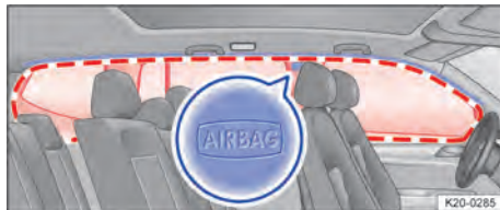
Fig. 32 En el lado izquierdo del vehículo: ubicación y zona de despliegue del airbag para la cabeza.
