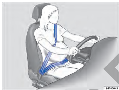
Fig. 24 Colocación correcta de la banda del cinturón en las mujeres embarazadas.
