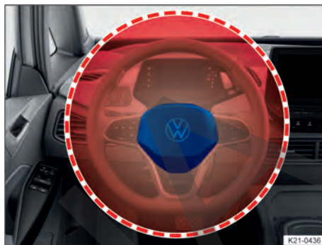
Fig. 28 Ubicación y zona de despliegue del airbag frontal del conductor.
