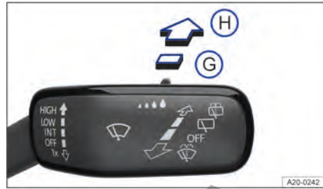
Fig. 75 En el lado derecho de la columna de dirección: manejo del limpiacristales.
