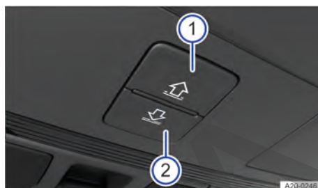
Fig. 81 En el revestimiento interior del techo: teclas para manejar la cortinilla parasol.
