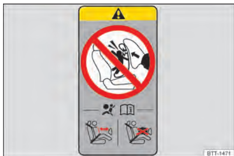
Fig. 35 Representación esquemática: etiqueta adhesiva relativa al airbag en el pilar B.
