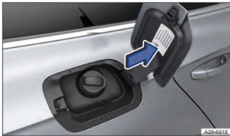
Fig. 128 En la cara interior de la tapa del depósito de combustible: adhesivo del combustible (representación esquemática).
