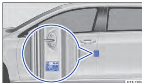
Fig. 165 En el pilar de la puerta del conductor: adhesivo de la presión de los neumáticos (o en la cara interior de la tapa del depósito de combustible).
