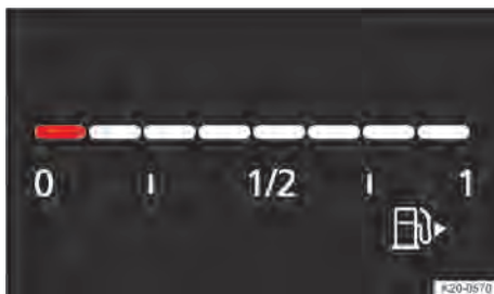
Fig. 14 Indicador del nivel de combustible en el cuadro de instrumentos digital, versión Basic (representación esquemática).
