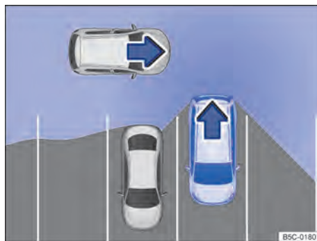
Fig. 113 Representación esquemática del asistente de salida del aparcamiento: zona vigilada alrededor del vehículo que está desaparcando.
