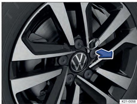
Fig. 170 Retirar las caperuzas de los tornillos de rueda.
