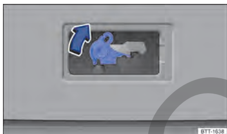
Fig. 54 En el maletero: desbloqueo de emergencia del portón.
