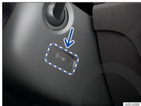
Fig. 88 En el lado derecho de la columna de dirección: función de arranque de emergencia.
