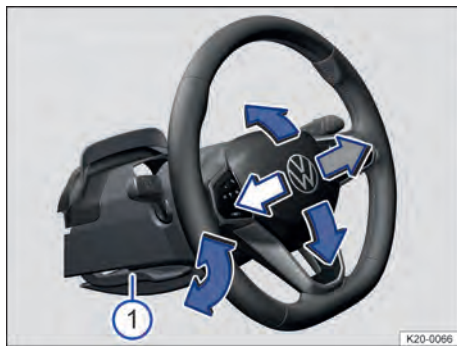
Fig. 57 Debajo del volante, en el guarnecido de la columna de dirección: palanca para el ajuste manual de la posición del volante (representación esquemática).
