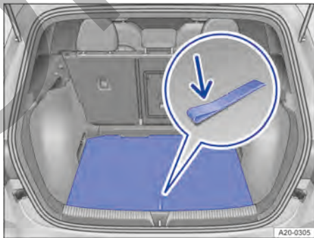
Fig. 120 En el maletero: abrir el piso del maletero.
