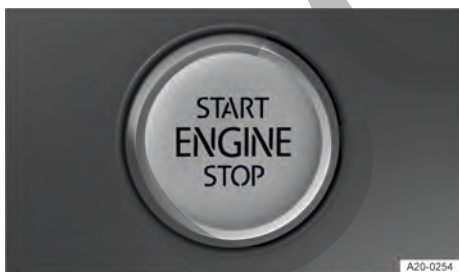
Fig. 87 En la parte inferior de la consola central: pulsador de encendido y arranque para poner el motor en marcha.
