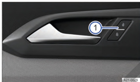
Fig. 46 En la puerta del conductor: tecla del cierre centralizado.
