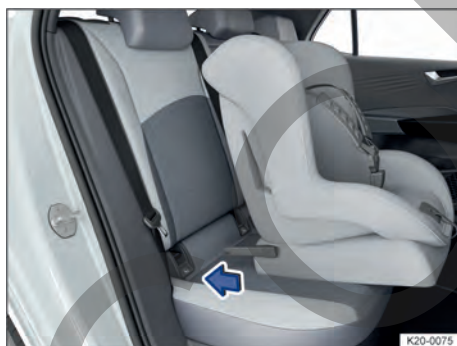
Fig. 36 Representación esquemática: montaje de un asiento para niños con conectores.
