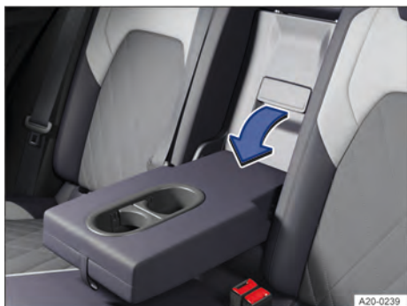
Fig. 123 Trampilla para cargas largas en el respaldo del asiento trasero (representación esquemática).
