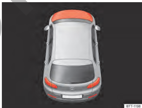
Fig. 153 En la pantalla del cuadro de instrumentos: capó delantero abierto o no cerrado correctamente (representación esquemática).
