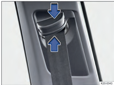
Fig. 25 Junto a los asientos delanteros: regulador de la altura del cinturón.
