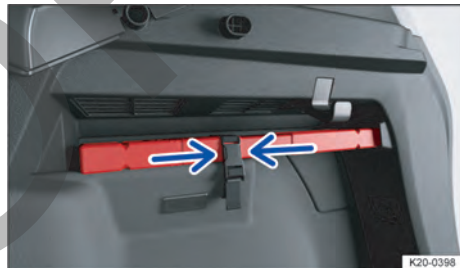
Fig. 38 En el lado derecho del maletero: soporte del triángulo de preseñalización.
