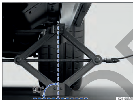
Fig. 178 Gato colocado en el lado izquierdo del vehículo, en la zona trasera.
