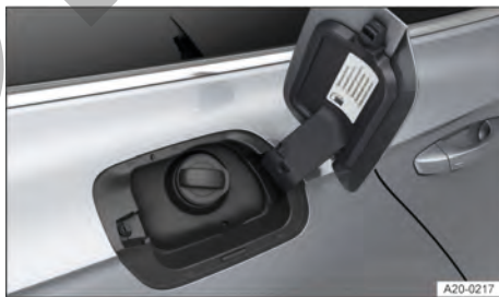
Fig. 131 Detrás de la tapa del depósito de combustible: tapón del depósito (representación esquemática).
