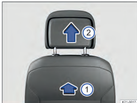
Fig. 65 Representación esquemática: desmontaje de los apoyacabezas delanteros.
