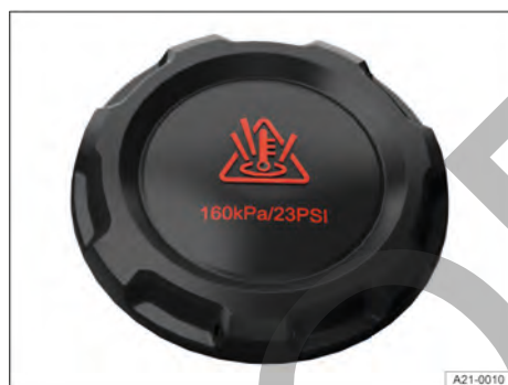
Fig. 159 En el vano motor: tapa del depósito de expansión del líquido refrigerante del motor (representación esquemática).
