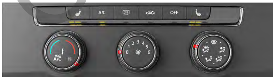
Fig. 83 En la parte superior de la consola central: panel de mandos del climatizador manual.
