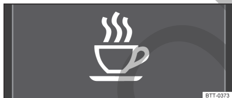
Fig. 18 En la pantalla del cuadro de instrumentos: símbolo de detección del cansancio.
