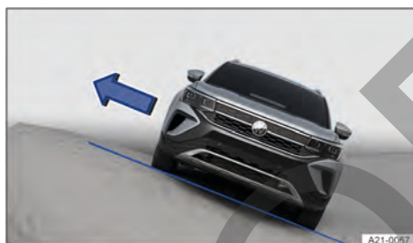
Fig. 99 Representación esquemática: bajar del vehículo siempre por el lado que mira a la cima.
