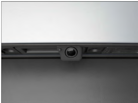
Fig. 181 En la parte trasera del vehículo: cámara de marcha atrás en la manilla con pulsador (representación esquemática).
