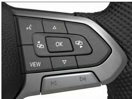
Fig. 12 Lado derecho del volante multifunción: teclas para utilizar los menús y las indicaciones informativas del cuadro de instrumentos digital, versión Basic.
