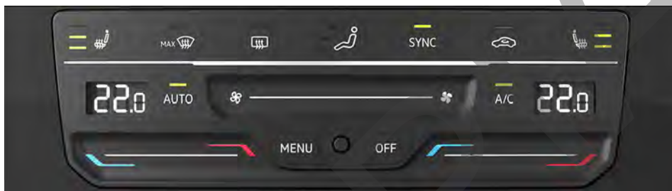
Fig. 82 En la parte superior de la consola central: panel de mandos del Climatronic.
