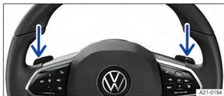
Fig. 92 Volante con levas de cambios para el Tiptronic.
