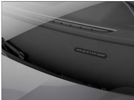
Fig. 183 En el parabrisas: número de identificación del vehículo.
