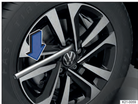
Fig. 179 Cambio de rueda: desenroscar los tornillos de rueda con la llave de rueda.
