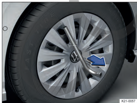
Fig. 169 Desmontar el tapacubos integral.
