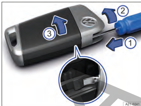
Fig. 42 Llave del vehículo: abrir la tapa del compartimento de la pila.
