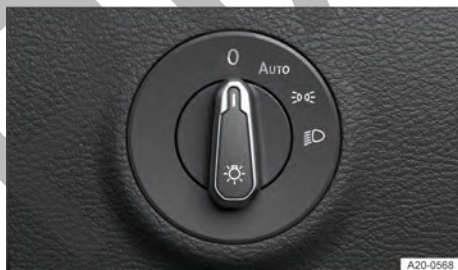
Fig. 71 Junto al volante: mando de las luces.
