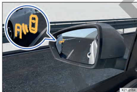
Fig. 109 En los retrovisores exteriores: indicación del detector de ángulo muerto.
