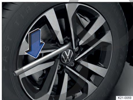
Fig. 171 Cambio de rueda: aflojar los tornillos de rueda.
