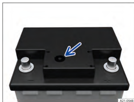
Fig. 162 Mirilla en la parte superior de la batería de 12 voltios (representación esquemática).
