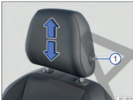
Fig. 63 Representación esquemática: ajuste de los apoyacabezas delanteros.
