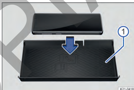
Fig. 118 Representación estándar de la superficie de alojamiento con estera para la función de carga inalámbrica.
