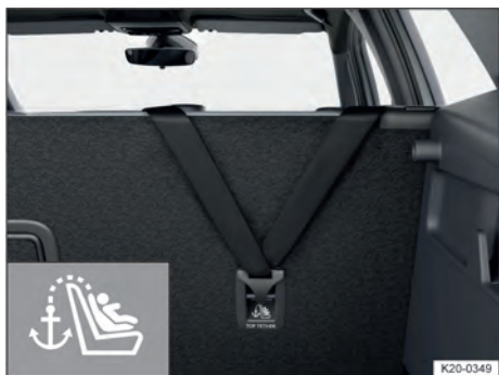
Fig. 37 En el maletero: cinturón de fijación superior enganchado.
