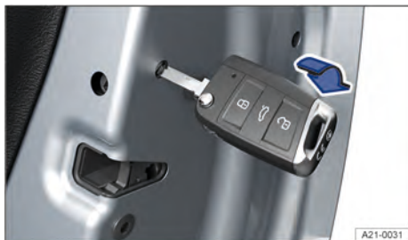
Fig. 48 En el frontal de una puerta: bloqueo de emergencia del vehículo con el paletón de la llave o la llave de emergencia (variante 1).
