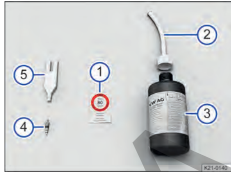
Fig. 267 Representación esquemática: componentes del kit reparapinchazos.
