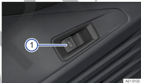
Fig. 71 En la puerta del conductor: tecla de desbloqueo del portón del maletero.
