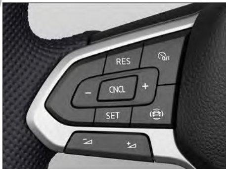
Fig. 146 Lado izquierdo del volante multifunción (variante 1).
