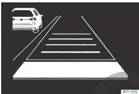
Fig. 150 En la pantalla del cuadro de instrumentos: vehículo detectado que circula más lentamente que el propio por el carril izquierdo (representación esquemática).
