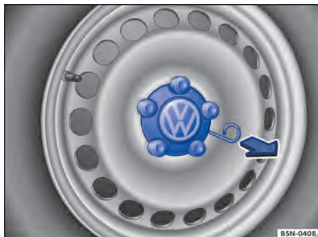
Fig. 255 Desmontar el tapacubos central tirando de él.
