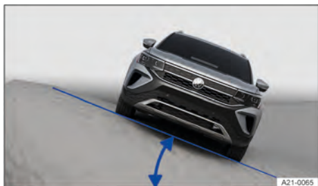
Fig. 143 Representación esquemática: ángulo de inclinación.
