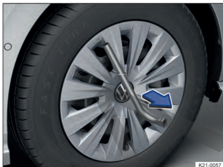
Fig. 256 Desmontar el tapacubos integral.
