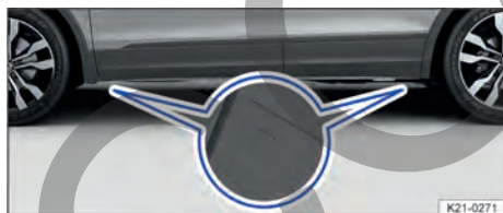
Fig. 263 Puntos de apoyo para el gato (representación esquemática).
