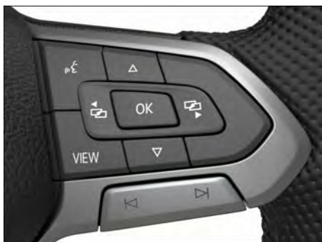
Fig. 11 Lado derecho del volante multifunción: teclas para utilizar los menús y las indicaciones informativas del cuadro de instrumentos digital, versión Pro (variante 1).
