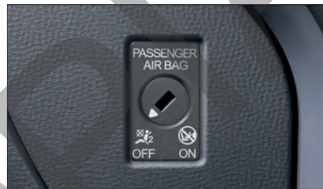
Fig. 39 En el tablero de instrumentos, en el lado del acompañante: conmutador de llave para desactivar y activar el airbag frontal del acompañante.
