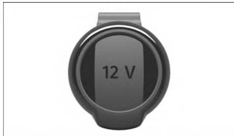
Fig. 182 En el portaobjetos delantero, en la parte trasera de la consola central o en el lado izquierdo del maletero: toma de corriente de 12 voltios con tapa plegable (representación esquemática).
