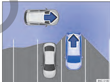
Fig. 178 Representación esquemática del asistente de salida del aparcamiento: zona vigilada alrededor del vehículo que está desaparcando.
