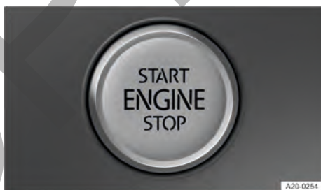
Fig. 131 En la parte inferior de la consola central: pulsador de encendido y arranque para poner el motor en marcha.
