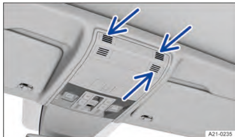
Fig. 68 En la consola del techo: sensores de la vigilancia del habitáculo (flechas).
