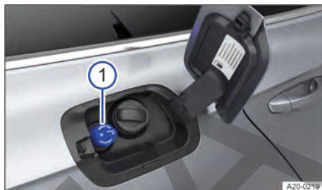
Fig. 211 Detrás de la tapa del depósito de combustible: tapón del depósito de AdBlue (representación esquemática).
