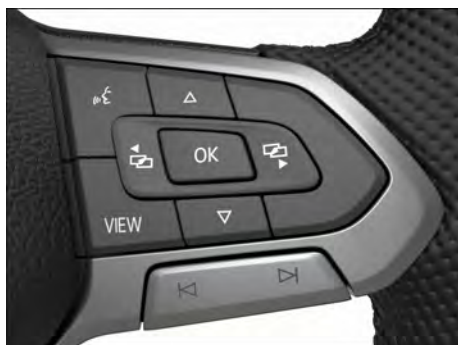
Fig. 15 Lado derecho del volante multifunción: teclas para utilizar los menús y las indicaciones informativas del cuadro de instrumentos digital, versión Basic (variante 1).
