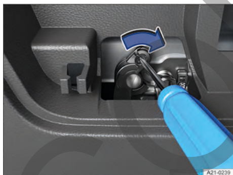
Fig. 76 En el portón del maletero: desbloqueo de emergencia del portón.
