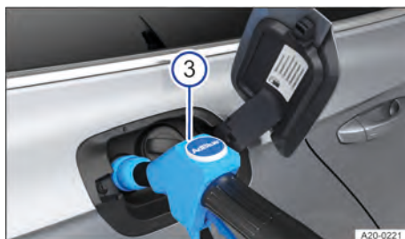
Fig. 213 Detrás de la tapa del depósito de combustible: repostar AdBlue con la pistola de un surtidor (representación esquemática).
