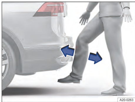
Fig. 74 Representación esquemática del portón del maletero con cierre controlado por sensor (Easy Close).
