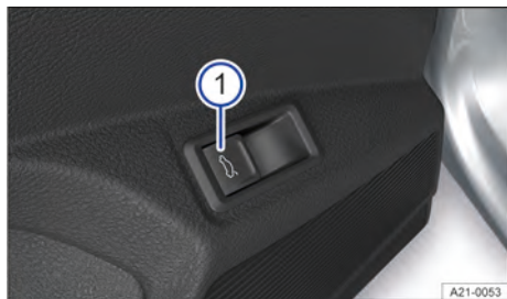
Fig. 64 En la puerta del conductor: tecla para la apertura eléctrica del portón del maletero (representación esquemática).
