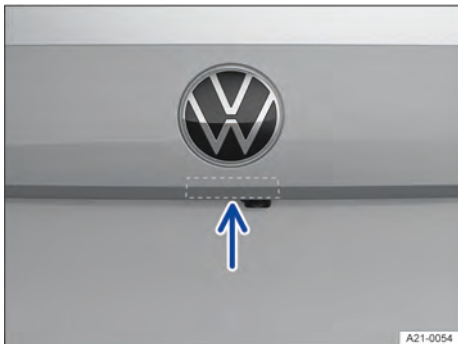
Fig. 69 En el portón del maletero: pulsador para abrir el portón (representación esquemática).
