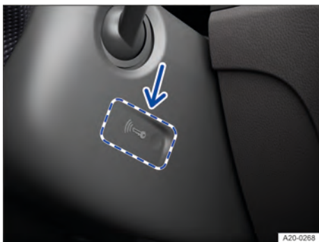
Fig. 132 En el lado derecho de la columna de dirección: función de arranque de emergencia en los vehículos con el sistema de cierre y arranque sin llave "Keyless Access".
