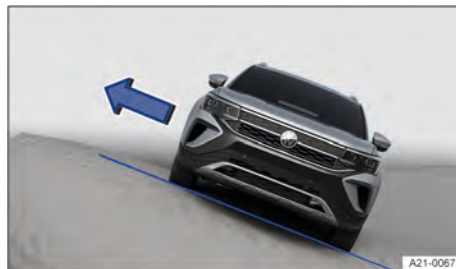
Fig. 145 Representación esquemática: bajar del vehículo siempre por el lado que mira a la cima.
