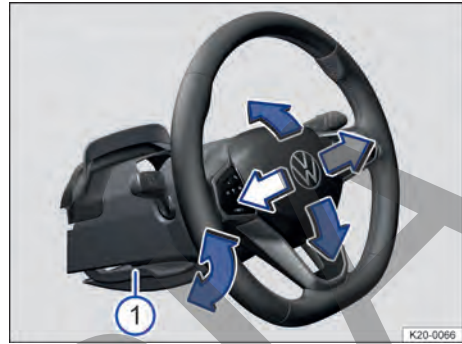
Fig. 78 Debajo del volante, en el guarnecido de la columna de dirección: palanca para el ajuste manual de la posición del volante (representación esquemática).
