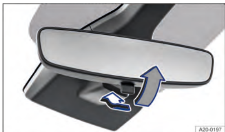
Fig. 116 En el parabrisas: retrovisor interior antideslumbrante manual.
