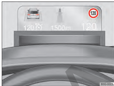
Fig. 23 En el tablero de instrumentos, encima del volante: ejemplos de indicaciones en el Head-up-Display.
