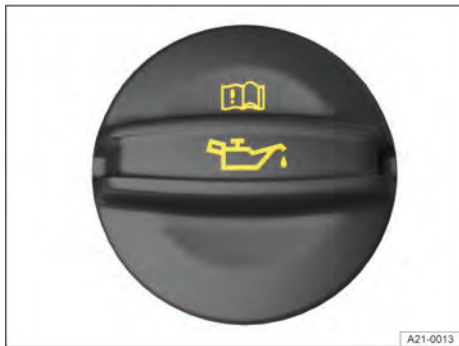
Fig. 243 En el vano motor: tapa de la boca de llenado de aceite del motor (representación esquemática).
