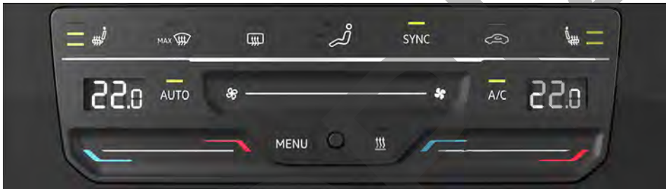
Fig. 121 En la parte superior de la consola central: panel de mandos del Climatronic.
