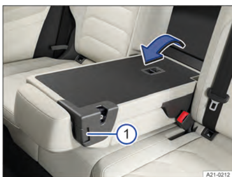
Fig. 200 En el respaldo del asiento trasero: apertura de la trampilla para cargas largas.
