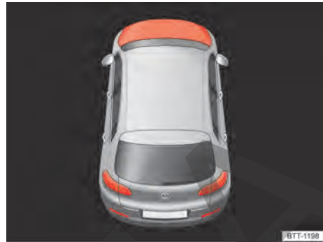
Fig. 239 En la pantalla del cuadro de instrumentos: capó delantero abierto o no cerrado correctamente (representación esquemática).
