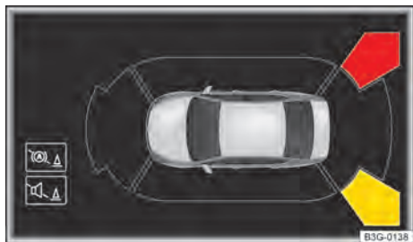
Fig. 179 Sistema de infotainment: visualización del asistente de salida del aparcamiento.
