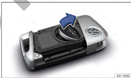
Fig. 58 Llave del vehículo: cambiar la pila de botón.
