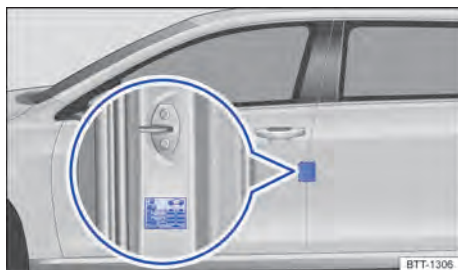
Fig. 252 En el pilar de la puerta del conductor: adhesivo de la presión de los neumáticos (o en la cara interior de la tapa del depósito de combustible).
