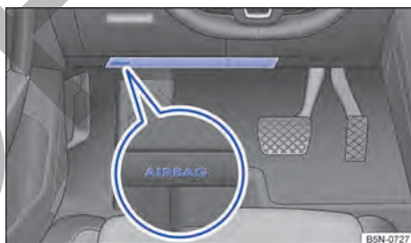
Fig. 44 En el lado del conductor: ubicación del airbag para las rodillas.
