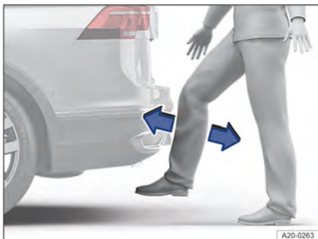
Fig. 73 Representación esquemática del portón del maletero con apertura controlada por sensor (Easy Open).
