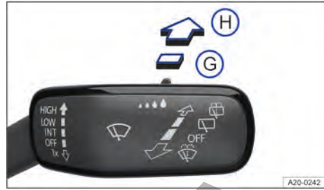
Fig. 113 En el lado derecho de la columna de dirección: manejo del limpiacristales.
