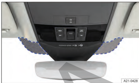
Fig. 120 Junto a la base del retrovisor: ventana de comunicación.
