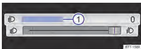
Fig. 111 En el sistema de infotainment: regulador táctil para la regulación del alcance de las luces.
