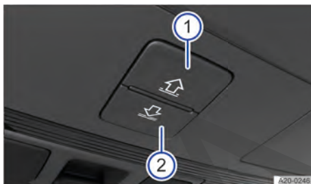
Fig. 119 En el revestimiento interior del techo: teclas para manejar la cortinilla parasol.
