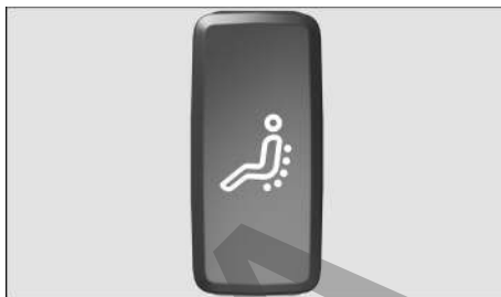
Fig. 105 En la parte inferior del asiento del conductor: tecla de la función de masaje.
