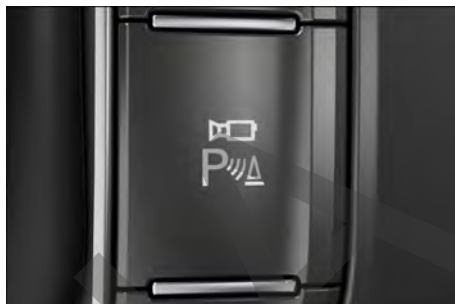
Fig. 174 En la consola central: tecla para conectar y desconectar el sistema de visión periférica.
