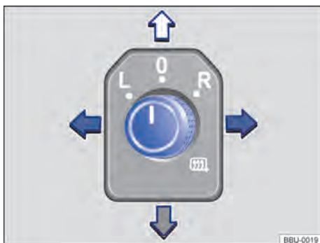
Fig. 90 En la puerta del conductor: mando giratorio de los retrovisores exteriores.
