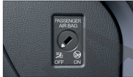
Fig. 35 En el tablero de instrumentos, en el lado del acompañante: conmutador de llave para desactivar y activar el airbag frontal del acompañante.
