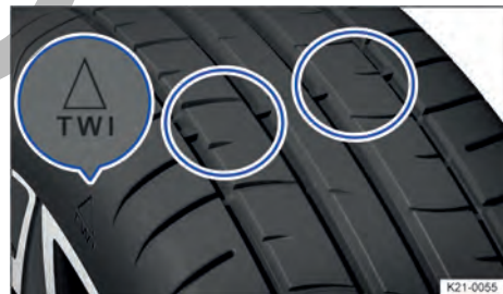
Fig. 182 Perfil del neumático: indicadores de desgaste.
