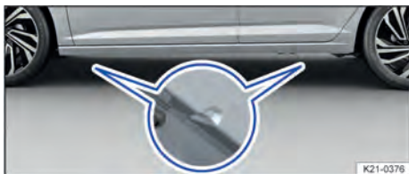
Fig. 191 Puntos de apoyo para el gato (variante 1).
