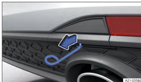
Fig. 163 En el lado derecho del paragolpes trasero: retirar la tapa, variante 2.
