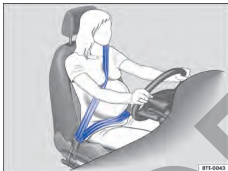
Fig. 29 Colocación correcta de la banda del cinturón en las mujeres embarazadas.
