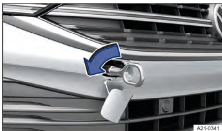
Fig. 159 En el lado derecho del paragolpes delantero: enroskar la argolla de remolque, variante 1.
