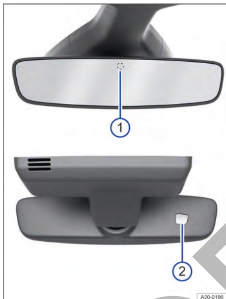
Fig. 88 En el parabrisas: retrovisor interior antideslumbrante automático.
