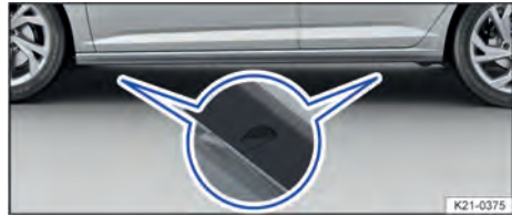
Fig. 192 Puntos de apoyo para el gato (variante 2).
