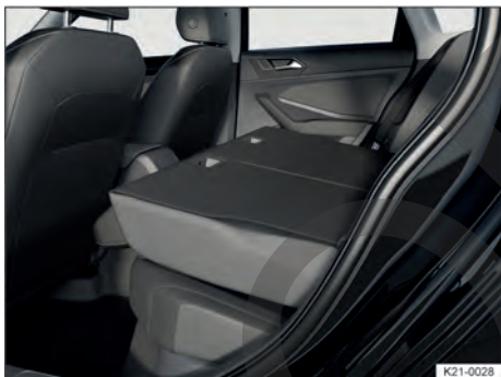
Fig. 71 Asiento trasero: respaldo abatido hacia delante.
