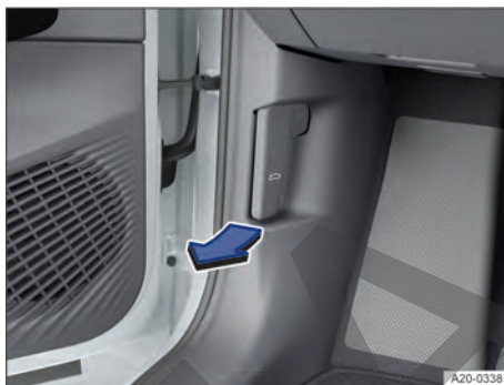
Fig. 165 En la zona reposapiés del lado del conductor: palanca de desbloqueo del capó delantero (representación esquemática).
