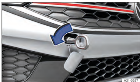
Fig. 160 En el lado derecho del paragolpes delantero: enrosca la argolla de remolque, variante 2.
