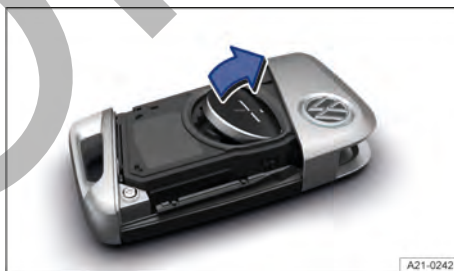
Fig. 53 Llave del vehículo: cambiar la pila de botón.
