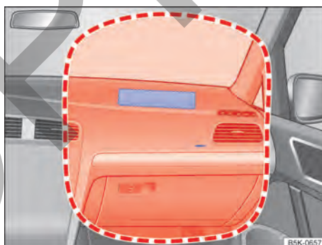
Fig. 34 Ubicación y zona de despliegue del airbag frontal del acompañante.
