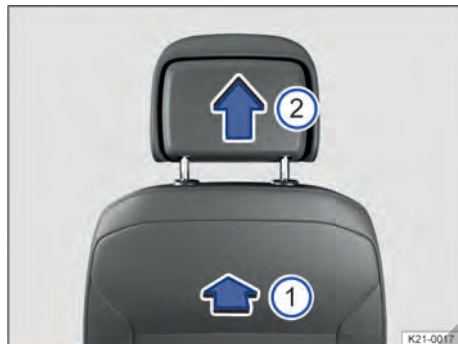
Fig. 74 Apoyacabezas delantero: desmontaje.
