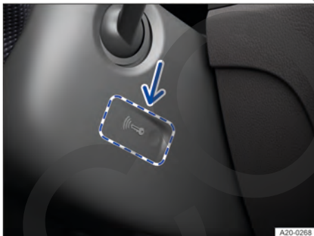
Fig. 101 En el lado derecho de la columna de dirección: función de arranque de emergencia en los vehículos con el sistema de cierre y arranque sin llave "Keyless Access".
