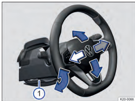
Fig. 65 Debajo del volante, en el guarnecido de la columna de dirección: palanca para el ajuste manual de la posición del volante (representación esquemática).
