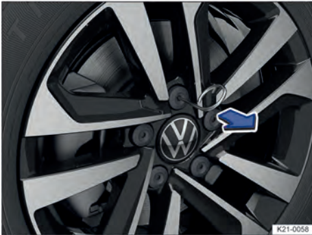
Fig. 186 Retirar las caperuzas de los tornillos de rueda.
