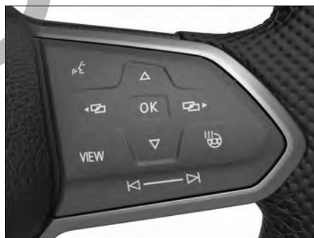
Fig. 14 Lado derecho del volante multifunción: teclas para utilizar los menús y las indicaciones informativas del cuadro de instrumentos digital, versión Basic (variante 2).
