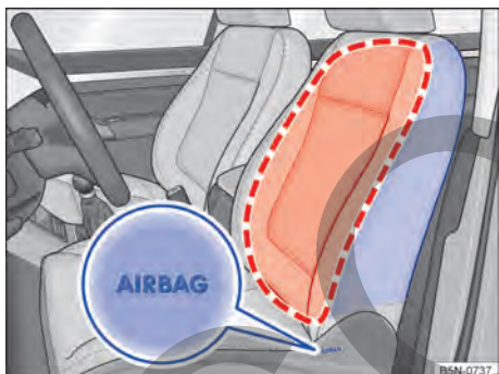
Fig. 37 Lateral de un asiento delantero: ubicación y zona de despliegue del airbag lateral.
