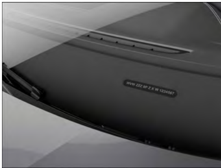
Fig. 201 En el parabrisas: número de identificación del vehículo.
