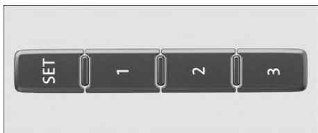
Fig. 79 En el lateral exterior del asiento del conductor: teclas de memoria.
