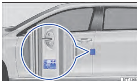
Fig. 181 En el pilar de la puerta del conductor: adhesivo de la presión de los neumáticos (o en la cara interior de la tapa del depósito de combustible).
