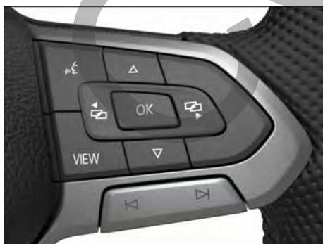
Fig. 13 Lado derecho del volante multifunción: teclas para utilizar los menús y las indicaciones informativas del cuadro de instrumentos digital, versión Basic (variante 1).
