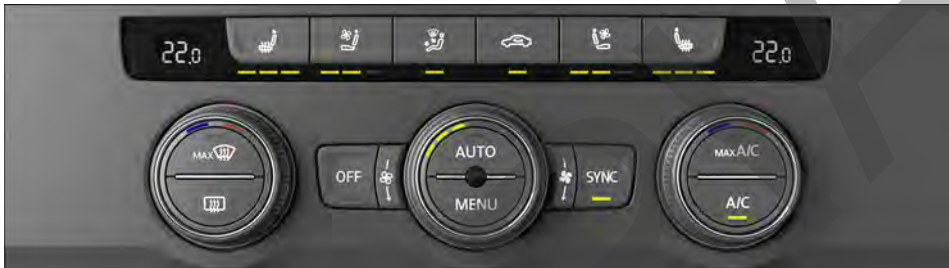
Fig. 92 En la parte superior de la consola central: panel de mandos del Climatronic.
