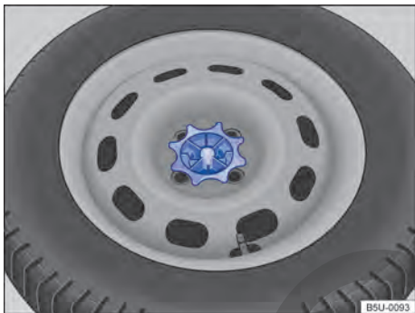
Fig. 195 En el maletero: manivela para fijación de la rueda de emergencia.
