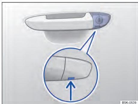
Fig. 53 Manilla de la puerta del conductor: bombín de cierre cubierto.
