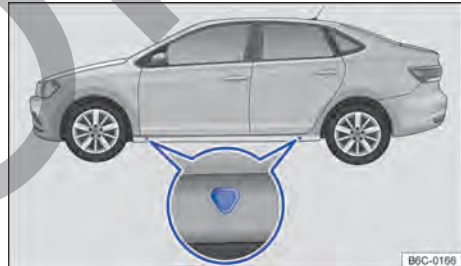
Fig. 200 Puntos de apoyo del gato.
