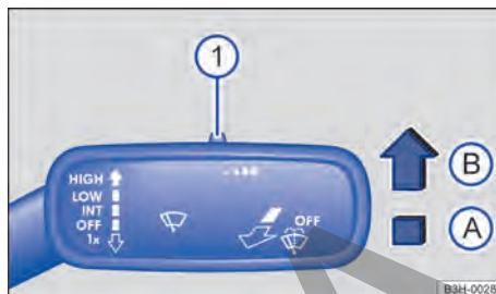
Fig. 74 A la derecha de la columna de dirección: palanca de los limpiaparabrisas.
