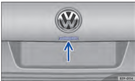
Fig. 58 En la tapa trasera: botón para abrir la tapa trasera.
