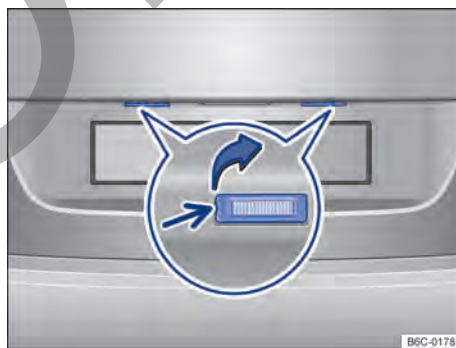
Fig. 169 En el parachoques trasero: luz de la placa de licencia.
