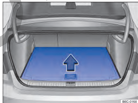
Fig. 148 En el maletero: levantar el piso variable del maletero.
