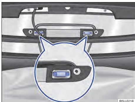
Fig. 142 Linterna de freno elevada: remover la lámpara incandescente de iluminación del compartimento de carga.
