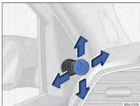
Fig. 71 En las puertas delanteras: interruptor de ajuste de los espejos retrovisores externos mecánicos.
