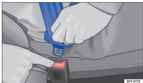
Fig. 28 Soltar la pestaña de encaste del cinturón de seguridad del cierre del cinturón.
