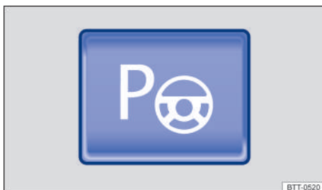
Fig. 118 En la consola central: tecla de encender el asistente de dirección de ayuda para aparcamiento.
