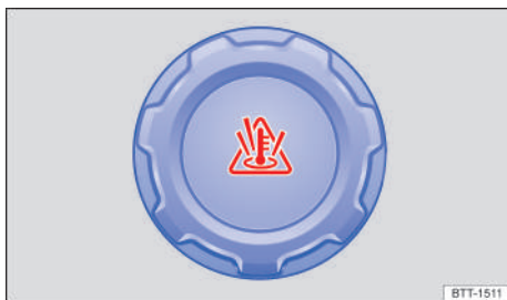
Fig. 174 En el compartimento del motor: tapa del depósito de expansión del líquido refrigerante del motor.
