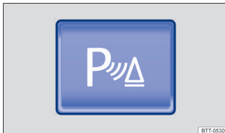
Fig. 115 En la consola central: tecla de encender y apagar la ayuda de aparcamiento.
