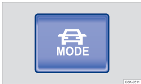
Fig. 100 En la parte superior de la consola central: tecla MODE de selección del perfil de conducción.
