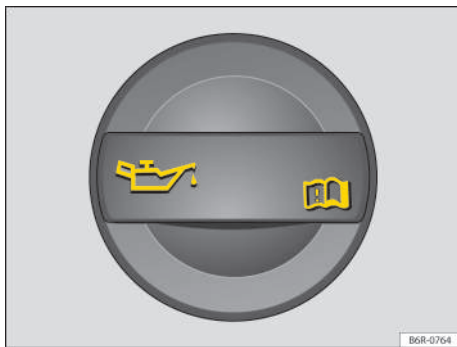
Fig. 172 En el compartimento del motor: tapón de la boca de llenado del aceite del motor.
