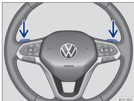
Fig. 98 Volante con selectores basculantes de Tiptronic.
