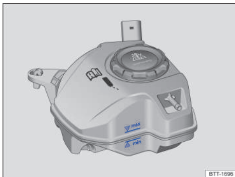
Fig. 173 En el compartimento del motor: marca en el depósito de expansión del líquido refrigerante del motor.
