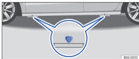
Fig. 186 Puntos de apoyo del gato.
