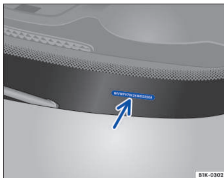
Fig. 193 En el parabrisas: número de identificación del vehículo.
