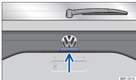
Fig. 56 En la tapa trasera: botón para abrir la tapa trasera.
