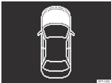
Fig. 169 En la pantalla del instrumento combinado: tapa del compartimiento del motor abierta o cerrada incorrectamente (representación esquemática).
