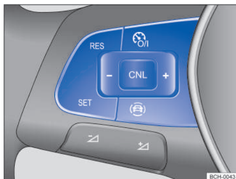
Fig. 105 Lado izquierdo del volante multifunción (variante 1): teclas para controlar el limitador de velocidad.
