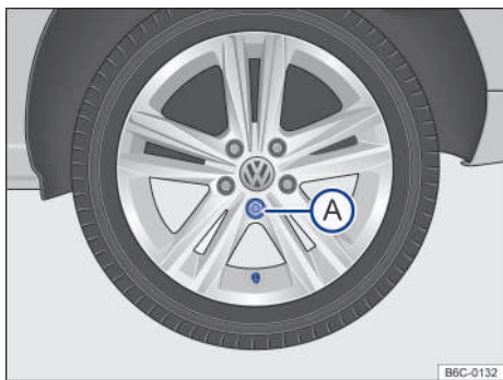
Fig. 188 Cambio de rueda: secuencia de desmontaje de los tornillos de la rueda.
