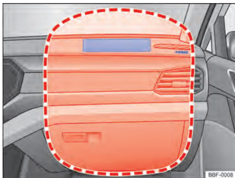
Fig. 34 Ubicación y radio de expansión del airbag frontal del acompañante.
