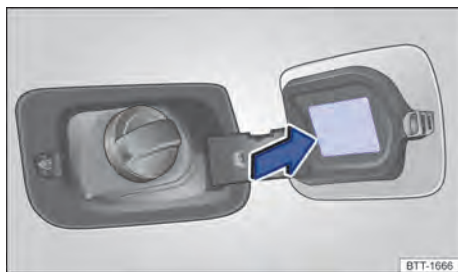
Fig. 180 En la parte interior de la portezuela del depósito de combustible: etiqueta con la presión de los neumáticos.
