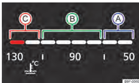
Fig. 14 Indicador de temperatura del líquido refrigerante del motor en el instrumento combinado digital (variante 2): (A) zona fría; (B) zona normal; (C) zona de alerta.
