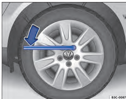
Fig. 184 Cambio de rueda: aflojar los tornillos de la rueda.
