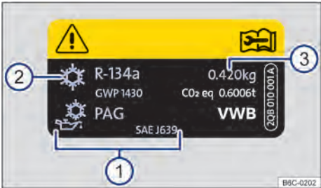
Fig. 194 Información del aire acondicionado
