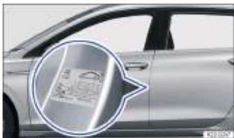
Fig. 179 En el pilar de la puerta del conductor: adhesivo de la presión de los neumáticos (o en la cara interior de la tapa del depósito de combustible).
