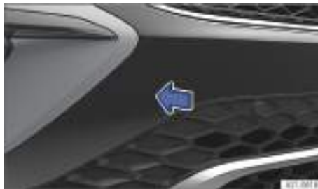
Fig. 162 En el lado derecho del paragolpes delantero: retirar la tapa.
