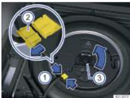
Fig. 185 En el maletero: desmontar el subwoofer (variante 1).
