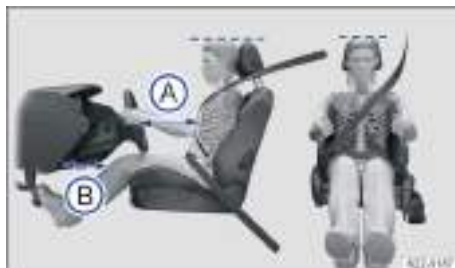
Fig. 21 Distancia correcta entre el conductor y el volante, colocación correcta de la banda del cinturón y ajuste correcto del apoyacabezas (representación esquemática).
