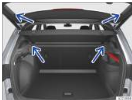
Fig. 131 En el maletero: desmontar y montar la cubierta (representación esquemática).
