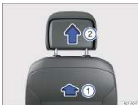
Fig. 65 Desmontaje de los apoyacabezas delanteros (representación esquemática).
