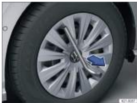
Fig. 189 Desmontar el tapacubos integral.
