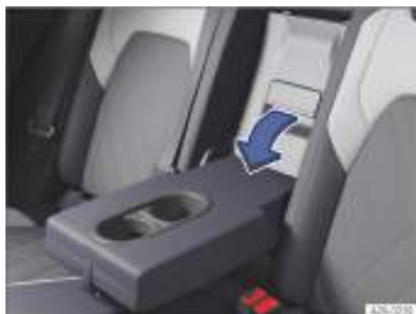
Fig. 135 En el respaldo del asiento trasero: trampilla para cargas largas (representación esquemática).
