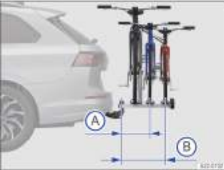
Fig. 140 Representación esquemática del voladizo máximo de la carga en un portabicicletas para dos o tres bicicletas.
