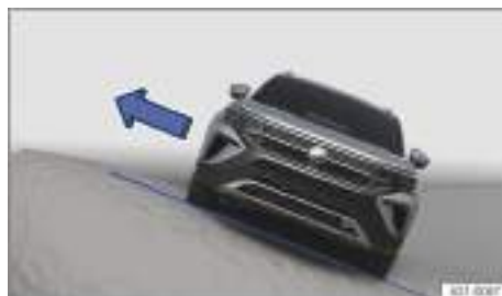
Fig. 98 Representación esquemática: bajar del vehículo siempre por el lado que mira a la cima.
