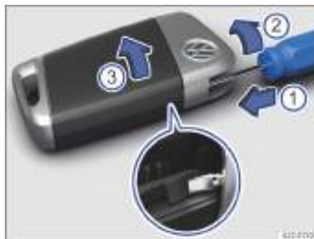
Fig. 42 Llave del vehículo: abrir la tapa del compartimento de la pila.
