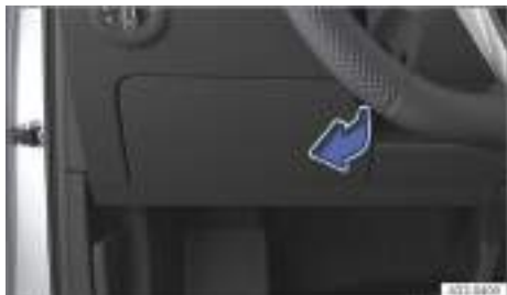
Fig. 156 En el tablero de instrumentos del lado del conductor: tapa de la caja de fusibles (representación esquemática).
