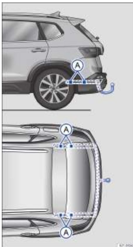
Fig. 138 Representación esquemática de los puntos de fijación para el montaje posterior de un dispositivo de remolque.
