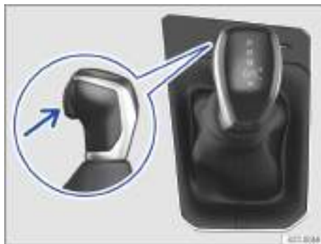
Fig. 89 En la consola central: palanca selectora del cambio automático (representación esquemática).
