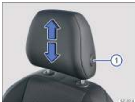
Fig. 63 Desmontaje de los apoyacabezas delanteros (representación esquemática).
