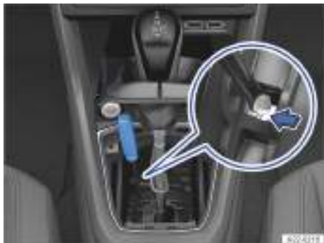
Fig. 92 En la consola central: realizar un desbloqueo de emergencia de la palanca selectora (variante 1).
