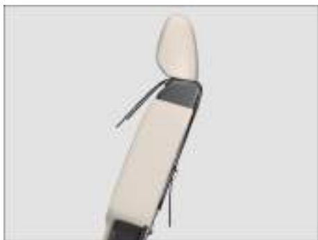
Fig. 37 En la parte posterior de las plazas laterales del asiento trasero: cinturón de fijación superior Top Tether enganchado.
