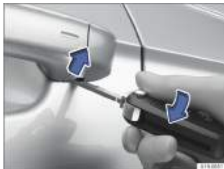
Fig. 47 Manilla de la puerta del conductor: desprender la caperuza haciendo palanca.
