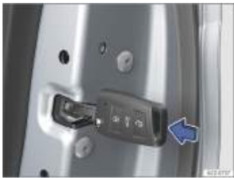
Fig. 49 En el frontal de la puerta trasera: bloqueo de emergencia del vehículo con el paletón de la llave o la llave de emergencia (variante 2).
