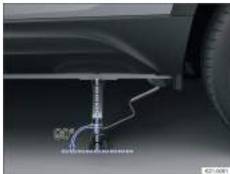
Fig. 193 Alineación correcta del gato.
