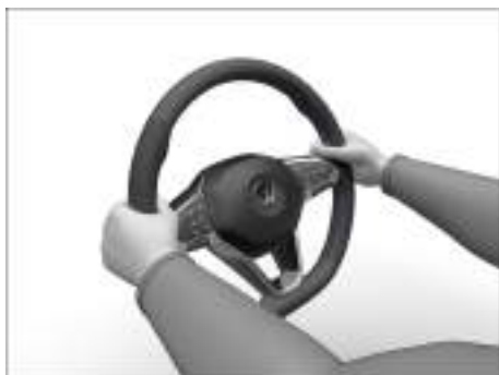
Fig. 58 En el volante: posición equivalente a las 9 y las 3 horas (representación esquemática).
