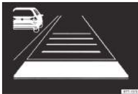
Fig. 108 En la pantalla del cuadro de instrumentos: vehículo detectado que circula más lentamente que el propio por el carril izquierdo (representación esquemática).
