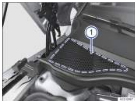
Fig. 199 Entre el vano delantero y el parabrisas: caja de aguas (representación esquemática).
