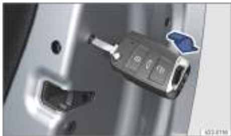
Fig. 48 En el frontal de la puerta trasera: bloqueo de emergencia del vehículo con el paletón de la llave o la llave de emergencia (variante 1).
