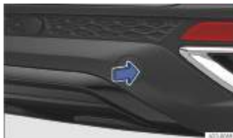
Fig. 164 En el lado derecho del paragolpes trasero: retirar la tapa.
