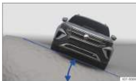
Fig. 96 Representación esquemática: ángulo de inclinación.
