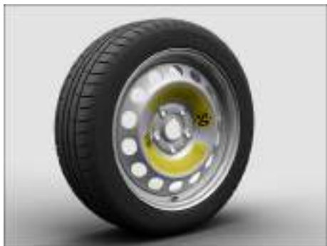
Fig. 254 Rueda de repuesto de tamaño reducido.
