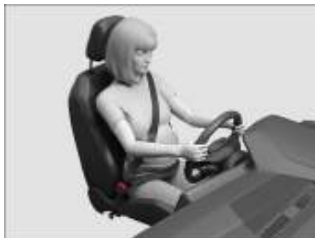
Fig. 33 Colocación correcta de la banda del cinturón en las mujeres embarazadas (representación esquemática).
