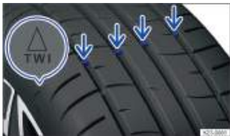
Fig. 257 En las acanaladuras del perfil: indicadores de desgaste.
