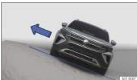
Fig. 141 Representación esquemática: bajar del vehículo siempre por el lado que mira a la cima.
