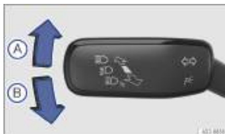
Fig. 105 En el lado izquierdo de la columna de dirección: palanca de los intermitentes y de la luz de carretera.
