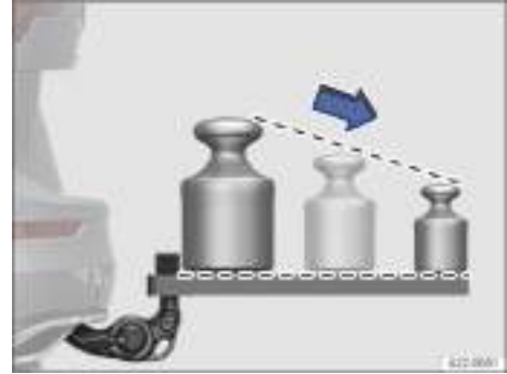
Fig. 206 Reparto recomendado del peso en el sistema portante trasero.
