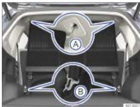
Fig. 196 En el maletero: montaje de la red de separación detrás del asiento trasero.
