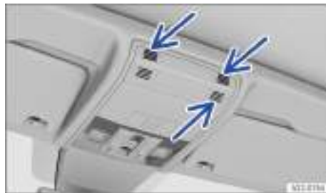
Fig. 62 En la consola del techo: sensores de la vigilancia del habitáculo (flechas).
