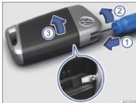
Fig. 51 Llave del vehículo: abrir la tapa del compartimento de la pila.
