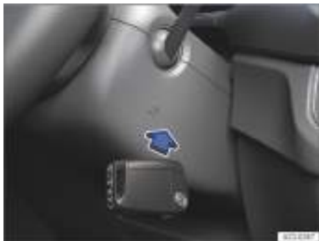
Fig. 127 En el lado derecho de la columna de dirección: función de arranque de emergencia en los vehículos con el sistema de cierre y arranque sin llave "Keyless Access".
