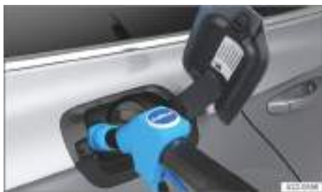
Fig. 217 Detrás de la tapa del depósito de combustible: repostar AdBlue con la pistola de un surtidor (representación esquemática).
