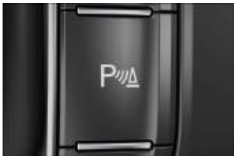
Fig. 164 En la consola central: tecla de la ayuda de aparcamiento.
