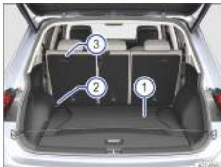
Fig. 199 En el maletero: red para equipajes enganchada a ras del piso.
