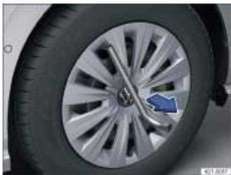
Fig. 262 Desmontar el tapacubos integral.
