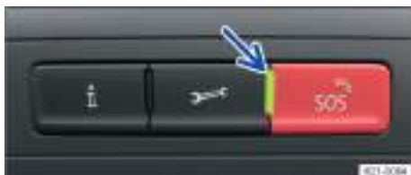
Fig. 46 En la consola del techo: mando para los servicios de voz y testigo de control.
