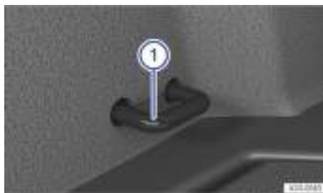
Fig. 197 En el maletero: argollas de amarre (representación esquemática).
