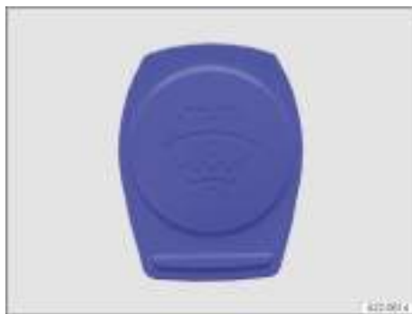
Fig. 243 En el vano delantero: tapa del depósito del líquido lavacrystales (representación esquemática).
