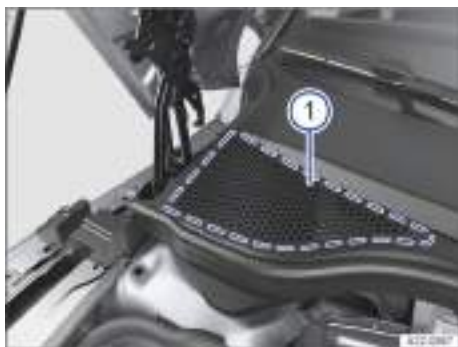
Fig. 276 Entre el vano delantero y el parabrisas: caja de aguas (representación esquemática).
