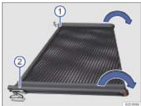
Fig. 194 Desplegar la red de separación.
