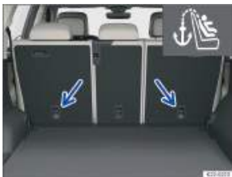
Fig. 43 En la parte posterior del asiento trasero: anclajes Top Tether para el cinturón de fijación superior Top Tether.
