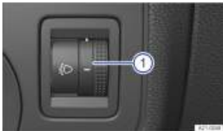
Fig. 106 Junto al volante: regulador del alcance de las luces.
