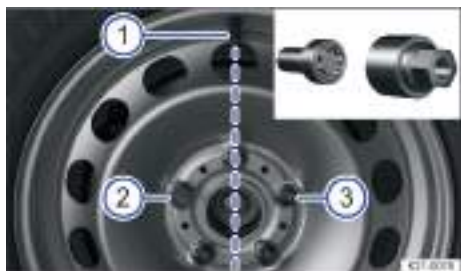
Fig. 269 Posición correcta del tornillo de rueda anti-robbo.
