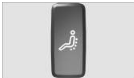
Fig. 99 En el lateral del asiento del conductor: tecla para la función de masaje.
