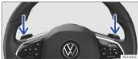
Fig. 132 Detrás del volante: levas de cambio para el Tiptronic.
