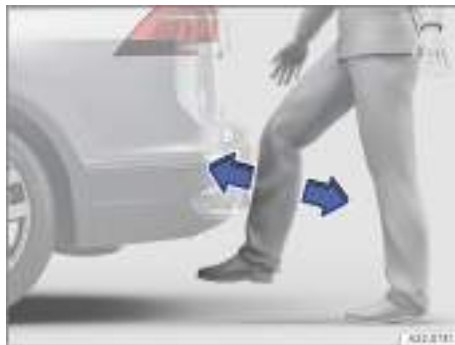
Fig. 68 Representación esquemática del portón trasero con cierre controlado por sensor (Easy Close).
