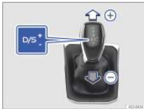
Fig. 131 En la consola central: palanca selectora en la posición Tiptronic.
