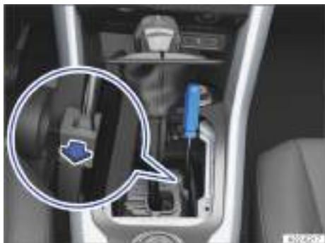
Fig. 134 En la consola central: realizar un desbloqueo de emergencia de la palanca selectora (variante 2).
