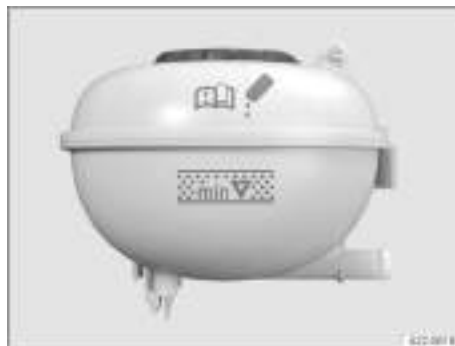
Fig. 249 En el vano delantero: marcas en el depósito de expansión del líquido refrigerante (representación esquemática).
