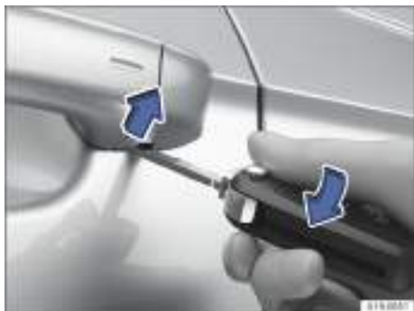
Fig. 59 Manilla de la puerta del conductor: desprender la caperuza haciendo palanca.
