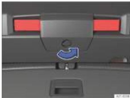
Fig. 69 En el portón trasero: abrir el soporte del triángulo de preseñalización.
