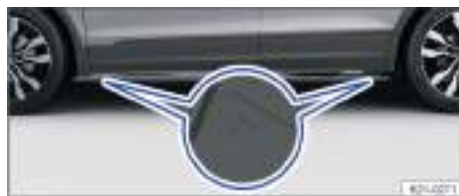
Fig. 265 En el larguero inferior: marcas para los puntos de alojamiento del gato.
