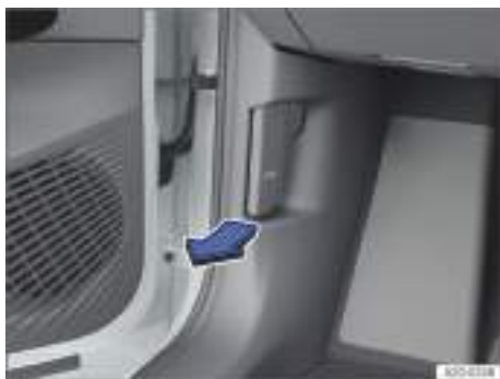
Fig. 240 En la zona reposapiés del lado del conductor: palanca de desbloqueo del capó delantero (representación esquemática).
