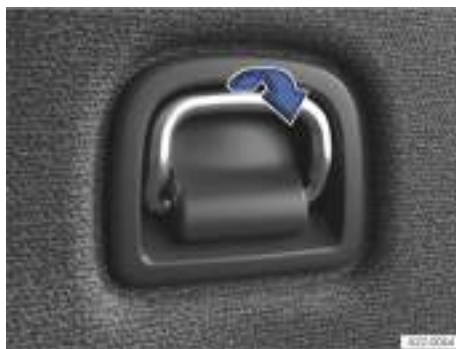
Fig. 198 En el maletero: argolla de amarre desplegable (representación esquemática).
