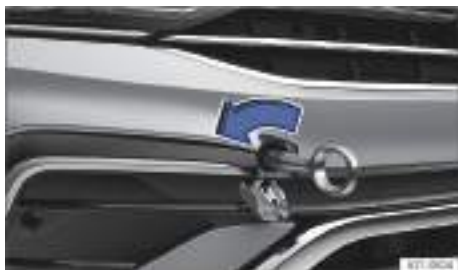
Fig. 235 En el lado derecho del paragolpes delantero: enroscar la argolla de remolque.
