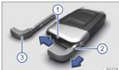
Fig. 49 Llave del vehículo: desbloqueo de la llave de emergencia (representación esquemática).
