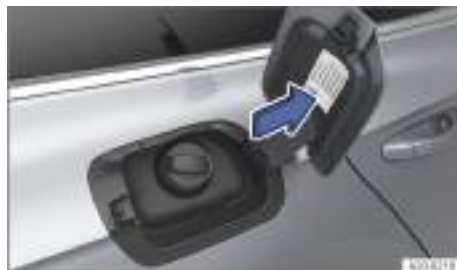
Fig. 208 En la cara interior de la tapa del depósito de combustible: adhesivo del combustible (representación esquemática).
