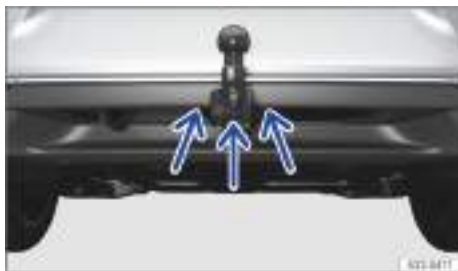
Fig. 203 En el dispositivo de remolque: argolla para fijar el cable de seguridad o el de ruptura (representación esquemática).
