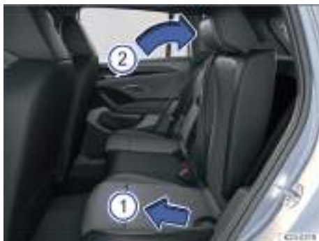
Fig. 81 Asiento trasero: ajustar el respaldo.
