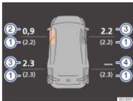
Fig. 258 Visualización en la pantalla del cuadro de instrumentos o del sistema de infotainment: presiones actuales de los neumáticos (representación esquemática).
