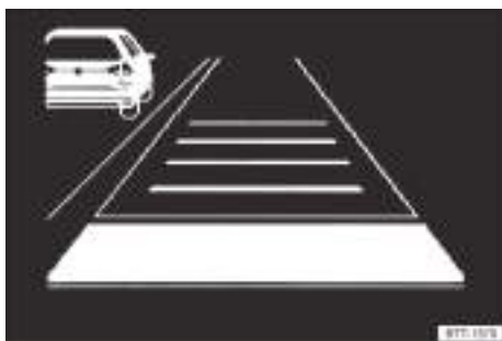
Fig. 151 En la pantalla del cuadro de instrumentos: vehículo detectado que circula más lentamente que el propio por el carril izquierdo (representación esquemática).
