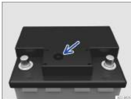
Fig. 251 En la parte superior de la batería de 12 voltios: mirilla (representación esquemática).
