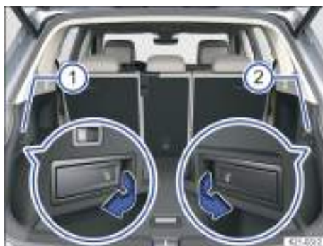
Fig. 83 En el maletero: palancas de desbloqueo a distancia de la parte izquierda ① y la parte derecha ② del respaldo del asiento trasero.
