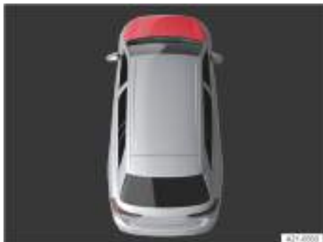
Fig. 242 En la pantalla del cuadro de instrumentos: capó delantero abierto o no cerrado correctamente (representación esquemática).
