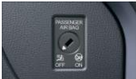
Fig. 36 En el tablero de instrumentos, en el lado del acompañante: conmutador de llave para desactivar y activar el airbag frontal del acompañante.
