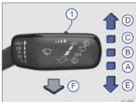
Fig. 108 En el lado derecho de la columna de dirección: manejo del limpiaparabrisas.
