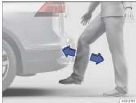
Fig. 67 Representación esquemática del portón trasero con apertura controlada por sensor (Easy Open).
