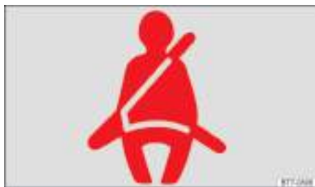
Fig. 29 En la pantalla del cuadro de instrumentos: testigo de advertencia del recordatorio de abrocharse el cinturón de seguridad.
