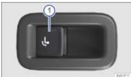
Fig. 204 En el lado derecho del maletero: tecla para desbloquear el enganche para remolque.
