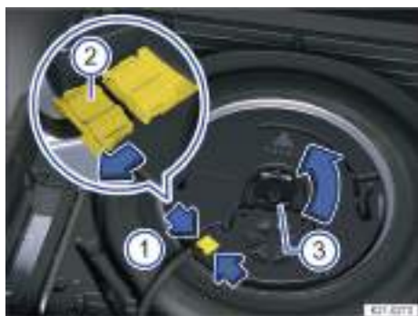
Fig. 259 Debajo del piso del maletero: desmontar el subwoofer (variante 1).
