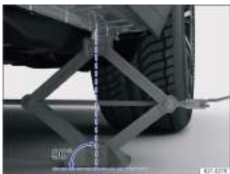
Fig. 267 En el lado izquierdo del vehículo, en la zona trasera: gato colocado.
