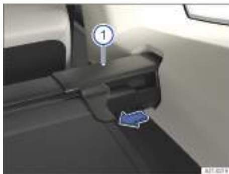
Fig. 190 En el maletero: desmontar la cubierta del maletero.
