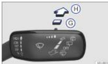
Fig. 109 En el lado derecho de la columna de dirección: manejo del limpiacristales.
