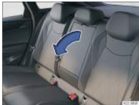
Fig. 179 En el respaldo de la plaza central del asiento: reposabrazos central trasero abatible (representación esquemática).
