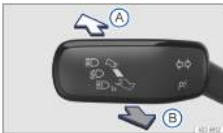
Fig. 103 En el lado izquierdo de la columna de dirección: palanca de los intermitentes y de la luz de carretera.
