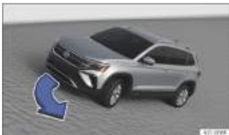
Fig. 140 Representación esquemática: girar hacia la línea de caída.
