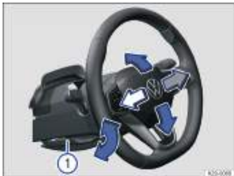
Fig. 72 Debajo del volante, en el guarnecido de la columna de dirección: palanca para el ajuste manual de la posición del volante (representación esquemática).
