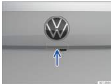
Fig. 63 En el portón trasero: pulsador para abrir el portón (representación esquemática).
