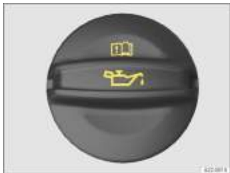
Fig. 246 En el vano delantero: tapa de la boca de llenado de aceite del motor (representación esquemática).
