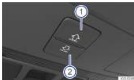
Fig. 115 En el revestimiento interior del techo: teclas para manejar la cortinilla parasol.
