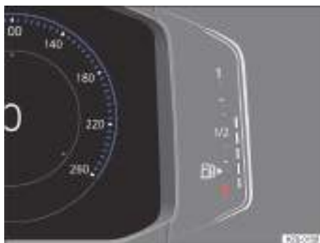
Fig. 18 En el cuadro de instrumentos digital Pro: indicador del nivel de combustible (representación esquemática).
