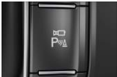
Fig. 168 En la consola central: tecla para conectar y desconectar el sistema de visión periférica.
