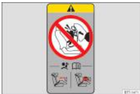
Fig. 41 En el pilar B: etiqueta adhesiva relativa al airbag (representación esquemática).
