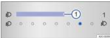
Fig. 107 En el sistema de infotainment: regulador táctil para la regulación del alcance de las luces.
