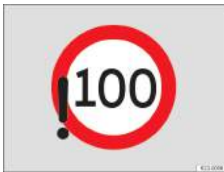
Fig. 27 En la pantalla del cuadro de instrumentos: detección de limitación de velocidad excedida (representación esquemática).
