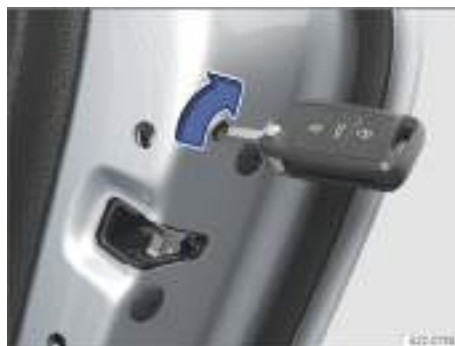
Fig. 60 En el frontal de la puerta trasera derecha: bloqueo de emergencia del vehículo con la llave de este (representación esquemática).
