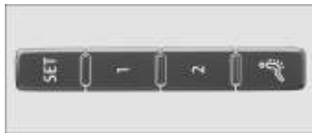
Fig. 98 En el lateral exterior del asiento del conductor: teclas de memoria.
