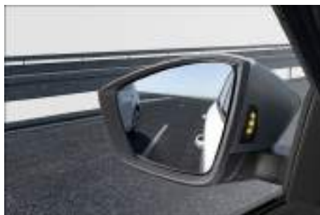
Fig. 160 En las carcasas de los retrovisores exteriores: indicaciones del Side Assist.
