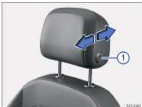
Fig. 87 Ajuste de los apoyacabezas delanteros con posibilidad de ajuste longitudinal (representación esquemática).
