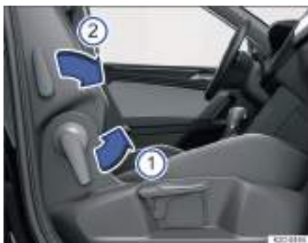
Fig. 79 Asiento del acompañante: abatir el respaldo hacia delante.
