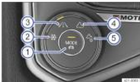
Fig. 136 En la consola central: mando giratorio del 4MOTION Active Control.
