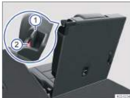
Fig. 84 Tercera fila de asientos: colocar el asiento en posición de piso de carga.
