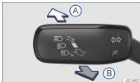
Fig. 104 En el lado izquierdo de la columna de dirección: palanca de los intermitentes y de la luz de carretera.
