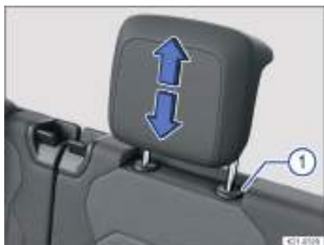
Fig. 91 Desmontaje de los apoyacabezas de la segunda fila (representación esquemática).
