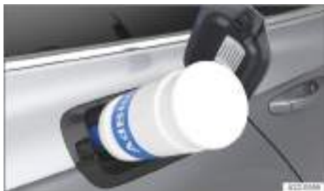
Fig. 216 Detrás de la tapa del depósito de combustible: repostar AdBlue con una botella de recarga (representación esquemática).
