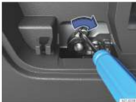
Fig. 70 En el portón trasero: desbloqueo de emergencia del portón.
