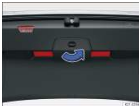
Fig. 45 En el portón trasero: soporte del triángulo de preseñalización.
