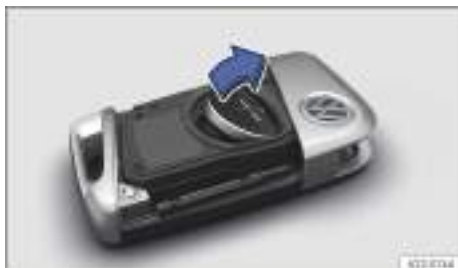
Fig. 52 Llave del vehículo: cambiar la pila de botón.
