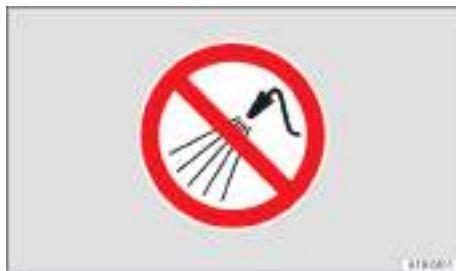
Fig. 275 En el vano delantero: no utilizar ningún equipo de limpieza de alta presión.
