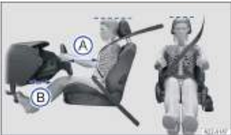
Fig. 28 Distancia correcta entre el conductor y el volante, colocación correcta de la banda del cinturón y ajuste correcto del apoyacabezas (representación esquemática).
