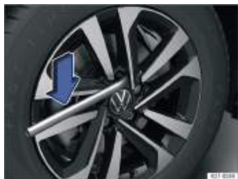
Fig. 264 Aflojar los tornillos de rueda.
