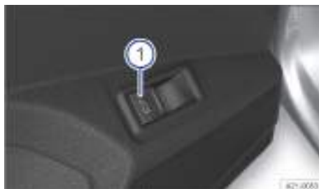
Fig. 58 En la puerta del conductor: tecla para la apertura eléctrica del portón trasero (representación esquemática).
