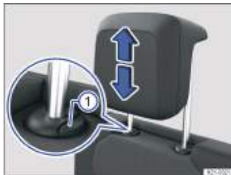
Fig. 92 Desmontaje de los apoyacabezas de la tercera fila (representación esquemática).
