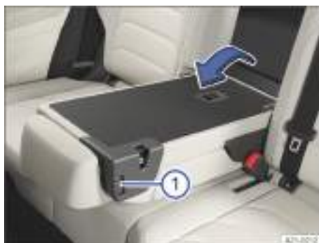
Fig. 201 En el respaldo del asiento trasero: apertura de la trampilla para cargas largas.
