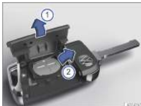
Fig. 50 Llave del vehículo: cambiar la pila de botón (representación esquemática).
