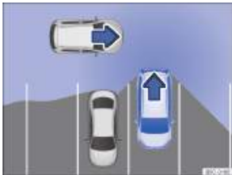
Fig. 176 Zona vigilada alrededor del vehículo que está desaparcando (representación esquemática).
