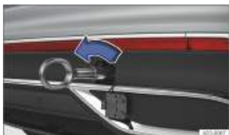
Fig. 238 En el lado derecho del paragolpes trasero: enroscar la argolla de remolque, variante 1.
