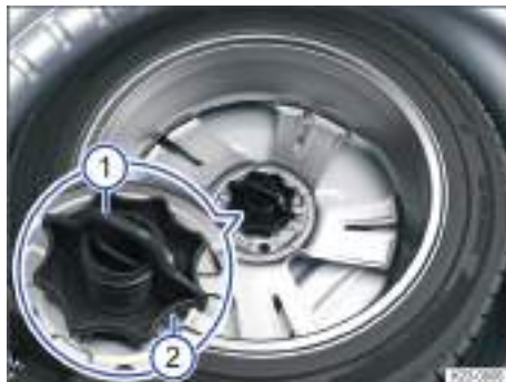
Fig. 261 Debajo del piso del maletero: ruedecilla para fijar la rueda de repuesto.
