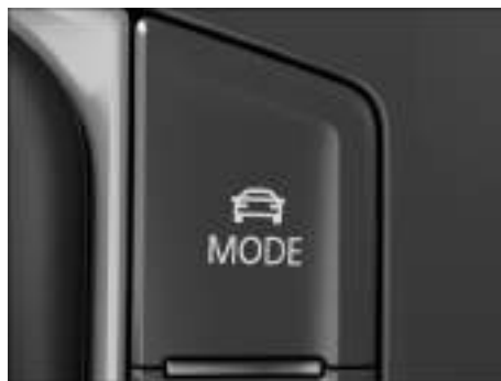
Fig. 135 En la consola central: tecla MODE para seleccionar los perfiles de conducción.
