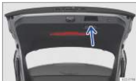
Fig. 64 En el portón trasero abierto: asidero para cerrar el portón (representación esquemática).
