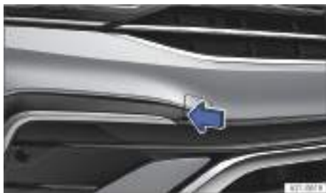
Fig. 234 En el lado derecho del paragolpes delantero: retirar la tapa.
