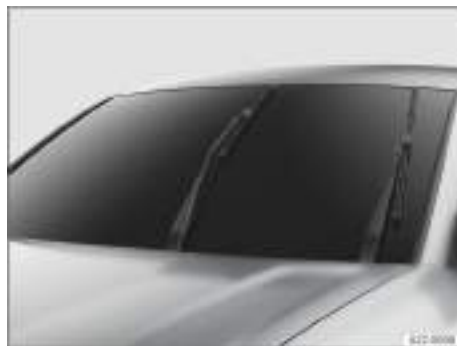
Fig. 221 Limpiacristales en posición de servicio (representación esquemática).
