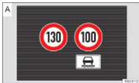
Fig. 26 En la pantalla del cuadro de instrumentos: indicaciones del sistema de detección de señales de tráfico con panel complementario detectado (representación esquemática).
