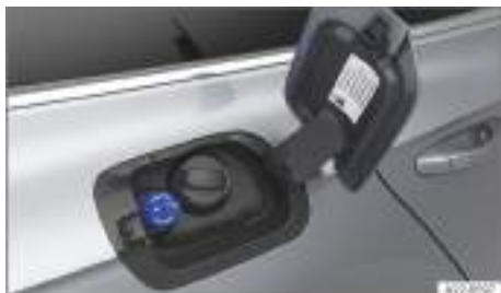
Fig. 215 Detrás de la tapa del depósito de combustible: tapón del depósito de AdBlue (representación esquemática).
