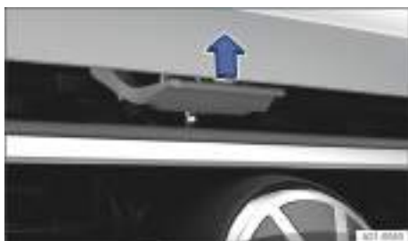
Fig. 241 Encima de la parrilla del radiador: palanca de accionamiento del capó delantero.
