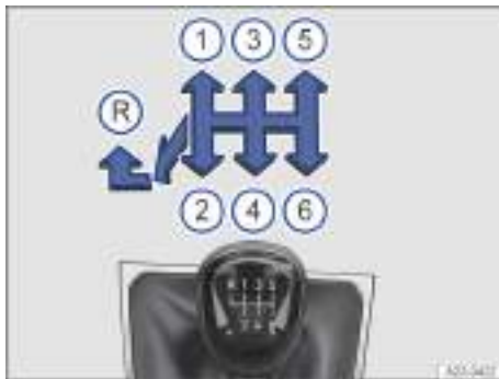
Fig. 129 Esquema de las marchas de un cambio manual de 6 marchas.
