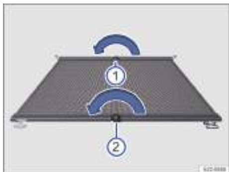
Fig. 195 Plegar la red de separación.
