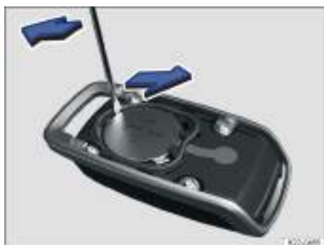
Fig. 122 Sustituir la pila de botón del mando a distancia por radiofrecuencia.
