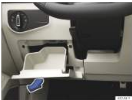
Fig. 227 Junto al volante, en el lado izquierdo: tapa de la caja de fusibles del tablero de instrumentos (vehículos con el volante a la izquierda).
