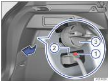
Fig. 224 Lateral del maletero: desmontar el grupo óptico trasero.
