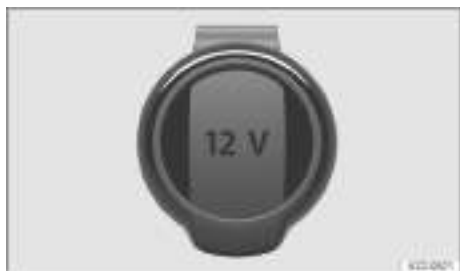
Fig. 182 En el portaobjetos de la parte delantera de la consola central, en la parte trasera de esta o en el lado izquierdo del maletero: toma de corriente de 12 voltios con tapa plegable (representación esquemática).
