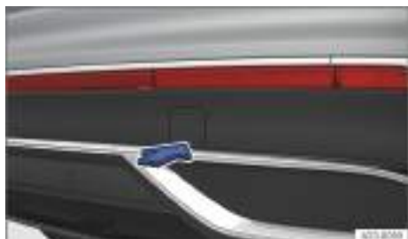
Fig. 236 En el lado derecho del paragolpes trasero: retirar la tapa, variante 1.
