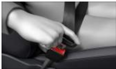
Fig. 30 Insertar la lengüeta del cinturón de seguridad en su cierre (representación esquemática).
