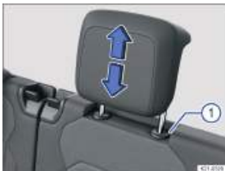
Fig. 88 Ajuste de los apoyacabezas de la segunda fila de asientos (representación esquemática).
