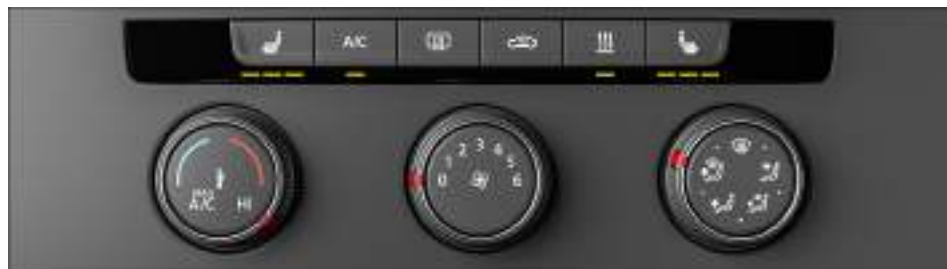
Fig. 119 En la parte superior de la consola central: panel de mandos del climatizador manual.
