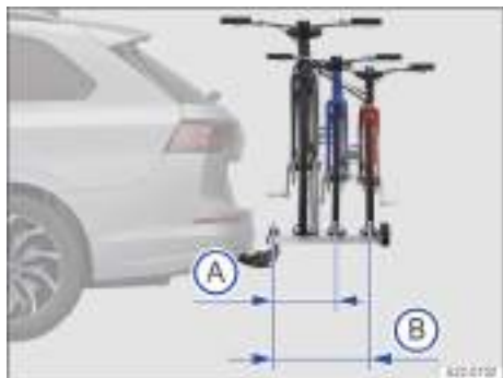
Fig. 207 Representación esquemática del voladizo máximo de la carga en un portabicicletas para dos o tres bicicletas.
