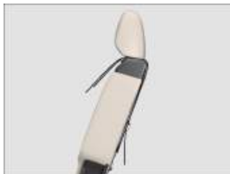
Fig. 44 En la parte posterior del asiento trasero: cinturón de fijación superior Top Tether enganchado.
