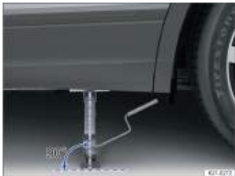
Fig. 266 Alineación correcta del gato.
