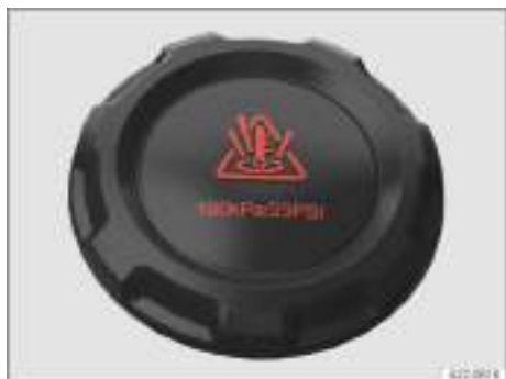
Fig. 248 En el vano delantero: tapa del depósito de expansión del líquido refrigerante (representación esquemática).
