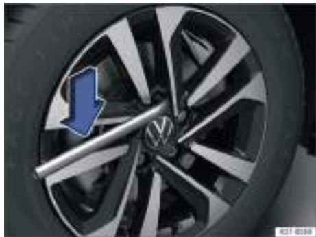
Fig. 268 Desenroscar los tornillos de rueda con la llave de rueda.
