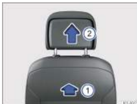
Fig. 90 Desmontaje de los apoyacabezas delanteros (representación esquemática).
