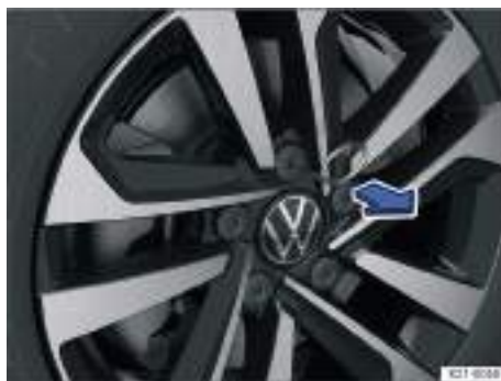
Fig. 263 Retirar las caperuzas de los tornillos de rueda.
