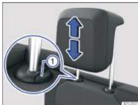
Fig. 89 Ajuste de los apoyacabezas de la tercera fila de asientos (representación esquemática).
