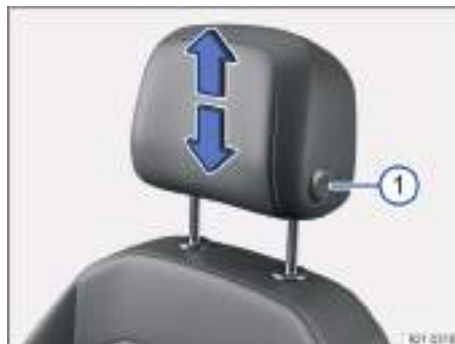
Fig. 86 Ajuste de la altura de los apoyacabezas delanteros sin posibilidad de ajuste longitudinal (representación esquemática).
