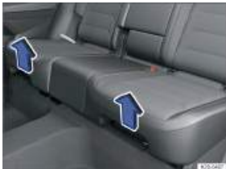
Fig. 80 Debajo de la banqueta del asiento trasero: palanca de ajuste (representación esquemática).
