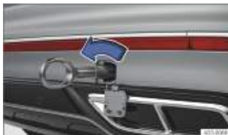
Fig. 239 En el lado derecho del paragolpes trasero: enroscar la argolla de remolque, variante 2.
