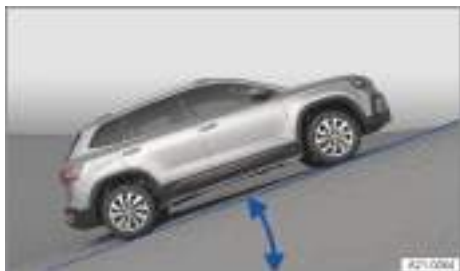
Fig. 138 Representación esquemática: ángulo de pendiente.
