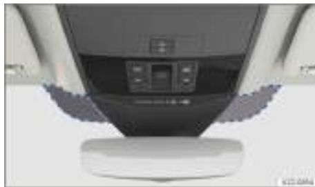
Fig. 116 Junto a la base del retrovisor: ventana de comunicación (representación esquemática).
