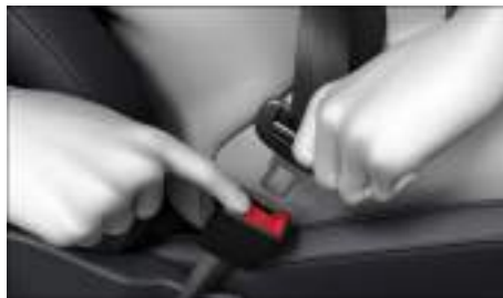
Fig. 31 Soltar la lengüeta del cierre del cinturón (representación esquemática).
