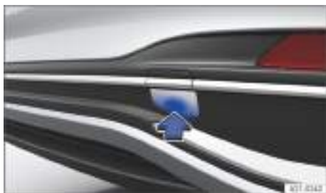
Fig. 162 En el lado derecho del paragolpes trasero: retirar la tapa.
