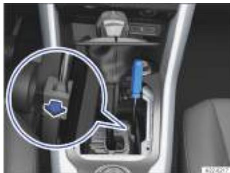
Fig. 102 En la consola central: realizar un desbloqueo de emergencia de la palanca selectora (variante 2).
