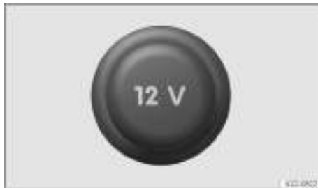
Fig. 132 En la parte delantera de la consola central: toma de corriente de 12 voltios con tapa extraíble (representación esquemática).
