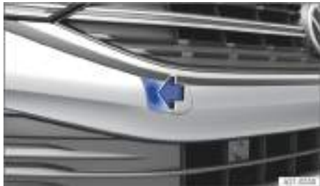
Fig. 158 En el lado derecho del paragolpes delantero: retirar la tapa, variante 1.
