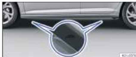
Fig. 192 En el larguero inferior: marcas para los puntos de apoyo del gato (variante 2).
