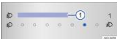
Fig. 82 En el sistema de infotainment: regulador táctil para la regulación del alcance de las luces.
