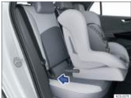
Fig. 38 Montaje de un asiento para niños con conectores (representación esquemática).
