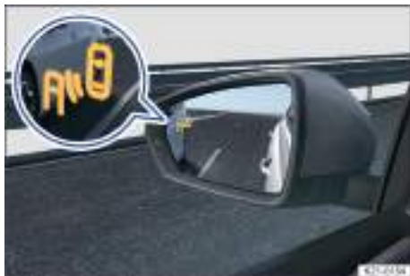
Fig. 121 En los espejos de los retrovisores exteriores: indicación del detector de ángulo muerto.
