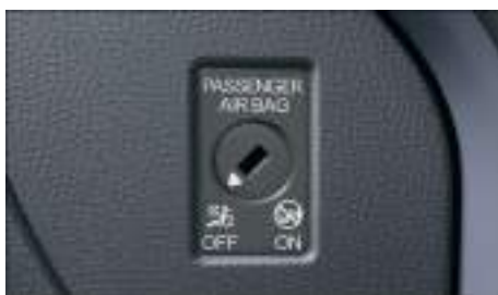
Fig. 32 En el tablero de instrumentos, en el lado del acompañante: conmutador de llave para desactivar y activar el airbag frontal del acompañante.
