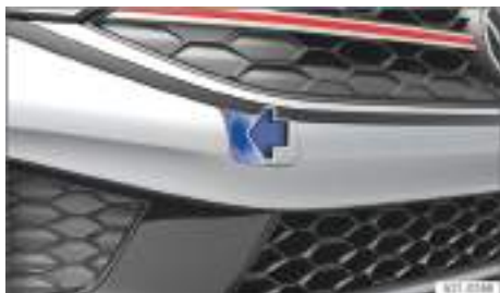
Fig. 159 En el lado derecho del paragolpes delantero: retirar la tapa, variante 2.
