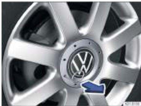
Fig. 187 Desmontar el tapacubos central tirando de él.
