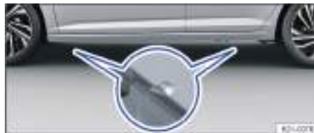
Fig. 191 En el larguero inferior: marcas para los puntos de apoyo del gato (variante 1).
