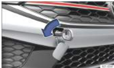
Fig. 161 En el lado derecho del paragolpes delantero: enroscar la argolla de remolque, variante 2.
