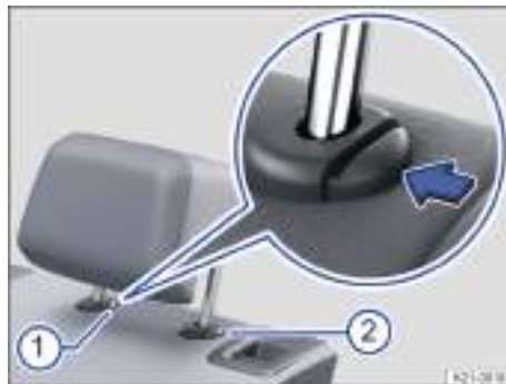
Fig. 71 Desmontaje de los apoyacabezas traseros (representación esquemática).
