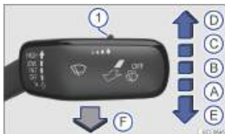
Fig. 83 En el lado derecho de la columna de dirección: manejo del limpiaparabrisas.
