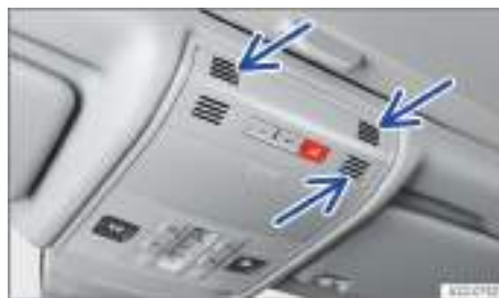
Fig. 56 En la consola del techo: sensores de la vigilancia del habitáculo (flechas).
