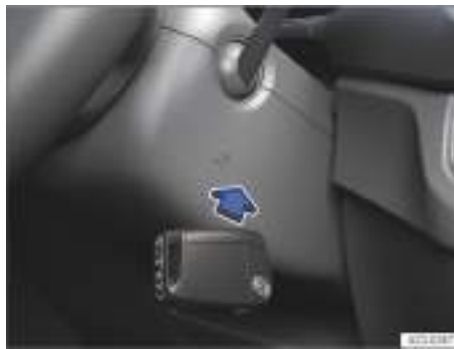
Fig. 95 En el lado derecho de la columna de dirección: función de arranque de emergencia en los vehículos con el sistema de cierre y arranque sin llave "Keyless Access".
