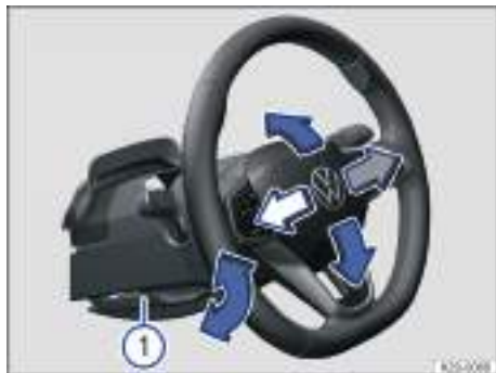
Fig. 61 Debajo del volante, en el guarnecido de la columna de dirección: palanca para el ajuste manual de la posición del volante (representación esquemática).
