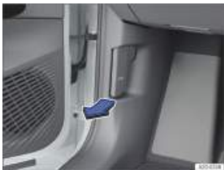
Fig. 166 En la zona reposapiés del lado del conductor: palanca de desbloqueo del capó delantero (representación esquemática).
