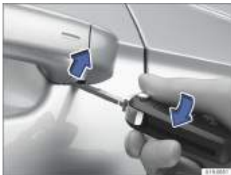
Fig. 53 Manilla de la puerta del conductor: desprender la caperuza haciendo palanca.
