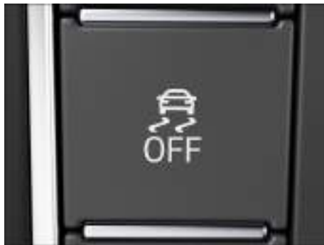
Fig. 129 En la consola central: tecla para conectar y desconectar manualmente el ASR o el ESC Sport (en función del equipamiento).
