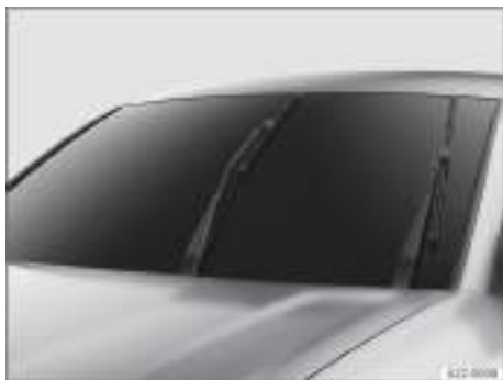
Fig. 147 Limpiacristales en posición de servicio (representación esquemática).
