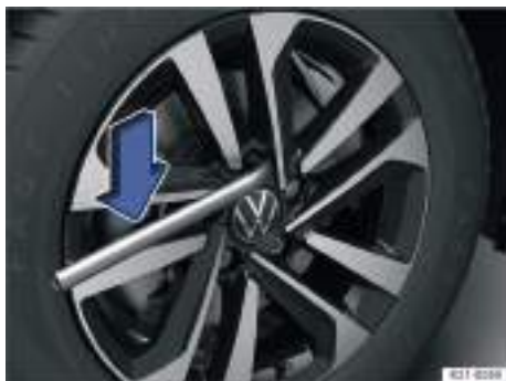
Fig. 190 Aflojar los tornillos de rueda.
