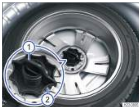
Fig. 186 Debajo del piso del maletero: ruedecilla para fijar la rueda de repuesto.
