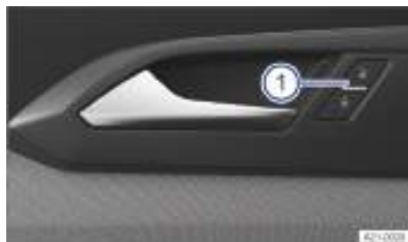
Fig. 52 En la puerta del conductor: tecla del cierre centralizado (representación esquemática).
