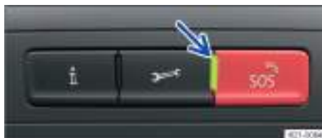
Fig. 43 En la consola del techo: mando para los servicios de voz y testigo de control.
