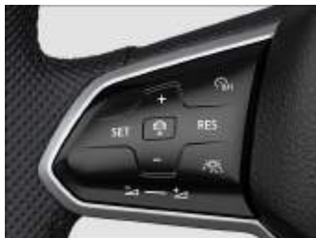
Fig. 120 Lado izquierdo del volante multifunción (variante 2).
