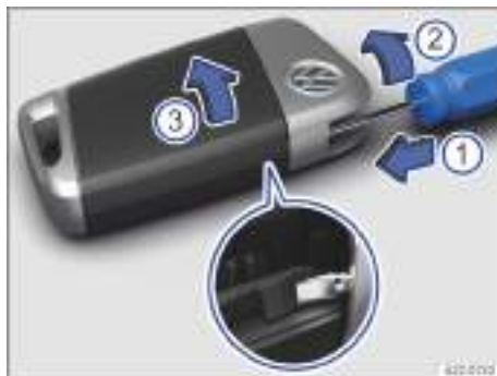
Fig. 48 Llave del vehículo: abrir la tapa del compartimento de la pila.
