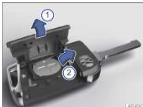
Fig. 47 Llave del vehículo: cambiar la pila de botón (representación esquemática).
