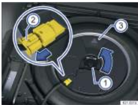
Fig. 185 Debajo del piso del maletero: desmontar el subwoofer.
