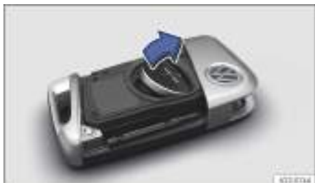
Fig. 49 Llave del vehículo: cambiar la pila de botón.
