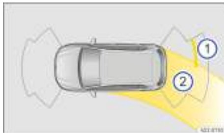
Fig. 124 Sistema de infotainment: visualización de la ayuda de aparcamiento (representación esquemática).
