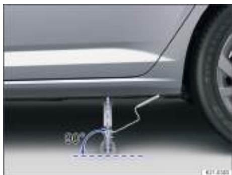
Fig. 195 Alineación correcta del gato (variante 2).
