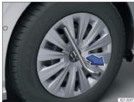
Fig. 188 Desmontar el tapacubos integral.
