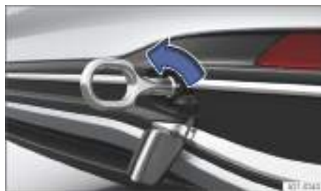
Fig. 163 En el lado derecho del paragolpes trasero: enroscar la argolla de remolque.
