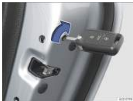
Fig. 54 En el frontal de la puerta trasera derecha: bloqueo de emergencia del vehículo con la llave de este (representación esquemática).
