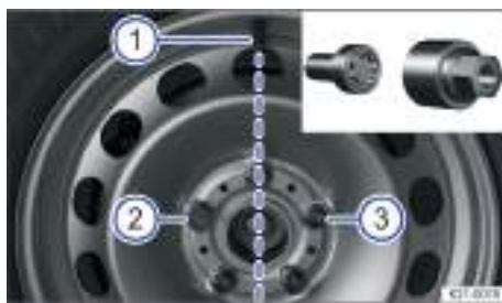
Fig. 198 Posición correcta del tornillo de rueda anti-robbo.
