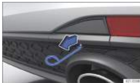
Fig. 164 En el lado derecho del paragolpes trasero: retirar la tapa.
