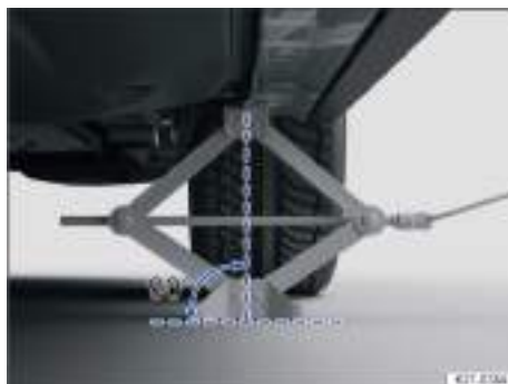
Fig. 196 En el lado izquierdo del vehículo, en la zona trasera: gato colocado (variante 2).
