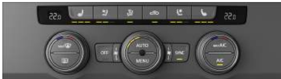
Fig. 89 En la parte superior de la consola central: panel de mandos del Climatronic.
