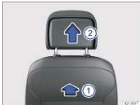
Fig. 70 Desmontaje de los apoyacabezas delanteros (representación esquemática).
