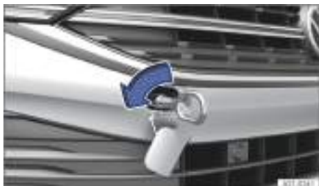
Fig. 160 En el lado derecho del paragolpes delantero: enroscar la argolla de remolque, variante 1.
