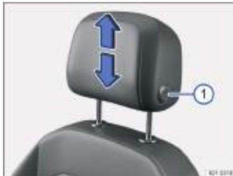
Fig. 68 Desmontaje de los apoyacabezas delanteros (representación esquemática).
