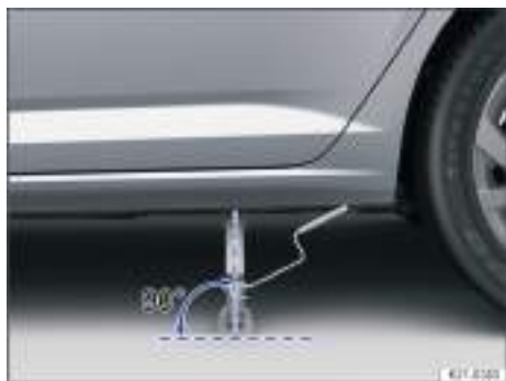
Fig. 193 Alineación correcta del gato (variante 1).
