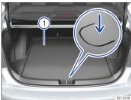
Fig. 137 En el maletero: abrir el piso del maletero.
