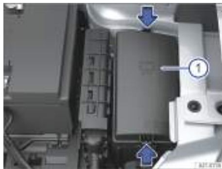
Fig. 150 En el vano delantero: caja de fusibles.
