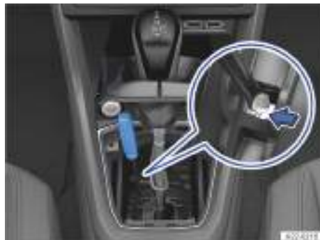
Fig. 101 En la consola central: realizar un desbloqueo de emergencia de la palanca selectora (variante 1).
