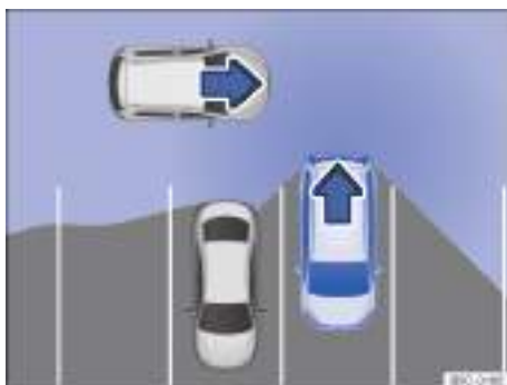
Fig. 127 Zona vigilada alrededor del vehículo que está desaparcando (representación esquemática).
