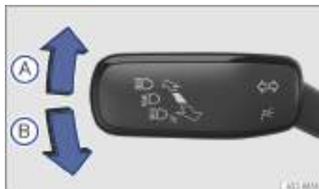
Fig. 81 En el lado izquierdo de la columna de dirección: palanca de los intermitentes y de la luz de carretera.
