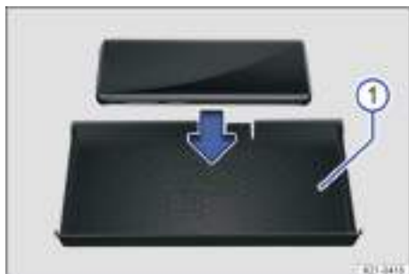
Fig. 133 En la consola central: estera para la función de carga inalámbrica (representación esquemática).
