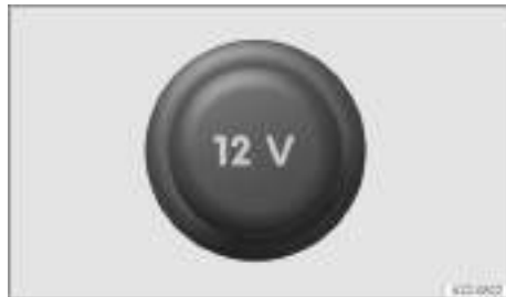
Fig. 134 En la parte inferior de la consola central: toma de corriente de 12 voltios con tapa extraíble (representación esquemática).
