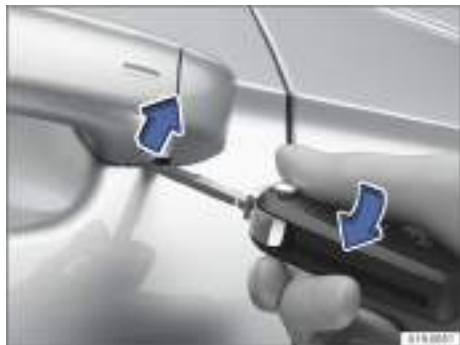
Fig. 52 Manilla de la puerta del conductor: desprender la caperuza haciendo palanca.
