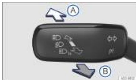
Fig. 79 En el lado izquierdo de la columna de dirección: palanca de los intermitentes y de la luz de carretera.
