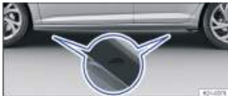
Fig. 194 En el larguero inferior: marcas para los puntos de apoyo del gato (variante 2).
