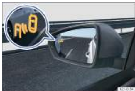
Fig. 123 En los espejos de los retrovisores exteriores: indicación del detector de ángulo muerto.
