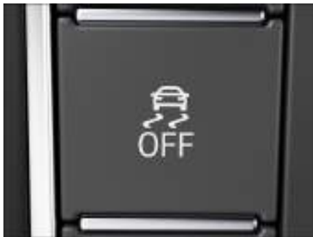
Fig. 102 En la consola central: tecla para conectar y desconectar manualmente el ASR o el ESC Sport (en función del equipamiento).
