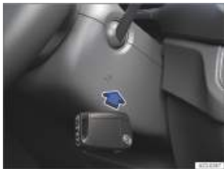
Fig. 94 En el lado derecho de la columna de dirección: función de arranque de emergencia en los vehículos con el sistema de cierre y arranque sin llave "Keyless Access" (representación esquemática).
