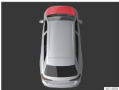
Fig. 172 En la pantalla del cuadro de instrumentos: capó delantero abierto o no cerrado correctamente (representación esquemática).
