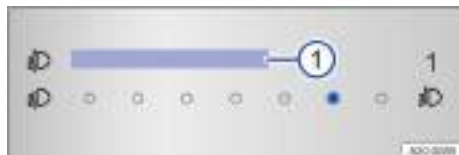
Fig. 81 En el sistema de infotainment: regulador táctil para la regulación del alcance de las luces.
