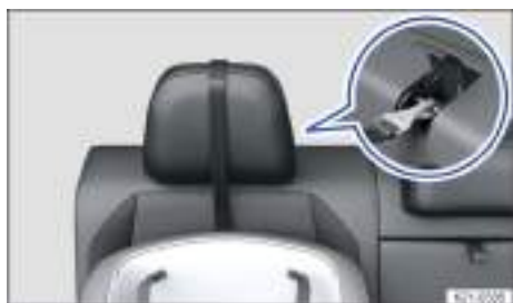
Fig. 40 En el respaldo del asiento trasero: colocación de la banda del cinturón de fijación superior (Top Tether) simple si los apoyacabezas no se pueden ajustar.
