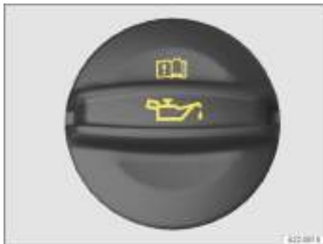
Fig. 176 En el vano delantero: tapa de la boca de llenado del aceite del motor (representación esquemática).
