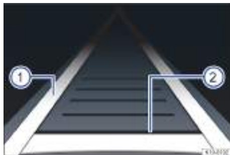
Fig. 120 En la pantalla del cuadro de instrumentos: visualización con la regulación activa.
