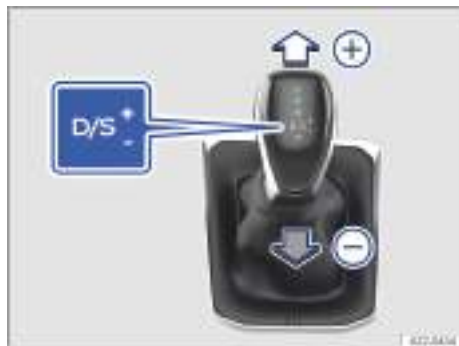
Fig. 98 En la consola central: palanca selectora en la posición Tiptronic.
