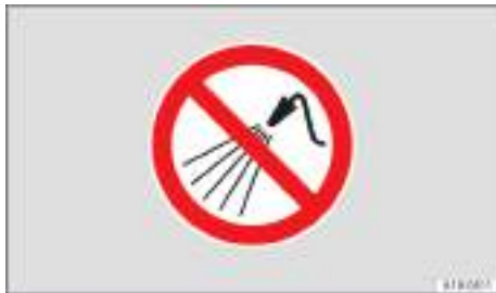
Fig. 208 En el vano delantero: no utilizar ningún equipo de limpieza de alta presión.
