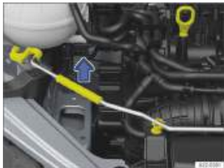
Fig. 170 En el vano delantero: varilla de sujeción del capó en su soporte (representación esquemática).
