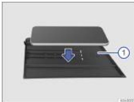
Fig. 135 En la consola central: estera permeable al aire para la función de carga inalámbrica (representación esquemática).
