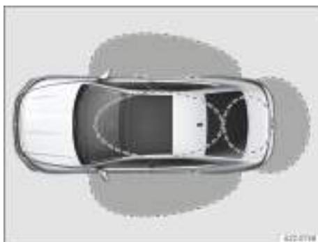
Fig. 49 Sistema "Keyless Access": zonas de proximidad.
