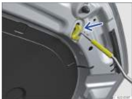
Fig. 171 En el capó delantero: alojamiento de la varilla de sujeción del capó (representación esquemática).
