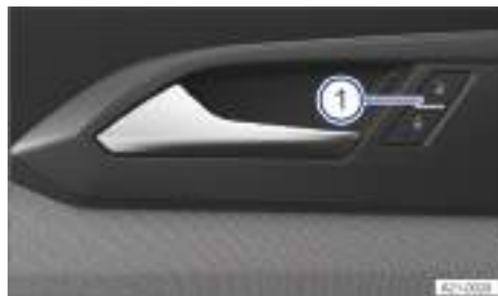
Fig. 51 En la puerta del conductor: tecla del cierre centralizado (representación esquemática).
