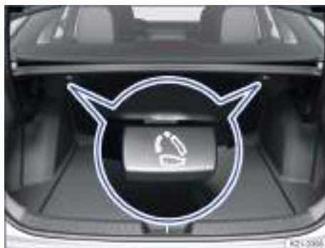
Fig. 65 En el maletero: palanca de desbloqueo desde el maletero.
