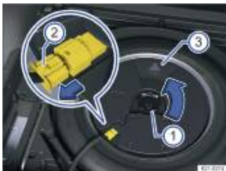
Fig. 188 Debajo del piso del maletero: desmontar el subwoofer.
