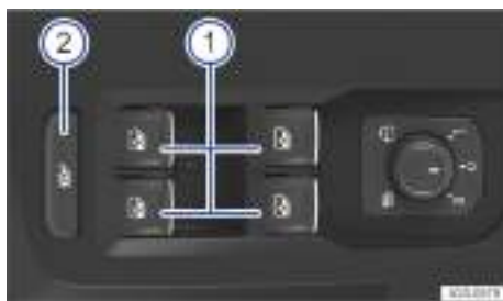
Fig. 58 En la puerta del conductor: teclas de los elevavinas.
