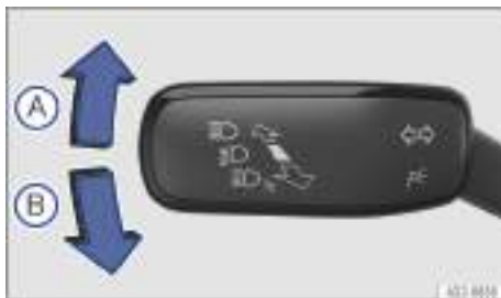
Fig. 80 En el lado izquierdo de la columna de dirección: palanca de los intermitentes y de la luz de carretera.
