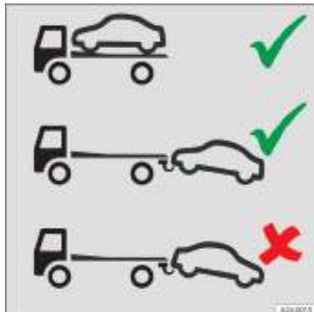
Fig. 160 Transportar con una grúa.
