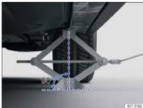
Fig. 198 En el lado izquierdo del vehículo, en la zona trasera: gato colocado (variante 2).
