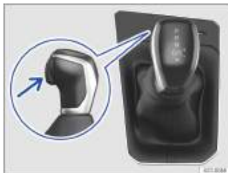
Fig. 97 En la consola central: palanca selectora del cambio automático (representación esquemática).
