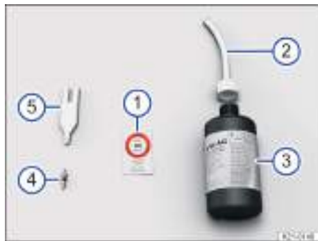
Fig. 201 Componentes del kit reparapinchazos (representación esquemática).
