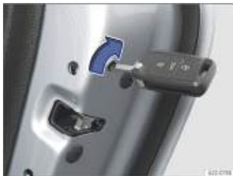
Fig. 53 En el frontal de la puerta trasera derecha: bloqueo de emergencia del vehículo con la llave de este (representación esquemática).
