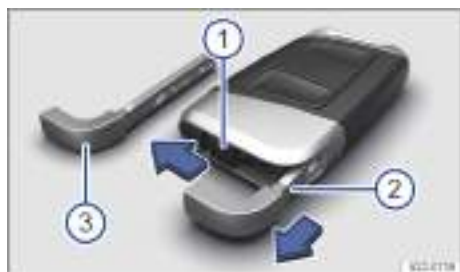
Fig. 45 Llave del vehículo: desbloqueo de la llave de emergencia (representación esquemática).
