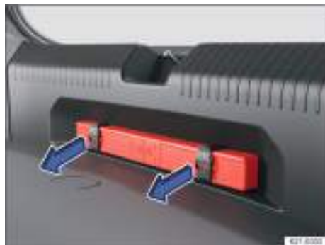
Fig. 42 Debajo del umbral de carga: soporte del triángulo de preseñalización.
