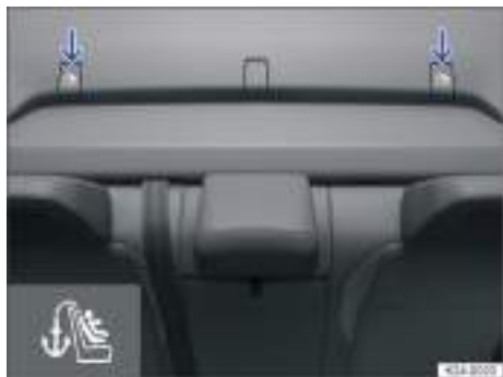
Fig. 39 En la bandeja situada detrás de los asientos traseros: anclajes Top Tether para el cinturón de fijación superior (Top Tether).
