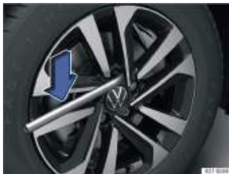
Fig. 199 Desenroscar los tornillos de rueda con la llave de rueda.
