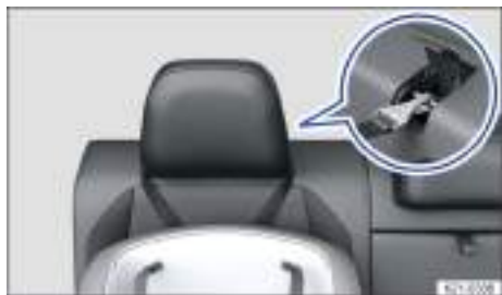
Fig. 41 En el respaldo del asiento trasero: colocación de la banda del cinturón de fijación superior (Top Tether) en forma de V si los apoyacabezas no se pueden ajustar.
