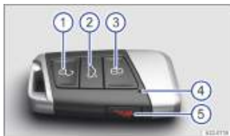
Fig. 44 Llave del vehículo sin paletón.
