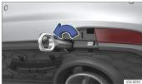
Fig. 168 En el lado derecho del paragolpes trasero: enroscar la argolla de remolque.
