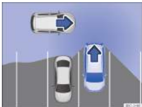
Fig. 129 Zona vigilada alrededor del vehículo que está desaparcando (representación esquemática).
