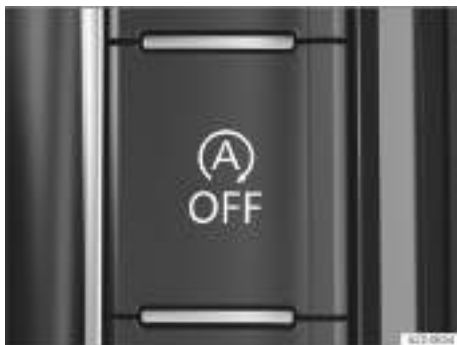
Fig. 95 En la parte inferior de la consola central o, en función del equipamiento, en el sistema de infotainment: tecla del sistema Start-Stop.
