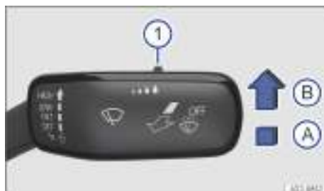
Fig. 83 En el lado derecho de la columna de dirección: palanca del limpiacristales.
