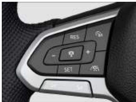
Fig. 116 Lado izquierdo del volante multifunción (variante 1).
