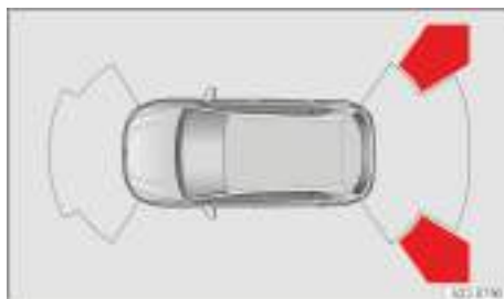
Fig. 130 Sistema de infotainment: visualización del asistente de salida del aparcamiento con sensores traseros y delanteros (en función del equipamiento).
