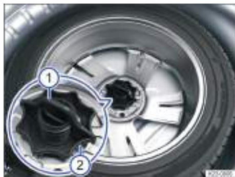
Fig. 189 Debajo del piso del maletero: ruedecilla para fijar la rueda de repuesto.
