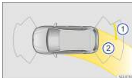
Fig. 126 Sistema de infotainment: visualización de la ayuda de aparcamiento con sensores traseros y delanteros (representación esquemática).
