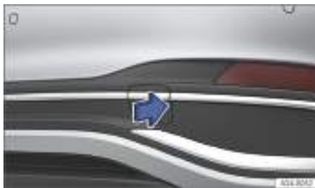
Fig. 165 En el lado derecho del paragolpes trasero: retirar la tapa.
