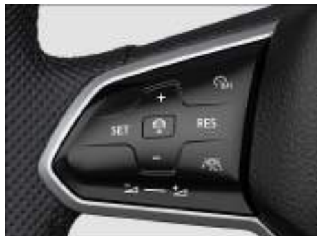
Fig. 111 Lado izquierdo del volante multifunción (variante 2).
