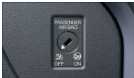
Fig. 31 En el tablero de instrumentos, en el lado del acompañante: conmutador de llave para desactivar y activar el airbag frontal del acompañante.
