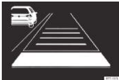
Fig. 114 En la pantalla del cuadro de instrumentos: vehículo detectado que circula más lentamente que el propio por el carril izquierdo (representación esquemática).
