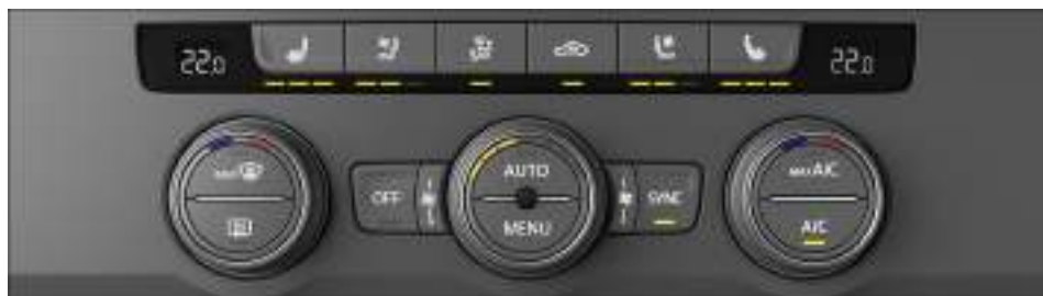
Fig. 89 En la parte superior de la consola central: panel de mandos del Climatronic (variante 2).
