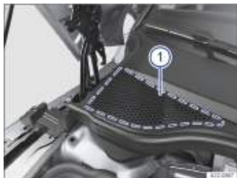
Fig. 209 Entre el vano delantero y el parabrisas: caja de aguas (representación esquemática).
