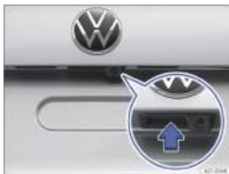
Fig. 57 En el portón trasero: pulsador para abrir el portón.
