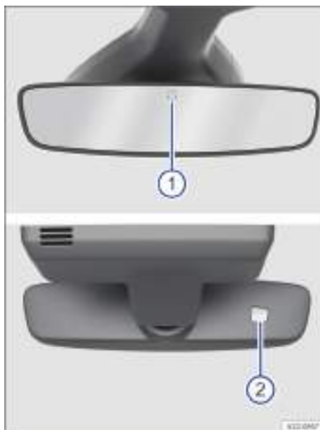
Fig. 84 En el parabrisas: retrovisor interior antideslumbrante automático.
