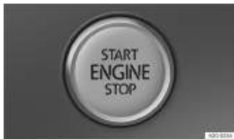
Fig. 93 En la parte inferior de la consola central: pulsador de encendido y arranque.
