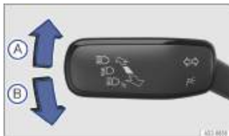
Fig. 76 En el lado izquierdo de la columna de dirección: palanca de los intermitentes y de la luz de carretera.
