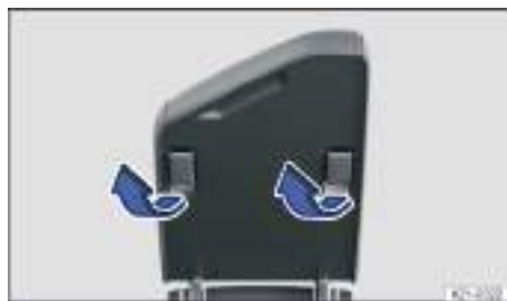
Fig. 72 Parte inferior del reposabrazos central delantero: apoyos de plástico del reposabrazos.
