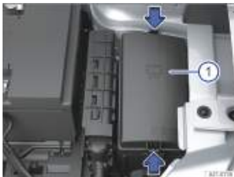
Fig. 152 En el vano delantero: caja de fusibles (representación esquemática).
