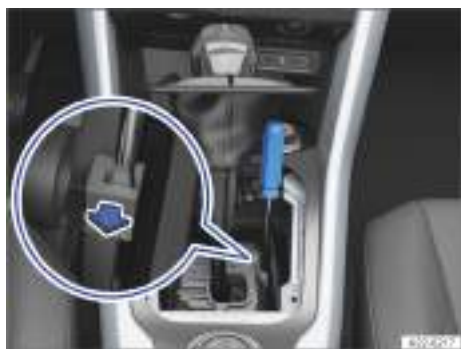
Fig. 101 En la consola central: realizar un desbloqueo de emergencia de la palanca selectora (variante 2).
