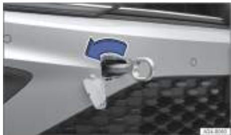
Fig. 163 En el lado derecho del paragolpes delantero: enroscar la argolla de remolque, variante 1.
