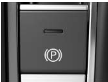
Fig. 124 En la consola central: tecla del freno de estacionamiento electrónico.
