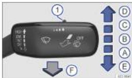
Fig. 82 En el lado derecho de la columna de dirección: manejo del limpiaparabrisas.
