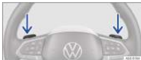
Fig. 99 Detrás del volante: levas de cambio para el Tiptronic (representación esquemática).
