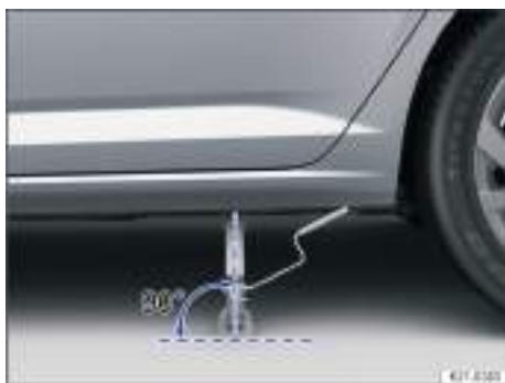
Fig. 195 Alineación correcta del gato (variante 1).
