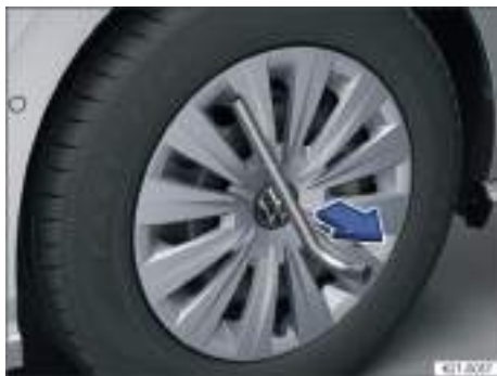
Fig. 190 Desmontar el tapacubos integral.
