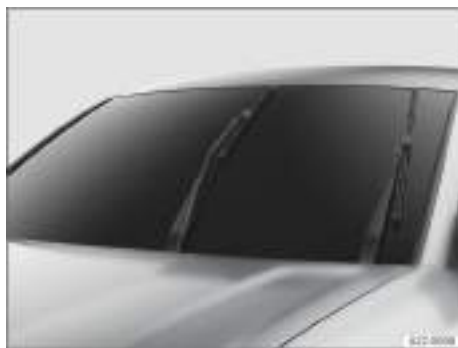
Fig. 149 Limpiacristales en posición de servicio (representación esquemática).
