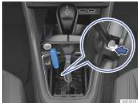
Fig. 100 En la consola central: realizar un desbloqueo de emergencia de la palanca selectora (variante 1).
