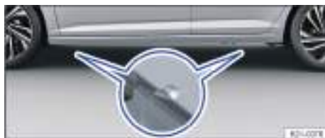
Fig. 193 En el larguero inferior: marcas para los puntos de apoyo del gato (variante 1).
