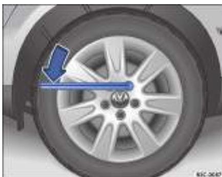
**Fig. 195** Cambio de rueda: aflojar los tornillos de rueda.
