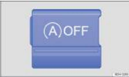
**Fig. 97** En la consola central: tecla del sistema Start-Stop.
