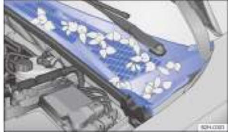
**Fig. 205** Entre el compartimento del motor y el parabrisas: caja de aguas (representación esquemática).
