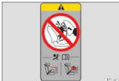
Fig. 41 Representación esquemática: etiqueta adhesiva relativa al airbag en el pilar B.
