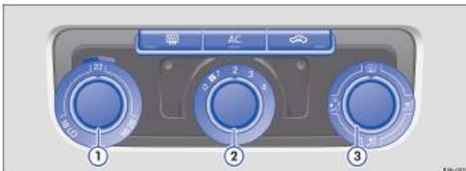
Fig. 87 En el tablero de instrumentos: mandos del Climatic.
