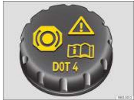
**Fig. 179** En el compartimento del motor: tapa del depósito del líquido de frenos.
