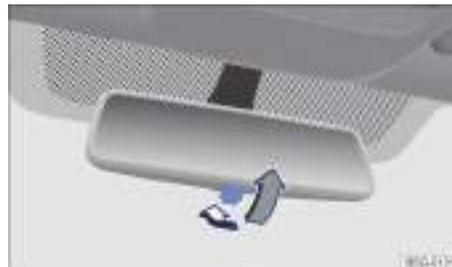
Fig. 83 En el parabrisas: retrovisor interior antideslumbrante manual.
