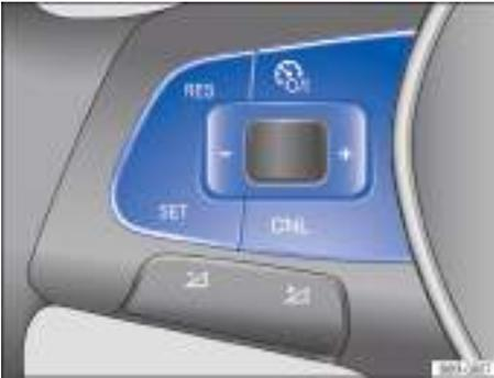
**Fig. 112** Lado izquierdo del volante multifunción: teclas para manejar el regulador de velocidad.
