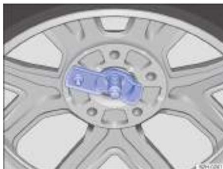
Fig. 191 Rueda de auxilio o de emergencia: colocación correcta del soporte para llantas en el orificio de la llanta. ▶
