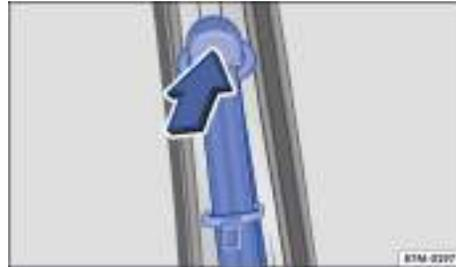
**Fig. 32** Junto a los asientos delanteros: regulador de la altura del cinturón.
