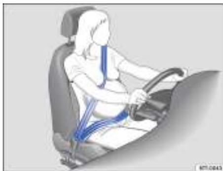
**Fig. 31** Colocación correcta de la banda del cinturón en el caso de las mujeres embarazadas.
