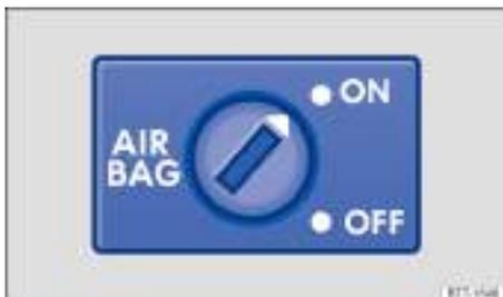
Fig. 36 En el lateral del tablero de instrumentos del lado del acompañante: conmutador de llave para activar y desactivar el airbag frontal del acompañante.
