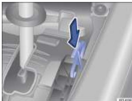
**Fig. 103** Desbloqueo de emergencia de la palanca selectora.
