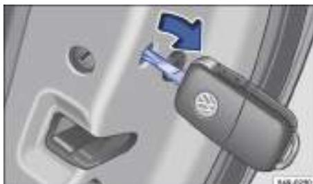
Fig. 49 Bloqueo manual con la llave del vehículo.
