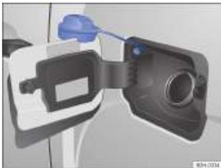
**Fig. 137** En el lado izquierdo del vehículo: tapa del tanque de combustible con el tapón abierto.
