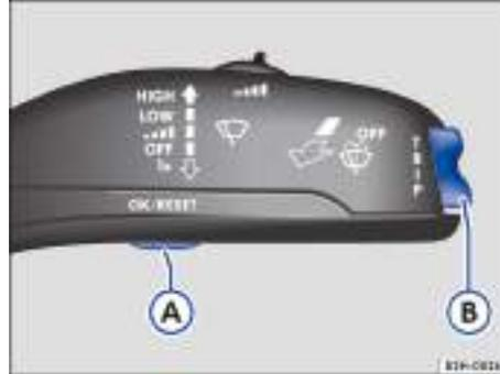
**Fig. 15** En la palanca del limpiaparabrisas: teclas para manejar los menús.
