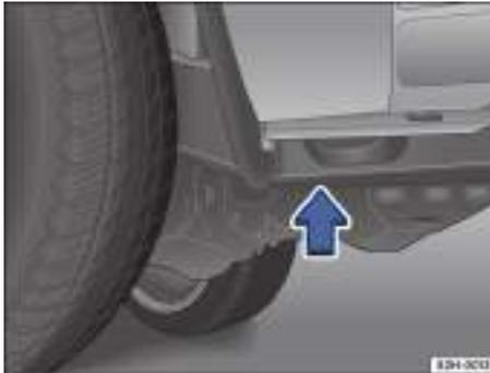
Fig. 198 Desde el lateral: punto de apoyo para el crique en la parte delantera.
