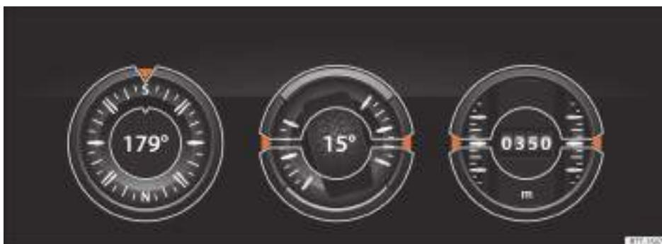
Fig. 106 En el sistema de infotainment: indicador Offroad.
