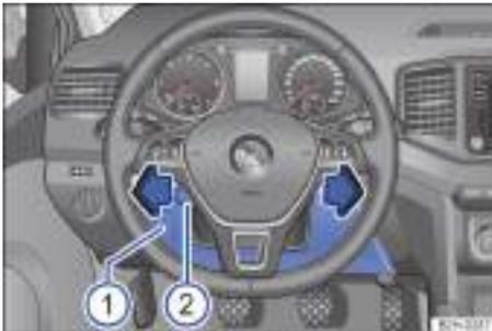
**Fig. 159** En el lado del conductor (vehículos con el volante a la izquierda): caja de fusibles detrás del revestimiento del tablero de instrumentos ①.
