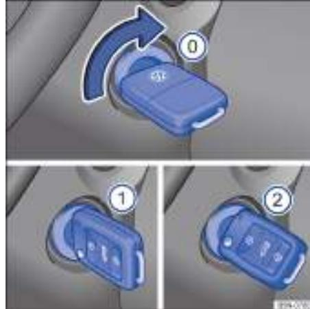
**Fig. 96** A la derecha del volante: posiciones de la llave del vehículo en la cerradura de encendido.
