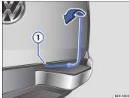
Fig. 188 Bajar la rueda de auxilio mediante el malacate.
