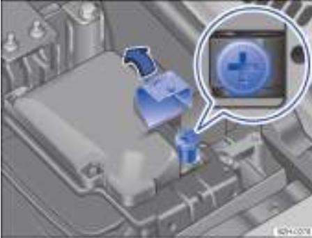
**Fig. 163** En el lado izquierdo del compartimento del motor: toma para la ayuda de arranque (polo positivo).
