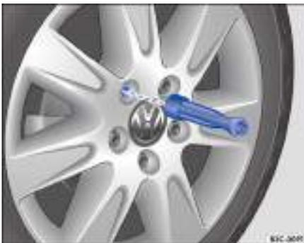
**Fig. 202** Cambio de rueda: desenroscar los tornillos de rueda con el mango del destornillador.
