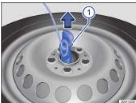
Fig. 190 Rueda de auxilio o de emergencia: soltar el soporte para llantas.
