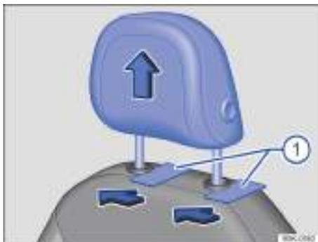
Fig. 66 Apoyacabezas delantero: desmontar (variante 1).
