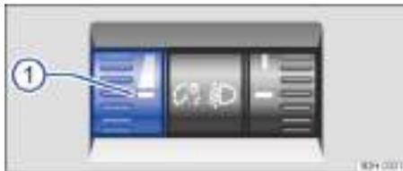
**Fig. 77** Junto al volante: regulador de la iluminación de los instrumentos y los mandos ①.
