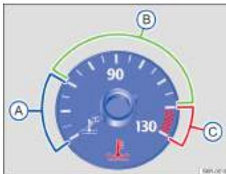
Fig. 13 En el cuadro de instrumentos: indicador de temperatura del líquido refrigerante del motor.
