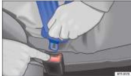
Fig. 25 Soltar la lengüeta del cierre del cinturón.
