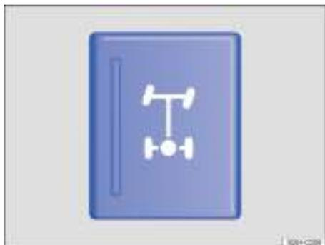
**Fig. 108** En la consola central: tecla del bloqueo del diferencial.
