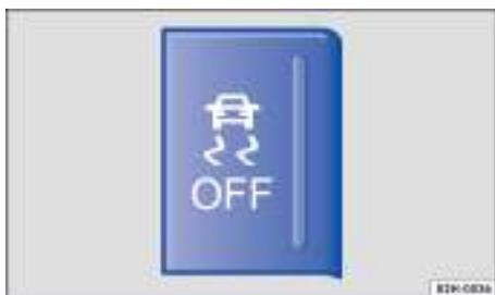
**Fig. 117** En la consola central: tecla para desconectar y conectar manualmente el ASR.
