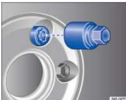
**Fig. 196** Cambio de rueda: tornillo de rueda antirrobo y adaptador.
