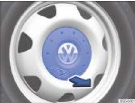
Fig. 193 Desmontar la taza de rueda central.
