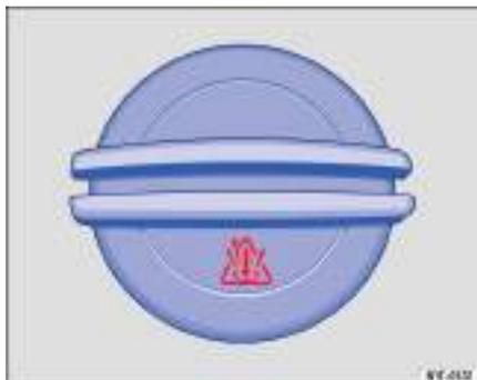
Fig. 177 En el compartimento del motor: tapa del depósito de expansión del líquido refrigerante del motor.
