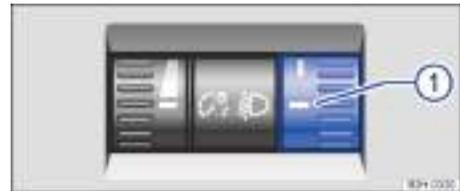
Fig. 76 Junto al volante: regulador del alcance de las luces ①.
