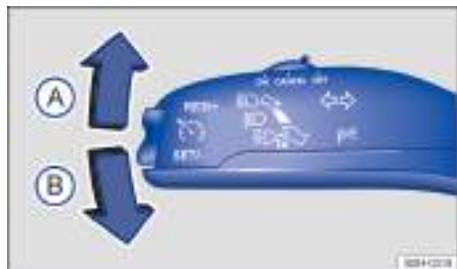
Fig. 75 En el lado izquierdo de la columna de dirección: palanca de las luces de giro y de la luz alta.
