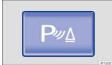
**Fig. 114** En la consola central: tecla para conectar y desconectar la ayuda de estacionamiento (en función del equipamiento).
