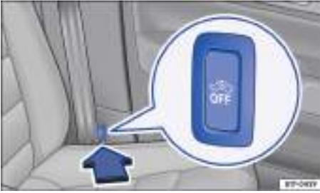
**Fig. 50** Junto al asiento del conductor: tecla para desconectar la vigilancia del habitáculo y el sistema antirremolcado.
