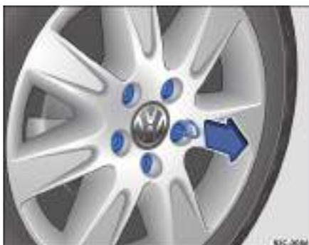
Fig. 194 Retirar las tapas de los tornillos de rueda.
