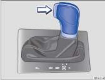
**Fig. 99** Vehículo con el volante a la izquierda: palanca selectora del cambio automático con tecla de bloqueo (flecha). En los vehículos con el volante a la derecha, la disposición es simétrica.
