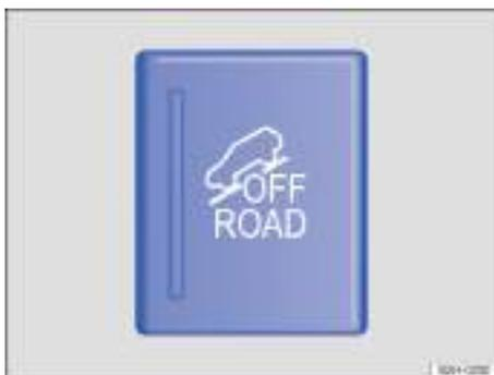
**Fig. 104** En la consola central: tecla para conectar y desconectar manualmente la función de carretera.
