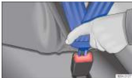
Fig. 26 Insertar la lengüeta del cinturón en su cierre.
