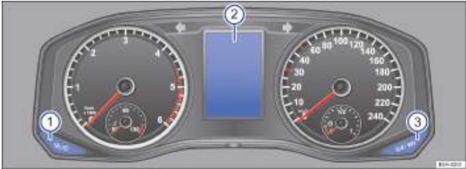
**Fig. 182** Teclas del cuadro de instrumentos, en el tablero de instrumentos.
