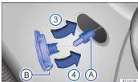
Fig. 153 Luz de giro lateral: sustituir la lámpara.
