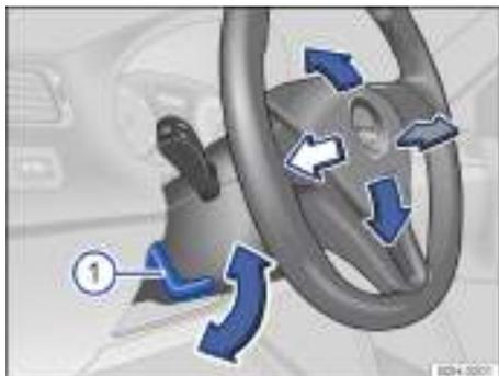
Fig. 56 Ajuste mecánico de la posición del volante.
