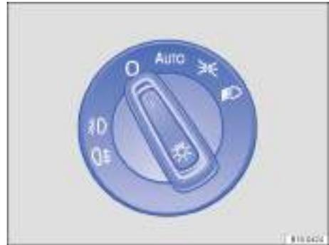
Fig. 73 Junto al volante: mando de las luces (una variante).
