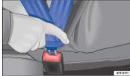
Fig. 24 Insertar la lengüeta del cinturón de seguridad en su cierre.
