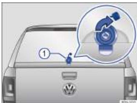
Fig. 54 Desbloqueo y bloqueo de emergencia de la luneta abatible.
