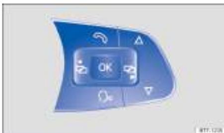
**Fig. 16** En el volante multifunción: teclas para utilizar los menús del cuadro de instrumentos.
