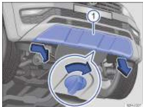
**Fig. 168** En el paragolpes delantero: cubierta del gancho para remolque.
