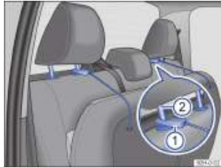
Fig. 62 Asiento trasero: fijación de la banqueta en los apoyacabezas.
