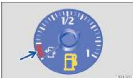
Fig. 12 En el cuadro de instrumentos: indicador del nivel de combustible.
