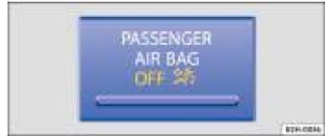
Fig. 33 En la parte superior de la consola central: testigo de control de la desactivación del airbag frontal del acompañante.
