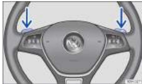
**Fig. 101** Volante con palancas de cambio para el Tiptronic.
