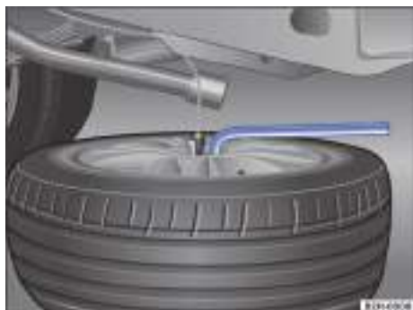
Fig. 156 Desenroscar el tornillo de seguridad con la llave de rueda.
