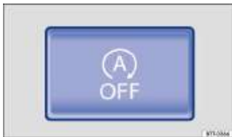
Fig. 110 En la consola central: tecla del sistema Start-Stop.
