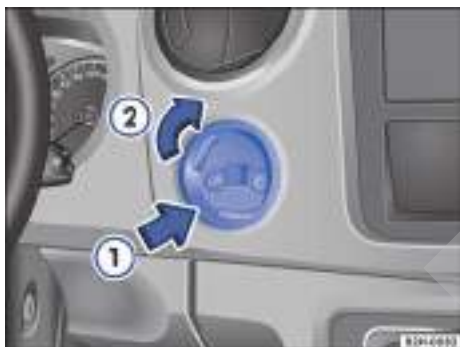
Fig. 91 Colocación de un accesorio en el punto multifijación.
