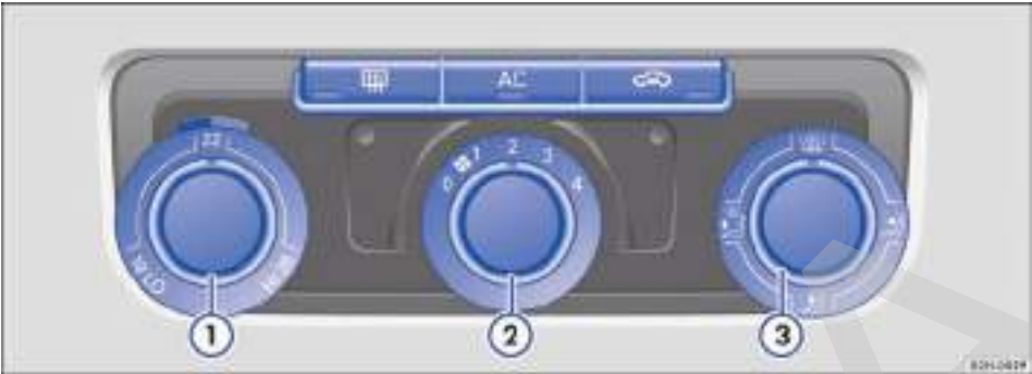
Fig. 122 En el tablero de instrumentos: mandos del Climatic.
