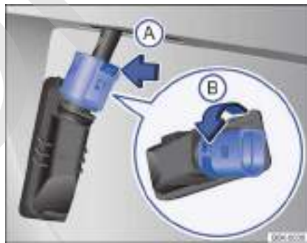
Fig. 179 Luz de la patente: desmontaje del portalámparas.
