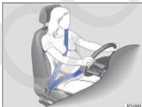
Fig. 55 Colocación correcta de la banda del cinturón en el caso de mujeres embarazadas.
