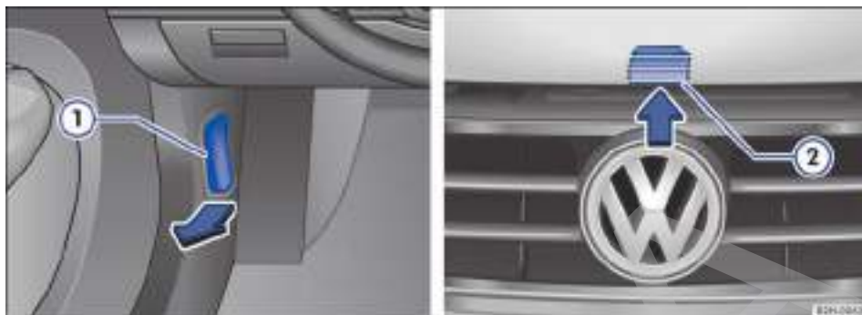
Fig. 131 ① En la zona reposapiés del conductor: palanca de desbloqueo del capó del motor. ② Palanca de desbloqueo para apertura del capó del motor, en la parrilla del radiador.
