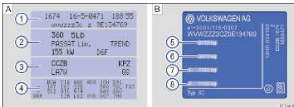
Fig. 189 A Portadatos del vehículo: en la figura, por ejemplo, con letras distintivas del motor CCZB ③. B: Placa de modelo.
