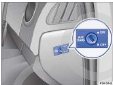
Fig. 60 En el lateral del tablero de instrumentos del lado del acompañante: interruptor de llave para desactivar y activar el airbag frontal del acompañante.
