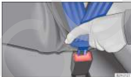
Fig. 50 Insertar la lengüeta del cinturón de seguridad en su cierre.
