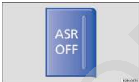
Fig. 106 En la consola central: tecla para desconectar y conectar manualmente el ASR.
