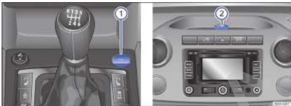
Fig. 97 Vehículos con el volante a la izquierda: en la parte delantera de la consola central ① (disposición simétrica en los vehículos con el volante a la derecha) y en el portaobjetos del tablero de instrumentos ②: toma de corriente de 12 voltios.
