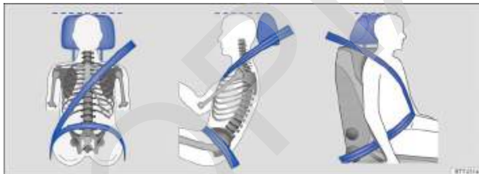
Fig. 54 Colocación correcta de la banda del cinturón y ajuste correcto del apoyacabezas.
