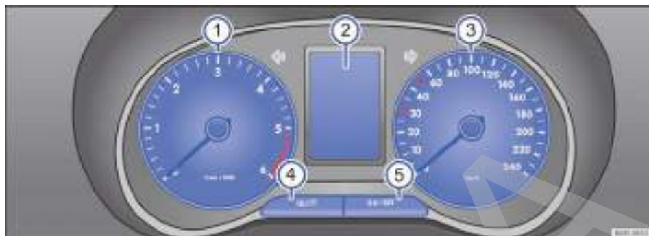
Fig. 12 Cuadro de instrumentos en el tablero de instrumentos: variante 1:
