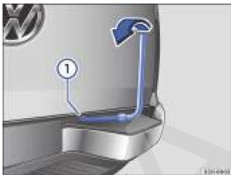
Fig. 155 Bajar la rueda de auxilio mediante el malacate.
