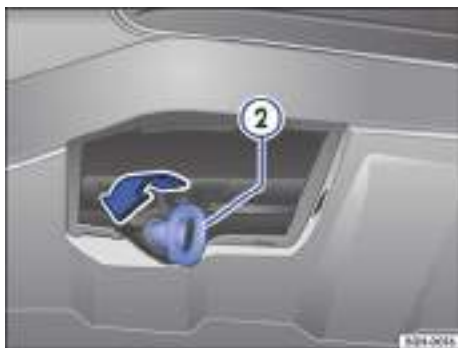
Fig. 187 En el lado derecho del paragolpes delantero: enroscar el gancho para remolque.
