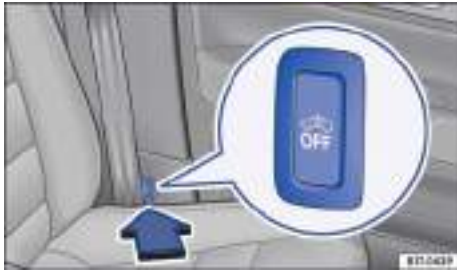
Fig. 22 Junto al asiento del conductor: tecla para desconectar la vigilancia del habitáculo y el sistema antirremolcado.
