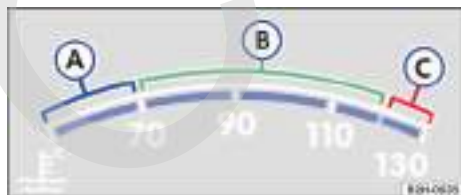
Fig. 135 Indicador de la temperatura del líquido refrigerante del motor en la pantalla del cuadro de instrumentos (variante 1): A) zona fría; B) zona normal; C) zona de advertencia.
