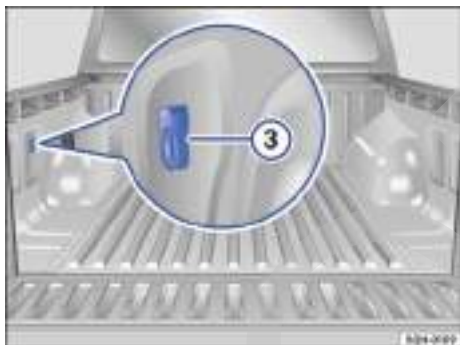
Fig. 98 En la superficie de carga: toma de corriente de 12 voltios.
