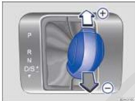
Fig. 104 Vehículos con el volante a la izquierda: palanca selectora en la posición Tiptronic (disposición simétrica en los vehículos con el volante a la derecha).
