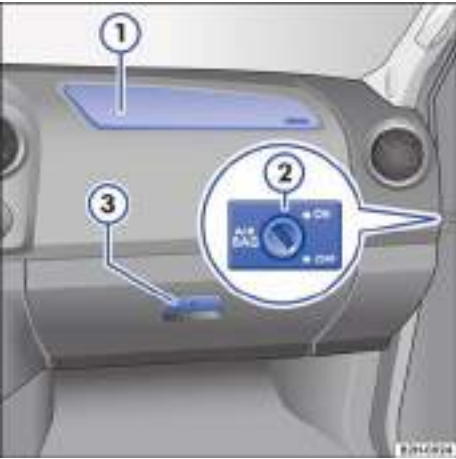
Fig. 11 Cuadro general del lado del acompañante (vehículos con el volante a la izquierda). En los vehículos con el volante a la derecha, la disposición es simétrica.
