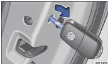
Fig. 148 Bloqueo de emergencia del vehículo con la llave del vehículo.
