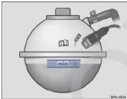
Fig. 137 En el compartimento del motor: marca del depósito de expansión del líquido refrigerante del motor.
