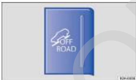
Fig. 111 En la consola central: tecla para conectar y desconectar manualmente la función fuera de carretera.
