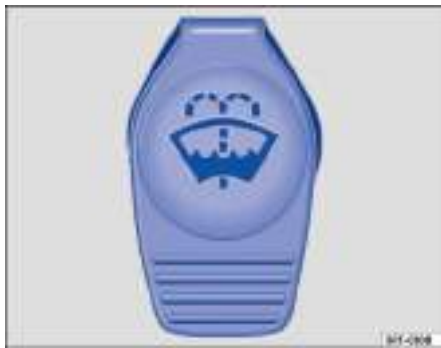
Fig. 77 En el compartimento del motor: tapa del depósito del lavacristales.
