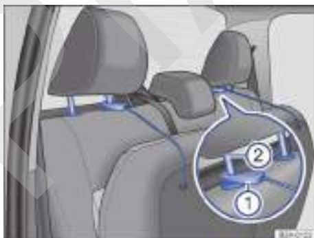
Fig. 41 Asiento trasero: fijación de la banqueta en los apoyacabezas.
