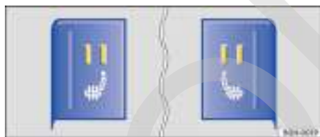
Fig. 38 En la consola central: teclas de la calefacción de los asientos delanteros.
