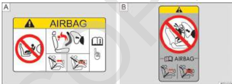
Fig. 63 Representación esquemática: etiqueta adhesiva relativa al airbag en el parasol (A) y en el pilar B (B).
