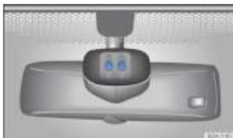
Fig. 76 Superficie de referencia del sensor de lluvia.
