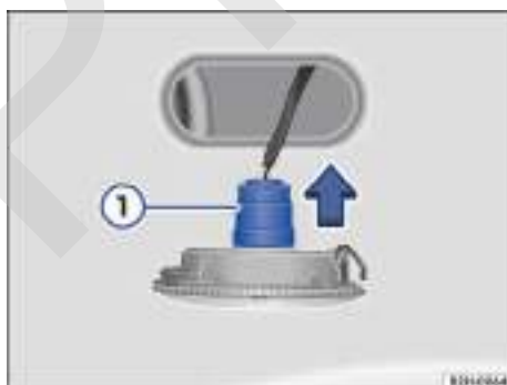
Fig. 181 Luz de giro lateral: sustituir la lámpara.
