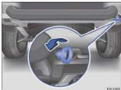
Fig. 188 En el lado derecho del paragolpes trasero: gancho para remolque enroscado.
