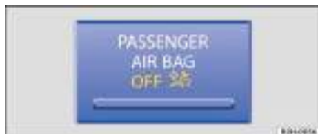
Fig. 57 Testigo de control de la desactivación del airbag frontal del acompañante en el tablero de instrumentos.
