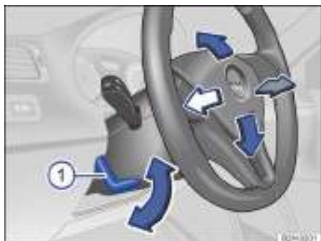
Fig. 37 Ajuste mecánico de la posición del volante.
