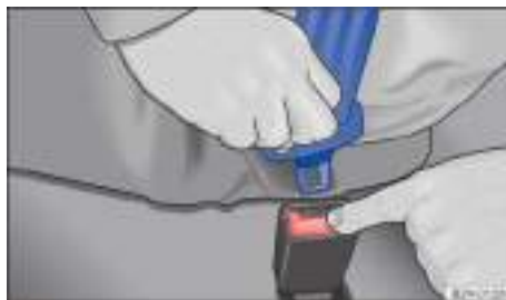
Fig. 51 Soltar la lengüeta del cinturón de seguridad de su cierre.
