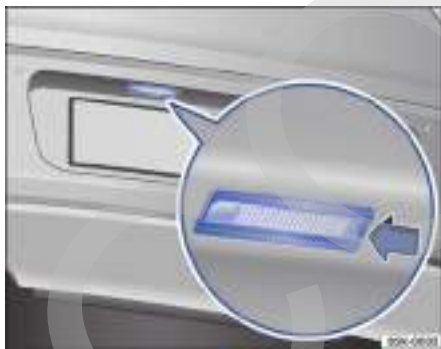
Fig. 178 En la chapa de cierre trasera, debajo del portón de carga: luz de la patente.
