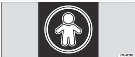
Fig. 127 En la pantalla del techo: símbolo de la activación del seguro para niños.
