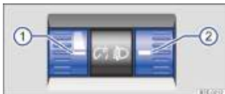
Fig. 72 Junto al volante: regulador de la iluminación de los instrumentos y los mandos ① y regulador del alcance de las luces ②.
