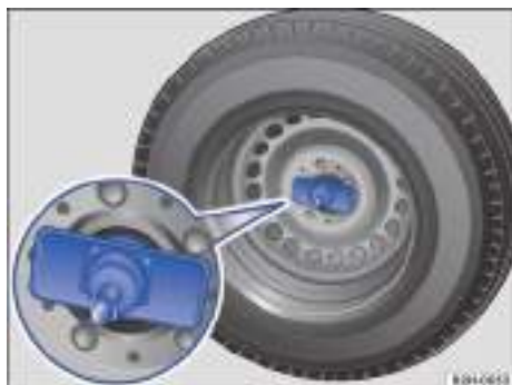
Fig. 165 Colocación correcta del soporte para llantas en el orificio de la llanta.
