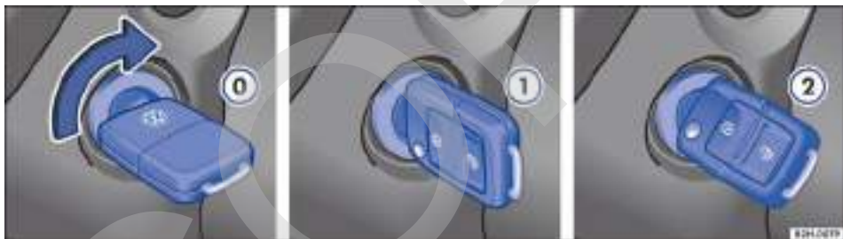
Fig. 99 Posiciones de la llave del vehículo en la cerradura de encendido.
