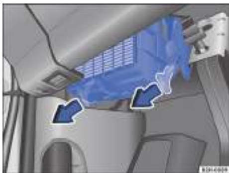
Fig. 167 Caja de fusibles debajo del tablero de instrumentos (vehículos con el volante a la izquierda).
