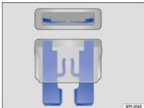
Fig. 169 Representación de un fusible fundido.
