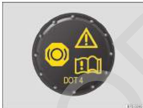
Fig. 108 En el compartimento del motor: tapa del depósito del líquido de frenos.
