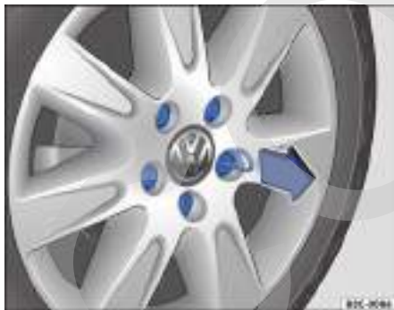
Fig. 153 Quitar los capuchones de los tornillos de rueda.
