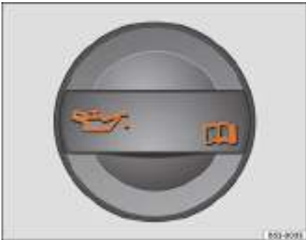
Fig. 134 En el compartimento del motor: tapa de la boca de llenado de aceite.
