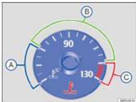
Fig. 136 Indicador de la temperatura del líquido refrigerante del motor en el cuadro de instrumentos (variante 2): (A) zona fría; (B) zona normal; (C) zona de advertencia.
