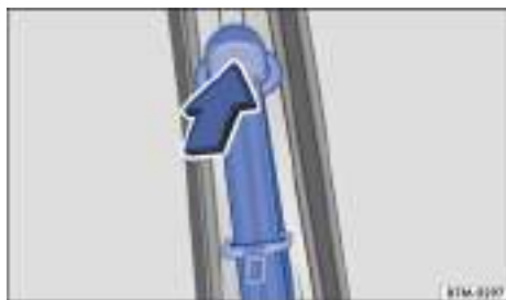
Fig. 56 Junto a los asientos delanteros: regulador de la altura del cinturón.
