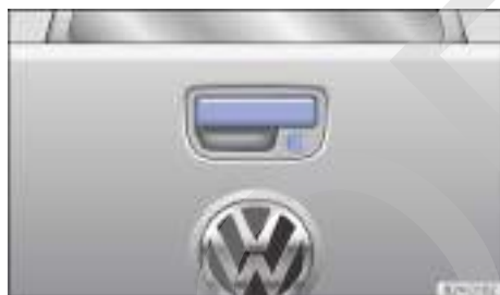
Fig. 25 Apertura del portón de carga desde el exterior.
