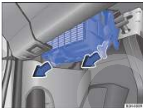
Fig. 187 Caja de fusibles debajo del tablero de instrumentos (vehículos con el volante a la izquierda).
