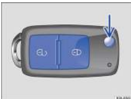
Fig. 17 Teclas en la llave del vehículo y botón para desplegar la espada de la llave.
