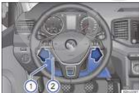
Fig. 188 Caja de fusibles detrás del revestimiento del tablero de instrumentos (vehículos con el volante a la izquierda) ①.
