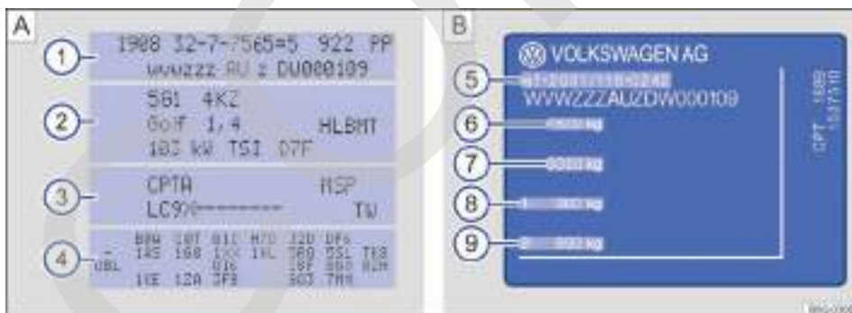
Fig. 209 A: Portadatos del vehículo: en la figura, por ejemplo, con letras distintivas del motor CPTA ③. B: Placa de modelo.
