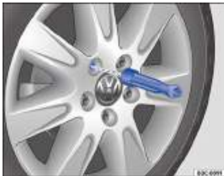
Fig. 184 Cambio de rueda: desenroscar los tornillos de rueda con el mango del destornillador.
