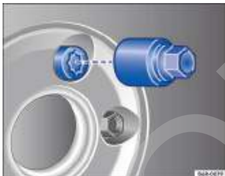
Fig. 178 Cambio de rueda: tornillo de rueda antirrobo y adaptador.
