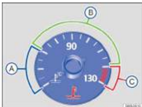
Fig. 147 Indicador de la temperatura del líquido refrigerante del motor en el tablero de instrumentos: (A) zona fría; (B) zona normal; (C) zona de advertencia.
