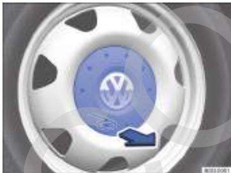
Fig. 171 Desmontar la taza de rueda central tirando de ella.
