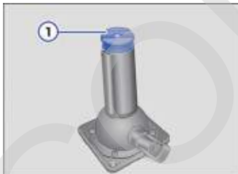
Fig. 183 Colocar el crique debajo del eje trasero.
