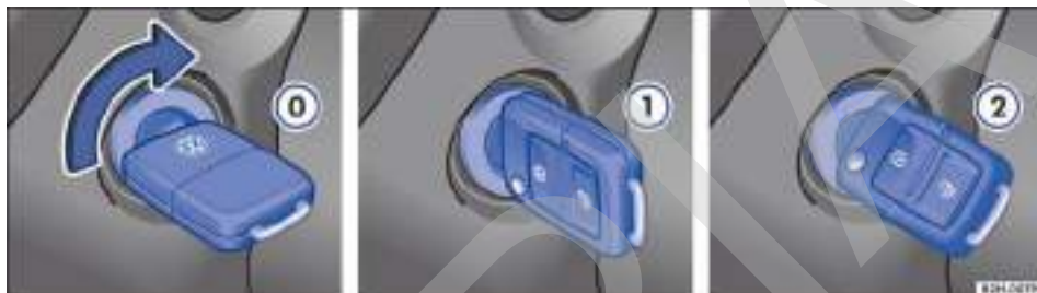
Fig. 107 Posiciones de la llave del vehículo en la cerradura de encendido.
