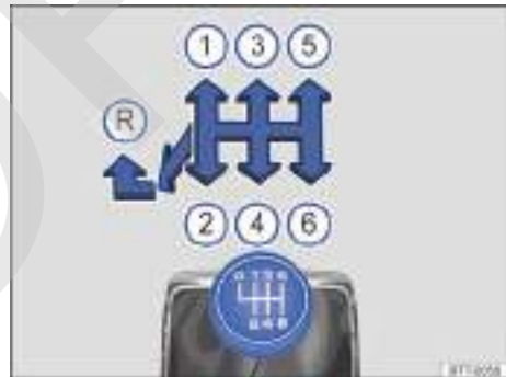
Fig. 110 Esquema de un cambio manual de 6 marchas.
