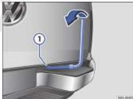
Fig. 174 Bajar la rueda de auxilio mediante el malacate.
