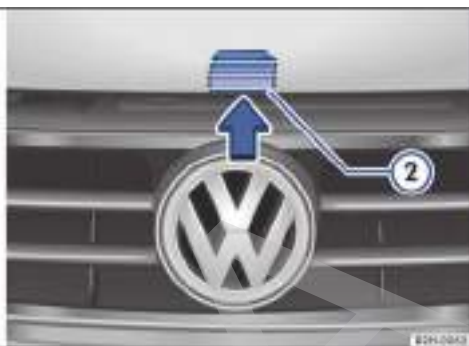
Fig. 143 ① En la zona reposapiés del conductor: palanca de desbloqueo del capó del motor. ② Palanca de desbloqueo para apertura del capó del motor, en la parrilla del radiador.
