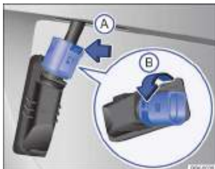
Fig. 198 Luz de la patente: desmontaje del portalámparas.
