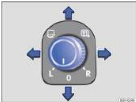
Fig. 88 En la puerta del conductor: mando giratorio de los retrovisores exteriores.
