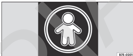
Fig. 131 En la pantalla del techo: símbolo de la activación del seguro para niños.
