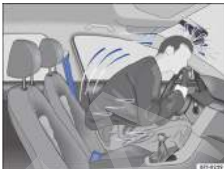
Fig. 52 El conductor sin el cinturón de seguridad colocado sale lanzado hacia delante.
