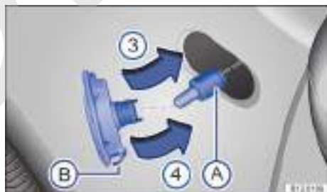
Fig. 200 Luz de giro lateral: sustituir la lámpara. ►
