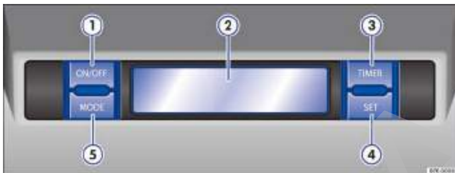
Fig. 128 En el revestimiento interior del techo: mandos de la calefacción adicional por agua (calefacción independiente).
