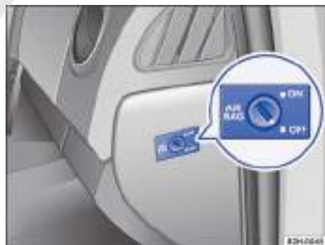
Fig. 67 En el lateral del tablero de instrumentos del lado del acompañante: interruptor de llave para desactivar y activar el airbag frontal del acompañante.
