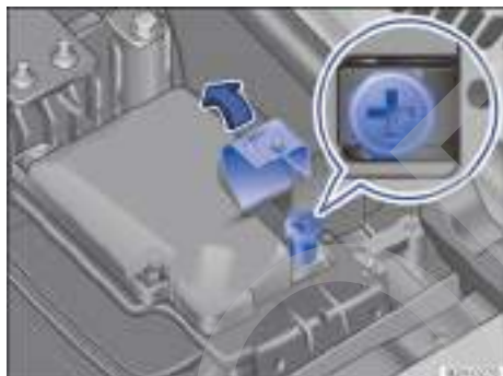
Fig. 203 En el compartimento del motor: toma positiva para la ayuda de arranque.
