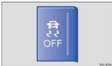
Fig. 115 En la consola central: tecla para desconectar y conectar manualmente el ESC.
