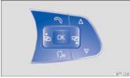
Fig. 13 Vehículos con volante multifunción: teclas para utilizar los menús del cuadro de instrumentos.
