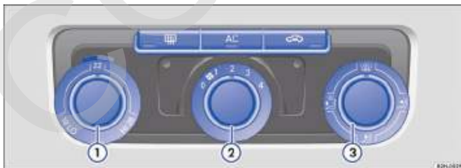
Fig. 125 En el tablero de instrumentos: mandos del Climatic.
