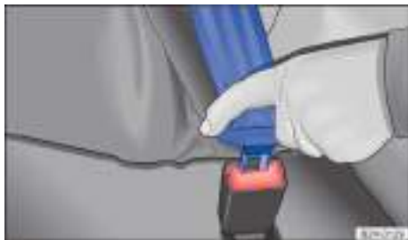
Fig. 59 Insertar la lengüeta del cinturón abdominal en el cierre del mismo.
