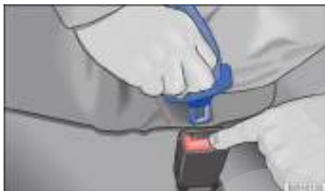
Fig. 60 Soltar la lengüeta del cinturón abdominal del cierre del mismo.
