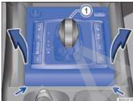
Fig. 166 Desmontar la cubierta de la corredera de la palanca selectora.
