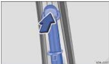
Fig. 63 Junto a los asientos delanteros: regulador de la altura del cinturón.
