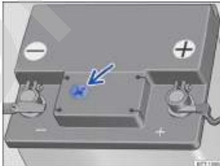
Fig. 151 Representación esquemática: mirilla en la parte superior de la batería.
