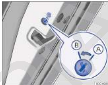
Fig. 22 En la puerta trasera derecha: seguro para niños (A) desactivado, (B) activado.
