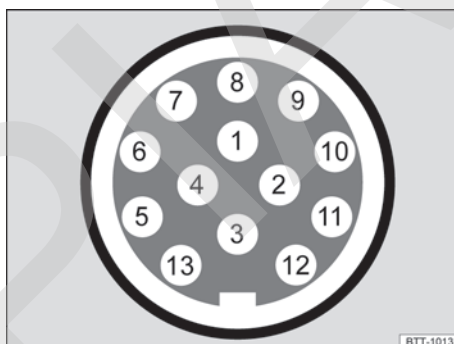
Fig. 92 Representación esquemática: asignación de los pines de la toma de corriente para remolque.
