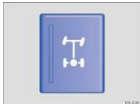
Fig. 139 En la consola central: tecla del bloqueo del diferencial del eje trasero.
