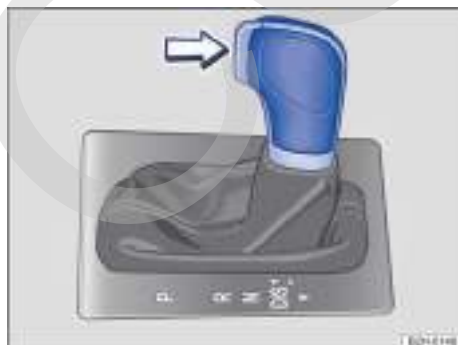
Fig. 111 Vehículos con el volante a la izquierda: palanca selectora del cambio automático con tecla de bloqueo (flecha).
