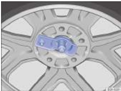
Fig. 185 Colocación correcta del soporte para llantas en el orificio de la llanta.
