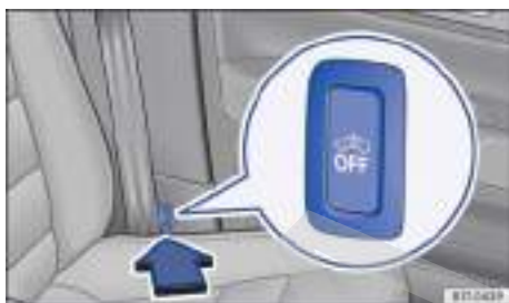
Fig. 20 Junto al asiento del conductor: tecla para desconectar la vigilancia del habitáculo y el sistema antirremolcado.
