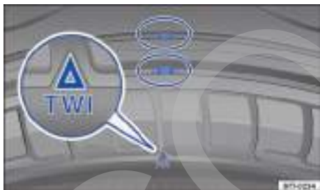
Fig. 157 Perfil del neumático: indicadores de desgaste.
