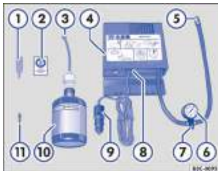
Fig. 186 Representación esquemática: componentes del kit reparapinchazos.
