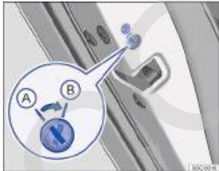
Fig. 21 En la puerta trasera izquierda: seguro para niños (A) desactivado, (B) activado.
