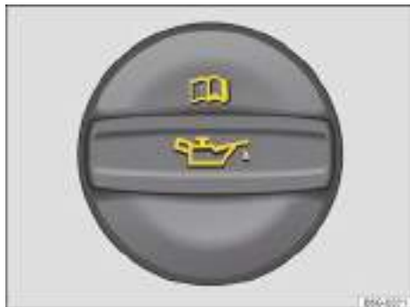
Fig. 146 En el compartimento del motor: tapa de la boca de llenado de aceite (representación esquemática).
