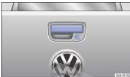
Fig. 23 Apertura del portón de carga desde el exterior.
