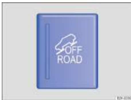
Fig. 140 En la consola central: tecla para conectar y desconectar manualmente la función fuera de carretera.
