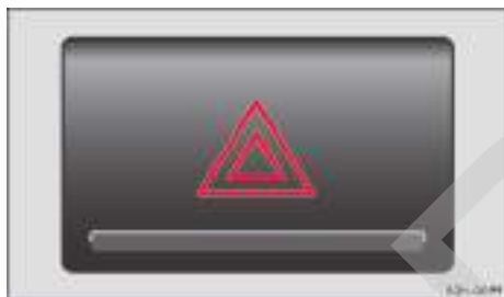
Fig. 162 En la parte central del tablero de instrumentos: pulsador de las balizas.
