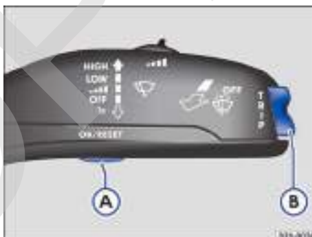
Fig. 12 Vehículos sin volante multifunción: tecla A en la palanca del limpiaparabrisas para confirmar opciones de menú y tecla basculante B para cambiar de menú.
