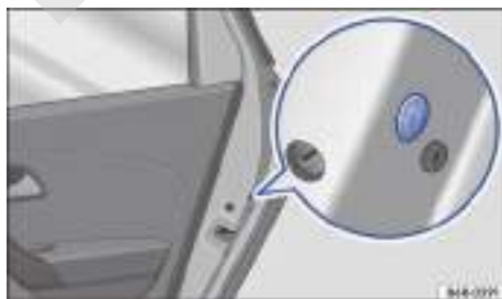
Fig. 164 En el frontal de la puerta trasera derecha: bloqueo de emergencia tapado por una junta de goma.
