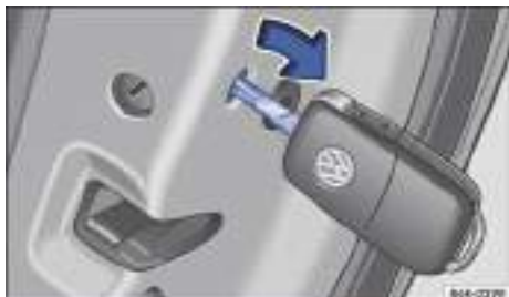
Fig. 165 Bloqueo de emergencia del vehículo con la llave del vehículo.
