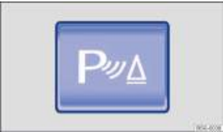
Fig. 119 En la consola central: tecla para conectar y desconectar el ParkPilot (en función del equipamiento).
