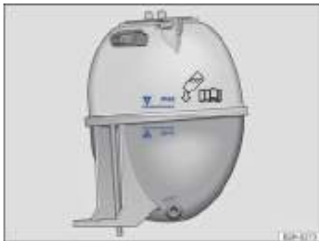
Fig. 148 En el compartimento del motor: marcas en el depósito de expansión del líquido refrigerante del motor.
