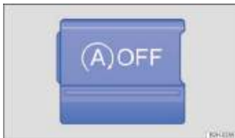
Fig. 118 En la consola central: tecla del sistema Start-Stop.
