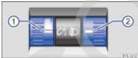
Fig. 77 Junto al volante: regulador de la iluminación de los instrumentos y los mandos ① y regulador del alcance de las luces ② .
