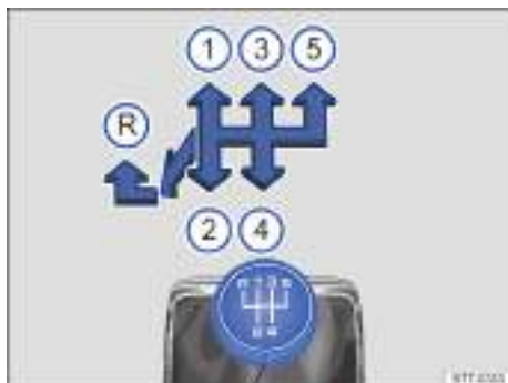
Fig. 86 Esquema de la transmisión manual de 5 marchas.
