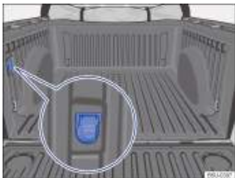
Fig. 114 Compartimento de carga: toma de corriente 12 V.
