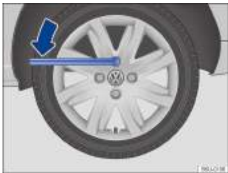
Fig. 215 Cambio de rueda: aflojar los tornillos de la rueda.
