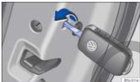
Fig. 45 Cierre de emergencia del vehículo con la llave del vehículo.
