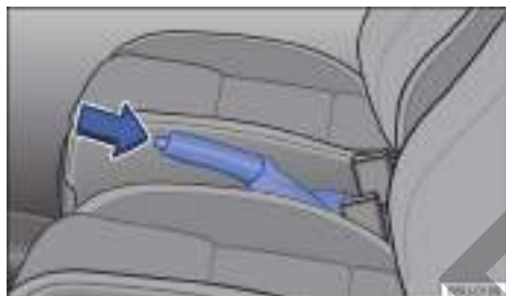
Fig. 91 Entre los asientos delanteros: palanca del freno de estacionamiento.
