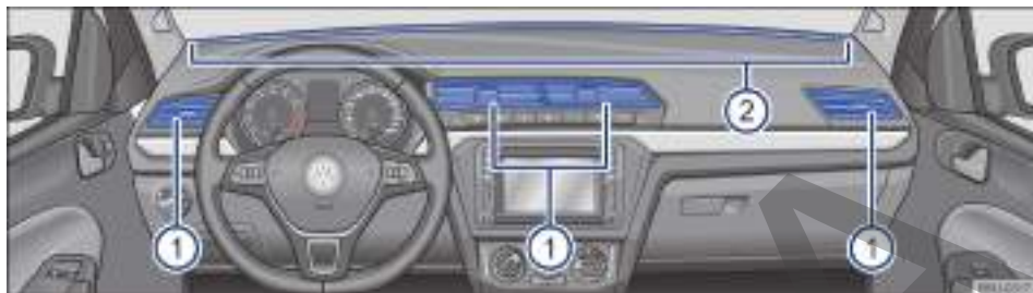
Fig. 79 En el panel de instrumentos: difusores de aire.
