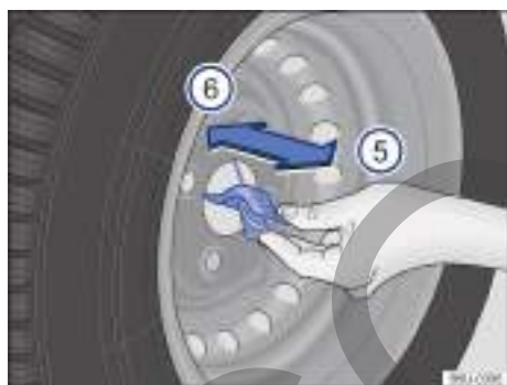
Fig. 211 En la rueda de emergencia: retirar el cable de la rueda de emergencia.
