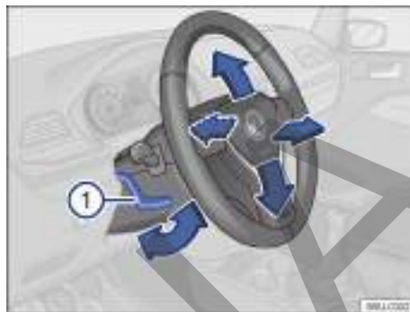
Fig. 57 Ajustar la posición del volante.
