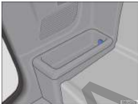
Fig. 111 En el lateral del compartimento interior de equipaje: toma de 12 V.
