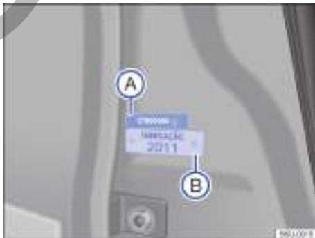
Fig. 222 En la columna de la puerta delantera derecha: etiqueta con el número de identificación del vehículo parcial (VIS) A y la etiqueta del año de fabricación B.
