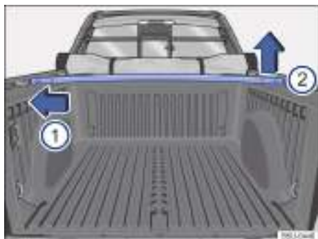
Fig. 53 Travesaños en el compartimento de carga: desmontar y montar.
