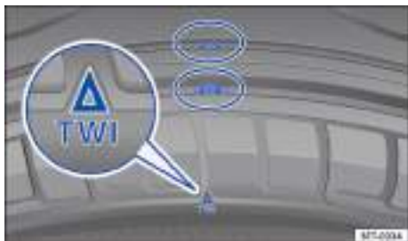
Fig. 209 Perfil del neumático: indicadores de desgaste.
