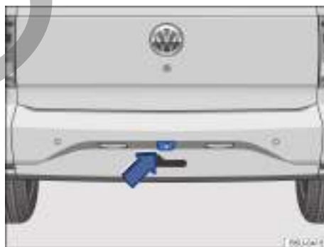
Fig. 95 En el paragolpes trasero: lugar de instalación del asistente de conducción en marcha atrás.
