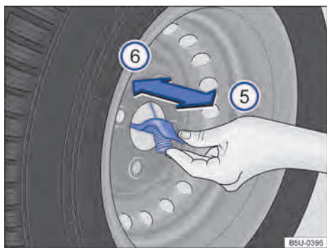
Fig. 166 En la rueda de emergencia: retirar el cable de la rueda de emergencia.
