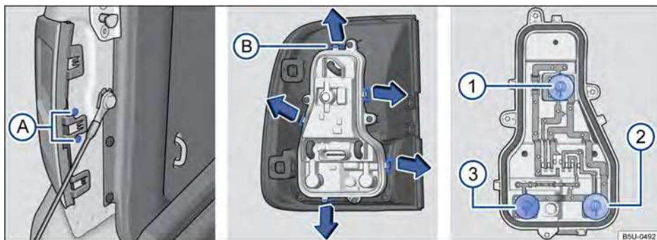
Fig. 138 Luz trasera: Ⓒ desmontar el portalámparas y ①, ②, ③, ④ y ⑤ desmontar las bombillas.
