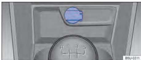
Fig. 106 En la consola central delantera: toma de corriente de 12 V.
