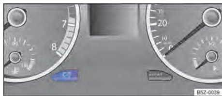
Fig. 65 En el panel de instrumentos: tecla de regulación de la iluminación de los instrumentos y de los interruptores.
