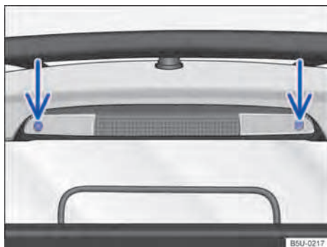
Fig. 141 En el compartimento de carga: remover la linterna de freno elevada.
