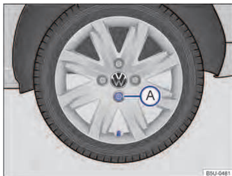
Fig. 169 Retirar la super llanta.
