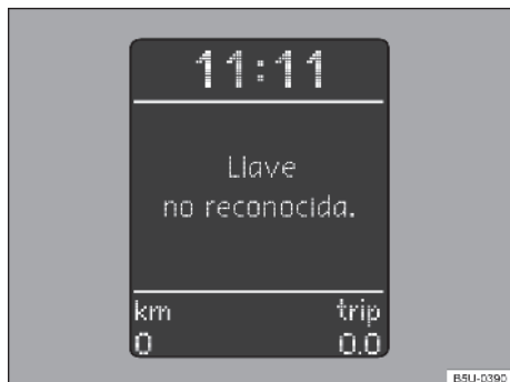
Fig. 83 En el panel de instrumentos: display con indicación del inmovilizador activado - vehículos con Sistema de Informaciones Volkswagen.
