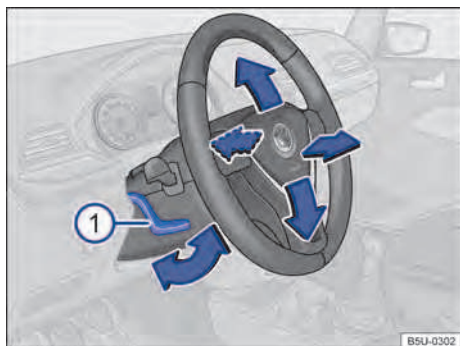
Fig. 55 Debajo y a la izquierda del volante junto con el revestimiento de la columna de dirección: palanca de ajuste de la posición del volante.
