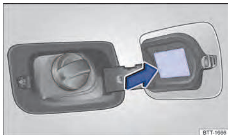
Fig. 163 En la parte interior de la portezuela del depósito de combustible: etiqueta con la presión de los neumáticos.
