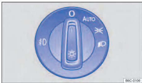
Fig. 61 Al lado del volante: interruptor de luces.
