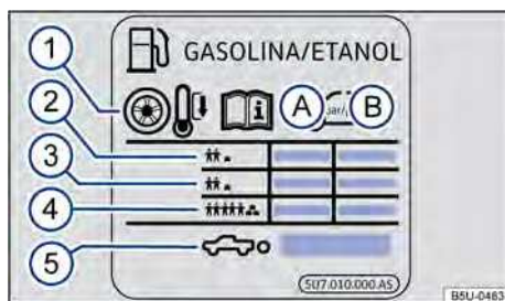
Fig. 162 Etiqueta con las presiones de los neumáticos
