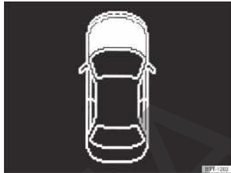
Fig. 221 En el display del instrumento combinado: tapa del compartimento del motor abierta o cerrada incorrectamente (representación esquemática).
