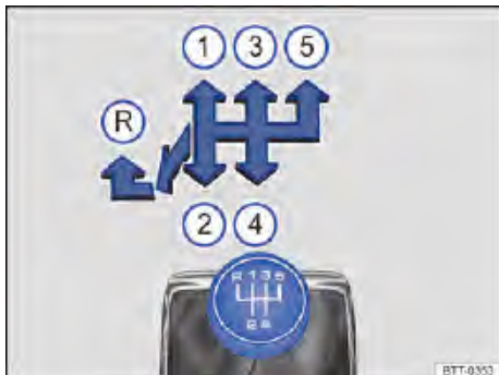
Fig. 98 Esquema de la transmisión manual de 5 marchas.
