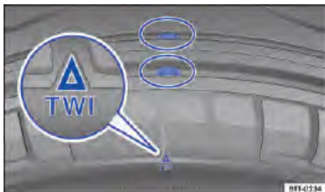
Fig. 233 Perfil del neumático: indicadores de desgaste.
