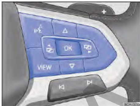
Fig. 21 Lado derecho del volante multifunción (variante 2): teclas para el mando de los menús y visualizaciones de información del instrumento combinado.
