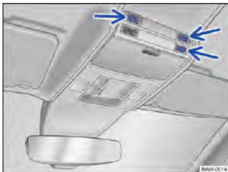
Fig. 59 En la consola del techo: sensores de vigilancia del habitáculo (flechas).
