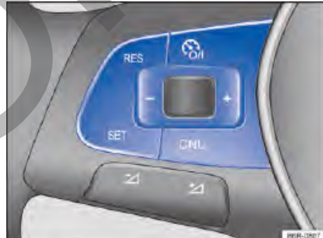
Fig. 107 Lado izquierdo del volante multifunción (variante 1): teclas para controlar el GRA.
