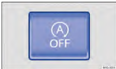
Fig. 97 En la parte superior de la consola central: tecla del sistema Start-Stop.
