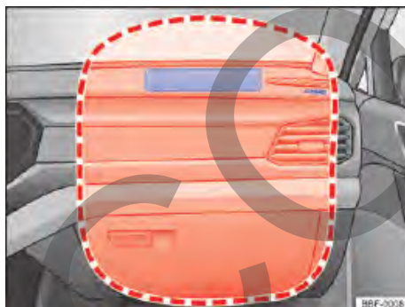
Fig. 37 Ubicación y radio de expansión del airbag frontal del acompañante.
