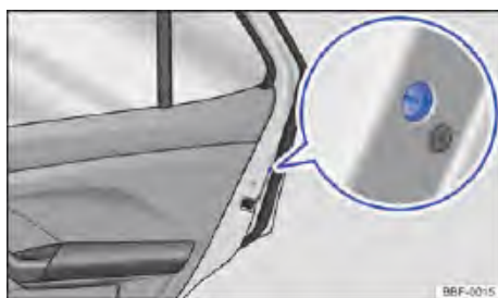
Fig. 57 En la puerta trasera: bloqueo de emergencia. ▶
