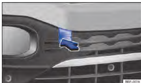
Fig. 217 En el parachoques delantero a la derecha: suelte y desmonte la cubierta.
