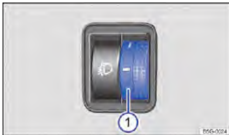
Fig. 78 Al lado del volante: conmutador de ajuste de alcance del faro.
