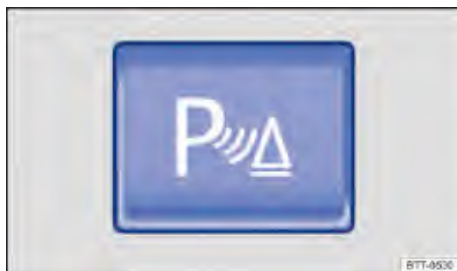
Fig. 110 En la consola central: tecla de encender y apagar la ayuda de aparcamiento.
