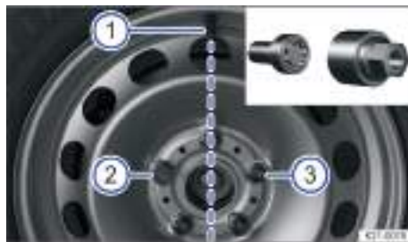
Fig. 196 Posición correcta del tornillo de rueda antirobo.
