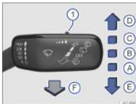
Fig. 75 En el lado derecho de la columna de dirección: manejo del limpiaparabrisas.
