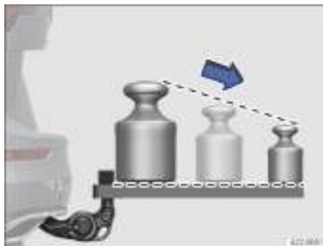
Fig. 139 Reparto recomendado del peso en el sistema portante trasero.
