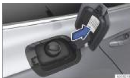
Fig. 141 En la cara interior de la tapa del depósito de combustible: adhesivo del combustible (representación esquemática).
