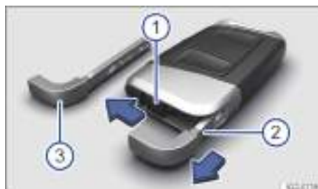
Fig. 40 Llave del vehículo: desbloqueo de la llave de emergencia (representación esquemática).
