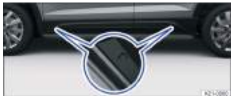
Fig. 192 En el larguero inferior: marcas para los puntos de alojamiento del gato.
