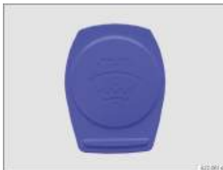
Fig. 170 En el vano delantero: tapa del depósito del líquido lavacrystales (representación esquemática).
