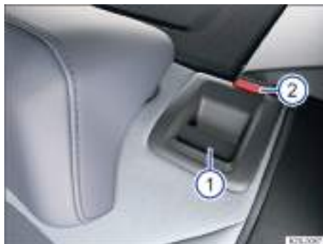
Fig. 62 En el respaldo del asiento trasero: tecla de desbloqueo.
