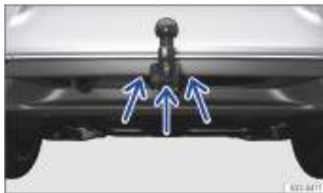
Fig. 137 En el dispositivo de remolque: argolla para fijar el cable de seguridad o el de ruptura (representación esquemática).
