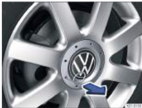
Fig. 188 Desmontar el tapacubos central tirando de él.
