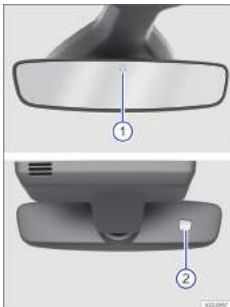
Fig. 78 En el parabrisas: retrovisor interior antideslumbrante automático.
