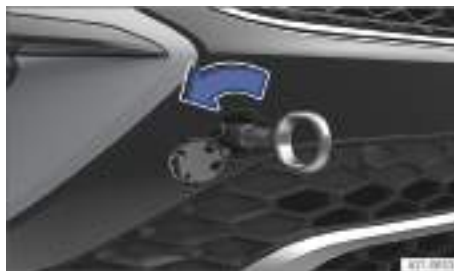
Fig. 163 En el lado derecho del paragolpes delantero: enroskar la argolla de remolque.
