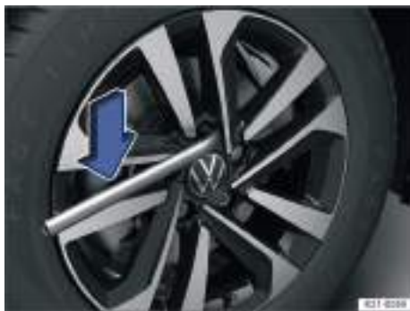
Fig. 195 Desenroscar los tornillos de rueda con la llave de rueda.
