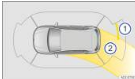
Fig. 116 Sistema de infotainment: visualización de la ayuda de aparcamiento (representación esquemática).
