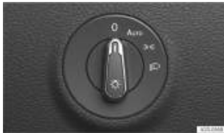
Fig. 71 Junto al volante: mando de las luces.
