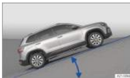
Fig. 95 Representación esquemática: ángulo de pendiente.
