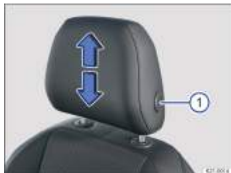
Fig. 63 Desmontaje de los apoyacabezas delanteros (representación esquemática).
