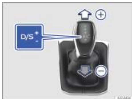
Fig. 90 En la consola central: palanca selectora en la posición Tiptronic.
