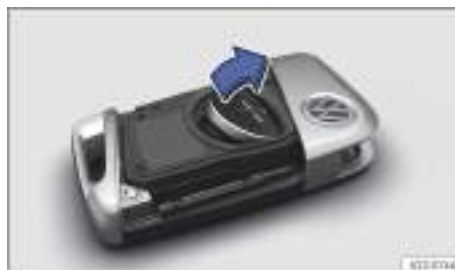
Fig. 43 Llave del vehículo: cambiar la pila de botón.
