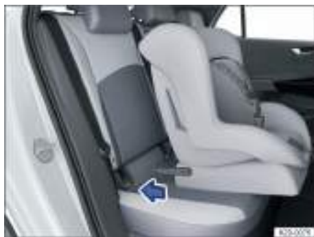
Fig. 35 Montaje de un asiento para niños con conectores (representación esquemática).
