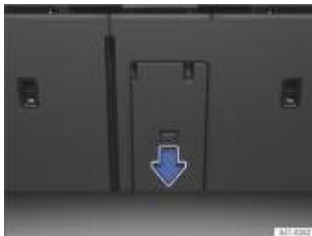
Fig. 136 En el maletero: parte trasera de la trampilla para cargas largas (representación esquemática).
