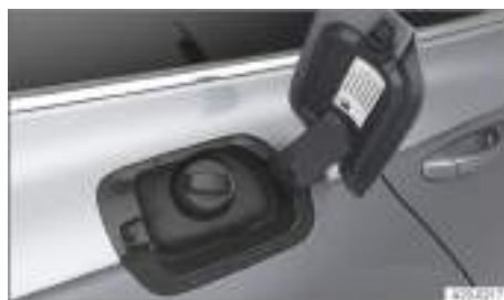
Fig. 146 Detrás de la tapa del depósito de combustible: tapón del depósito (representación esquemática).
