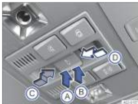
Fig. 56 En el revestimiento interior del techo: tecla del techo de cristal.
