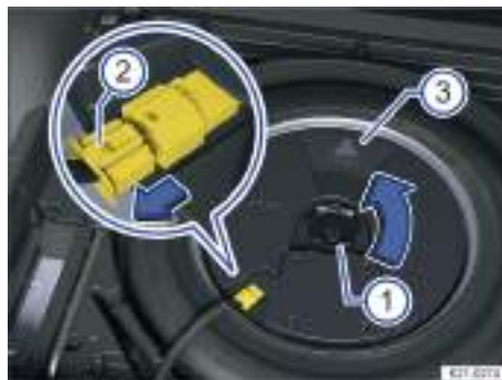
Fig. 186 En el maletero: desmontar el subwoofer (variante 2).
