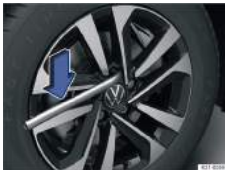
Fig. 191 Aflojar los tornillos de rueda.
