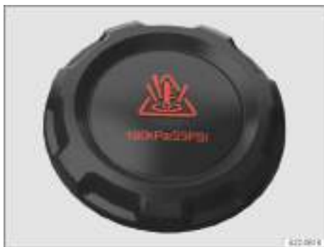
Fig. 175 En el vano delantero: tapa del depósito de expansión del líquido refrigerante (representación esquemática).
