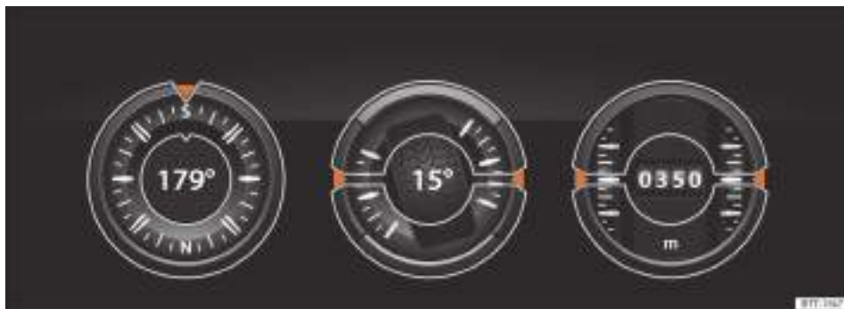
Fig. 94 En el sistema de infotainment: indicador Offroad.
