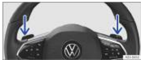
Fig. 91 Detrás del volante: levas de cambio para el Tiptronic.
