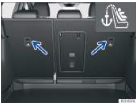
Fig. 36 En la parte posterior del asiento trasero: anclajes Top Tether para el cinturón de fijación superior Top Tether.
