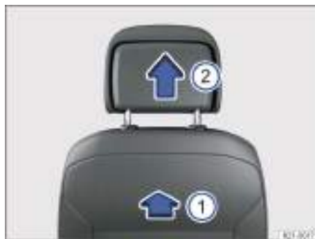
Fig. 65 Desmontaje de los apoyacabezas delanteros (representación esquemática).
