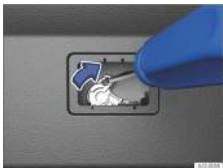
Fig. 54 En el maletero: desbloqueo de emergencia del portón.
