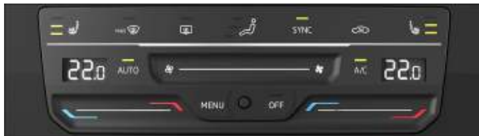
Fig. 83 En la parte superior de la consola central: panel de mandos del Climatronic (variante 1).
