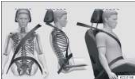
Fig. 25 Colocación correcta de la banda del cinturón y ajuste correcto del apoyacabezas (representación esquemática).
