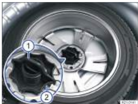
Fig. 187 Debajo del piso del maletero: ruedecilla para fijar la rueda de repuesto o la rueda de emergencia.
