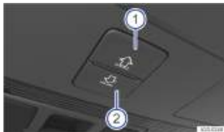
Fig. 82 En el revestimiento interior del techo: teclas para manejar la cortinilla parasol.
