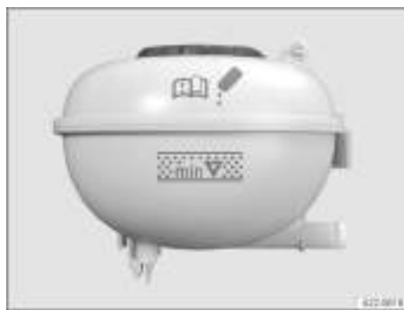
Fig. 176 En el vano delantero: marcas en el depósito de expansión del líquido refrigerante (representación esquemática).
