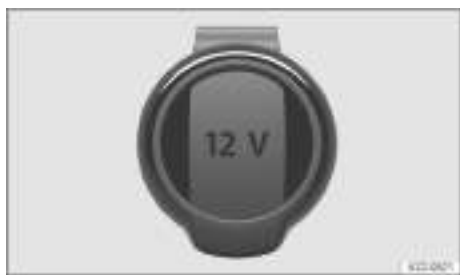
Fig. 127 En el portaobjetos delantero o en el lado izquierdo del maletero: toma de corriente de 12 voltios con tapa plegable (representación esquemática).
