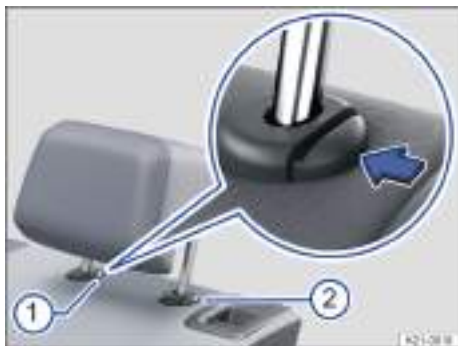
Fig. 66 Desmontaje de los apoyacabezas traseros (representación esquemática).
