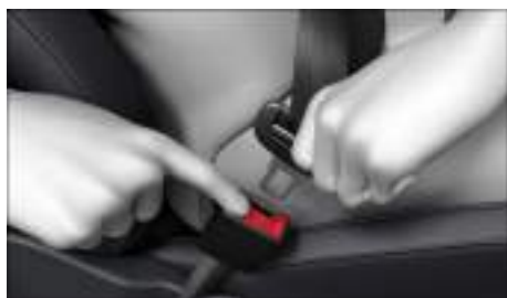
Fig. 24 Soltar la lengüeta del cierre del cinturón (representación esquemática).
