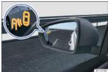
Fig. 114 En los espejos de los retrovisores exteriores: indicación del detector de ángulo muerto.
