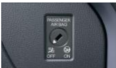
Fig. 29 En el tablero de instrumentos, en el lado del acompañante: conmutador de llave para desactivar y activar el airbag frontal del acompañante.
