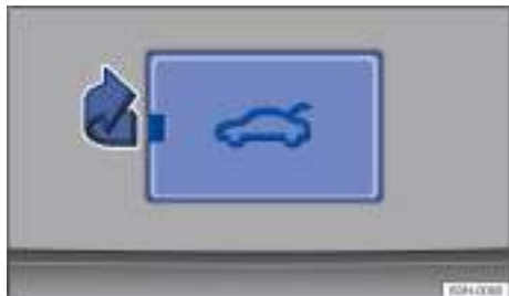
Fig. 53 En el portón trasero: tapa del desbloqueo de emergencia del portón.
