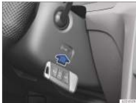
Fig. 87 En el lado derecho de la columna de dirección: función de arranque de emergencia en los vehículos con el sistema de cierre y arranque sin llave "Keyless Access".
