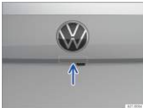
Fig. 51 En el portón trasero: pulsador para abrir el portón (representación esquemática).
