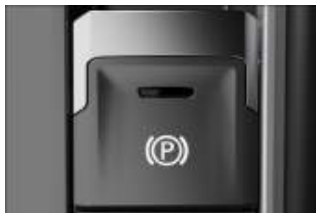
Fig. 115 En la consola central: tecla del freno de estacionamiento electrónico.
