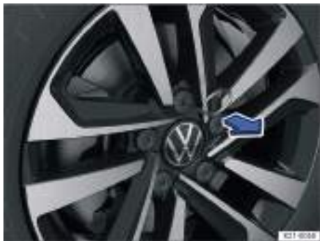
Fig. 190 Retirar las caperuzas de los tornillos de rueda.
