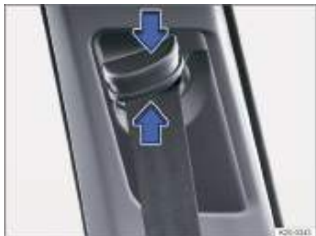
Fig. 27 Junto a los asientos delanteros: regulador de la altura del cinturón.
