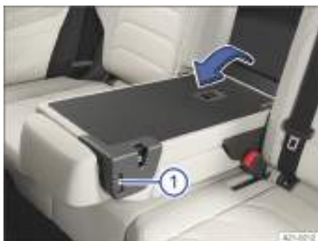
Fig. 200 En el respaldo del asiento trasero: apertura de la trampilla para cargas largas.
