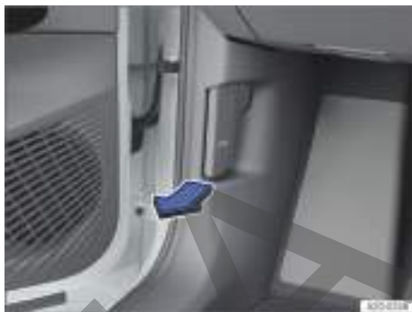
Fig. 237 En la zona reposapiés del lado del conductor: palanca de desbloqueo del capó delantero (representación esquemática).
