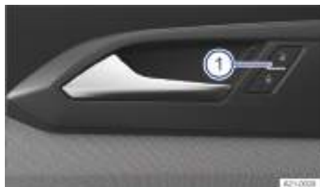
Fig. 63 En la puerta del conductor: tecla del cierre centralizado (representación esquemática).
