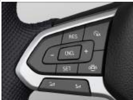
Fig. 146 Lado izquierdo del volante multifunción (variante 1).
