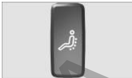
Fig. 105 En la parte inferior del asiento del conductor: tecla de la función de masaje.
