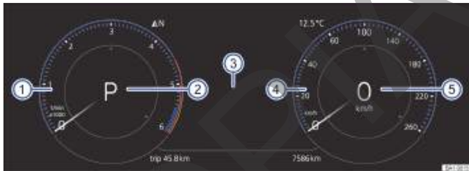
Fig. 10 Cuadro de instrumentos digital, versión Pro, en el tablero de instrumentos (representación esquemática).
