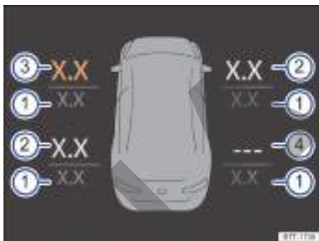
Fig. 249 Representación esquemática de la visualización en la pantalla del cuadro de instrumentos: presiones actuales de los neumáticos.
