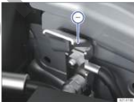
Fig. 229 En el vano motor: toma para la ayuda de arranque (terminal de masa).
