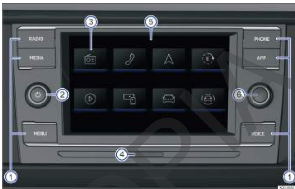
Fig. 187 Cuadro general: unidad de mandos e indicación en la versión de 6,5 pulgadas.
