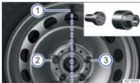
Fig. 259 Cambio de rueda: válvula del neumático ① y lugares de montaje del tornillo de rueda antirrobo ② o ③.
