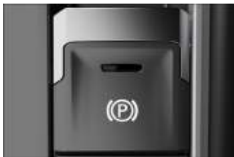
Fig. 163 En la consola central: tecla del freno de estacionamiento electrónico.
