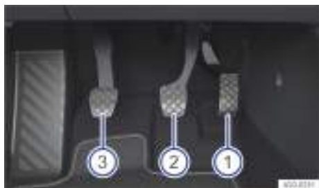
Fig. 125 En la zona reposapiés: pedales en los vehículos con cambio manual.
