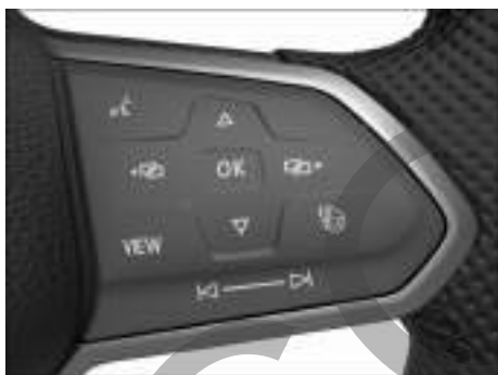
Fig. 12 Lado derecho del volante multifunción: teclas para utilizar los menús y las indicaciones informativas del cuadro de instrumentos digital, versión Pro (variante 2).
