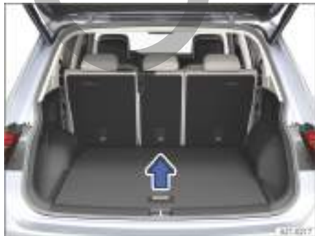
Fig. 191 En el maletero: levantar el piso del maletero.
