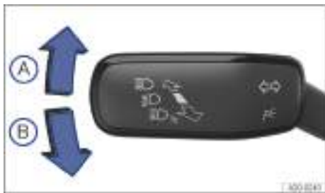
Fig. 106 En el lado izquierdo de la columna de dirección: palanca de los intermitentes y de la luz de carretera.
