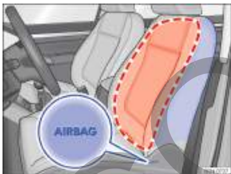
Fig. 41 Lateral de un asiento delantero: ubicación y zona de despliegue del airbag lateral.
