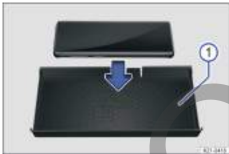
Fig. 188 Representación estándar de la superficie de alojamiento con estera para la función de carga inalámbrica.
