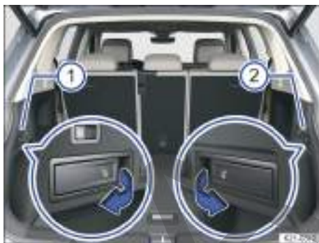
Fig. 89 En el maletero: palancas de desbloqueo a distancia de la parte izquierda ① y la parte derecha ② del respaldo del asiento trasero.
