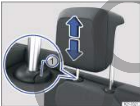
Fig. 98 Representación esquemática: desmontaje de los apoyacabezas de la tercera fila de asientos.
