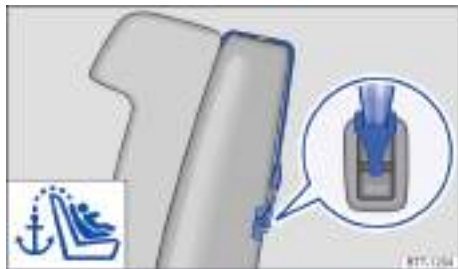
Fig. 50 En la parte posterior de la segunda fila de asientos: anclajes de los cinturones de fijación superior Top Tether.
