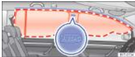
Fig. 42 En el lado izquierdo del vehículo (5 plazas): ubicación y zona de despliegue del airbag para la cabeza.
