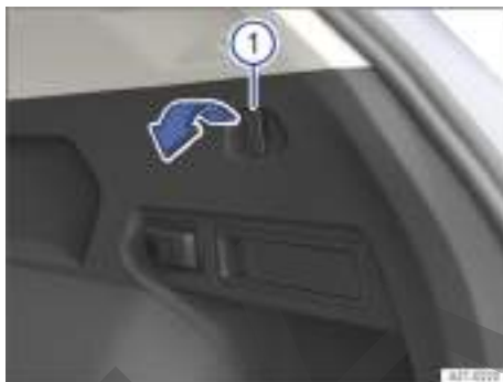
Fig. 199 En el maletero: ganchos desplegables para bolsas.
