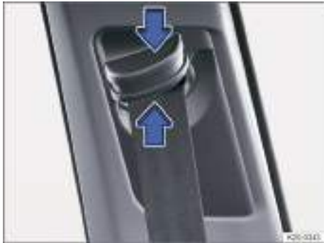
Fig. 34 Junto a los asientos delanteros: regulador de la altura del cinturón.
