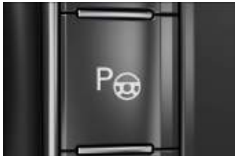
Fig. 170 En la consola central: tecla del sistema de aparcamiento asistido.
