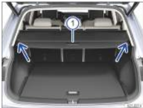
Fig. 189 En el maletero: abrir la cubierta del maletero (representación esquemática).
