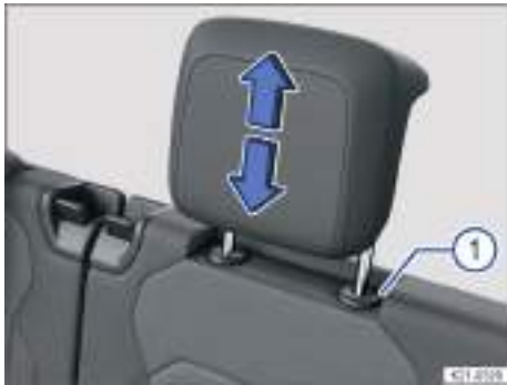
Fig. 97 Representación esquemática: desmontaje de los apoyacabezas de la segunda fila de asientos.
