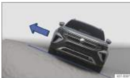
Fig. 145 Representación esquemática: bajar del vehículo siempre por el lado que mira a la cima.
