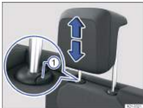
Fig. 94 Representación esquemática: ajuste de los apoyacabezas de la tercera fila de asientos.
