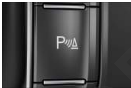
Fig. 166 En la consola central: tecla de la ayuda de aparcamiento
