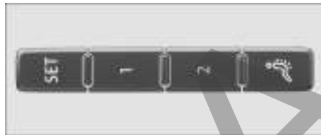
Fig. 103 En el lateral exterior del asiento del conductor: teclas de memoria.
