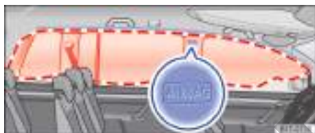
Fig. 43 En el lado izquierdo del vehículo (7 plazas): ubicación y zona de despliegue del airbag para la cabeza.
