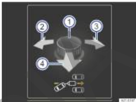
Fig. 176 En la pantalla del cuadro de instrumentos: accionar el mando giratorio en la puerta del conductor.
