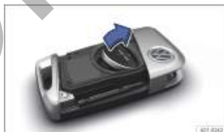
Fig. 58 Llave del vehículo: cambiar la pila de botón.
