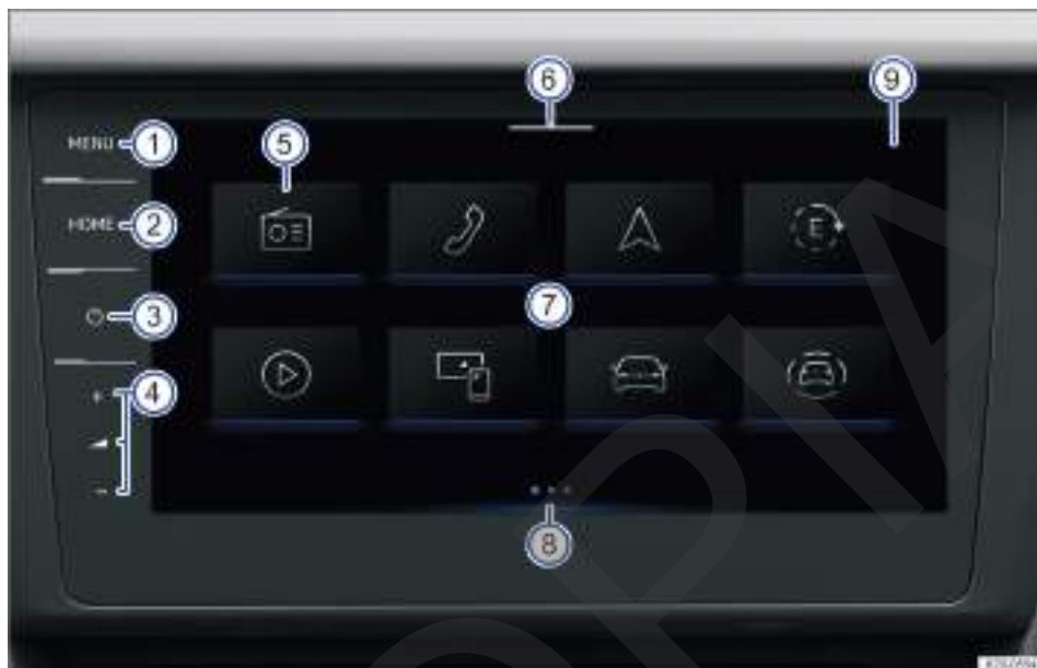
Fig. 185 Cuadro general: unidad de mandos e indicación en la versión de 9,2 pulgadas.
