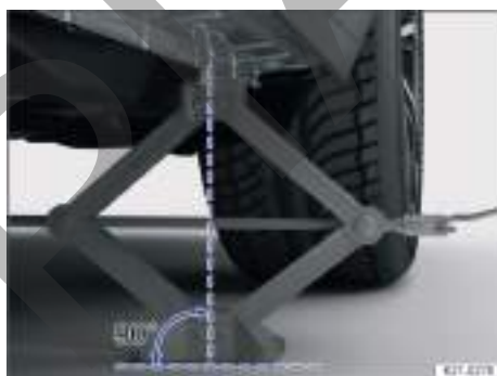
Fig. 265 Gato colocado en el lado izquierdo del vehículo, en la zona trasera.
