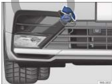
Fig. 235 En el lado derecho del paragolpes delantero: enroscar la argolla de remolque.
