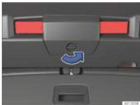
Fig. 75 En el portón del maletero: abrir el soporte del triángulo de preseñalización.
