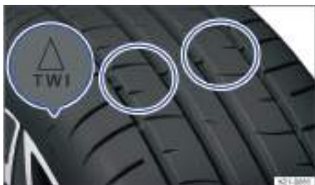
Fig. 253 Perfil del neumático: indicadores de desgaste.
