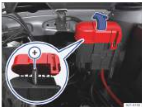
Fig. 230 En el vano motor debajo de una cubierta: toma para la ayuda de arranque (polo positivo).
