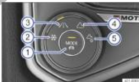
Fig. 140 En la consola central: mando giratorio del 4MOTION Active Control.
