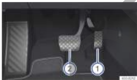
Fig. 126 En la zona reposapiés: pedales en los vehículos con cambio automático.
