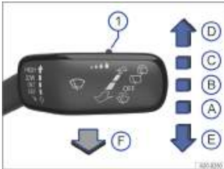
Fig. 112 En el lado derecho de la columna de dirección: manejo del limpiaparabrisas.
