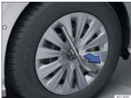
Fig. 256 Desmontar el tapacubos integral.
