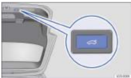
Fig. 72 En el portón del maletero abierto: tecla para el cierre eléctrico del portón.
