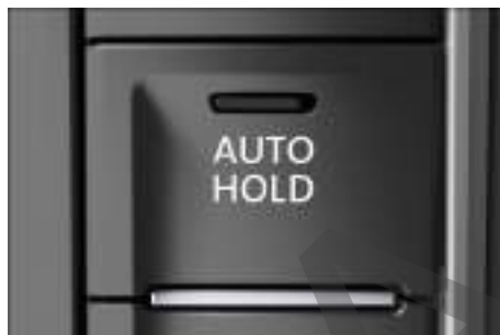
Fig. 164 En la consola central: tecla de la función Auto-Hold.
