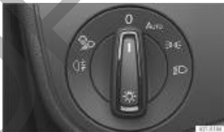
Fig. 107 Junto al volante: mando de las luces (una variante).
