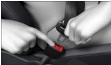
Fig. 31 Soltar la lengüeta del cierre del cinturón.
