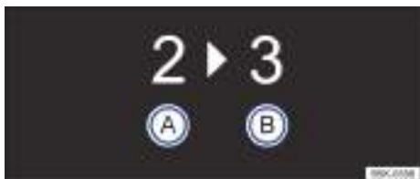
Fig. 127 En la pantalla del cuadro de instrumentos: recomendación de marcha.
