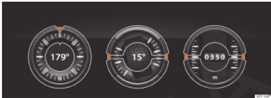
Fig. 141 En el sistema de infotainment: indicador Offroad.
