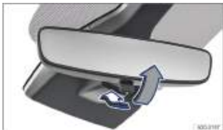
Fig. 116 En el parabrisas: retrovisor interior antideslumbrante manual.
