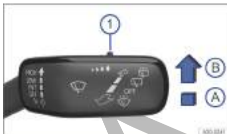
Fig. 114 En el lado derecho de la columna de dirección: palanca del limpiacristales.
