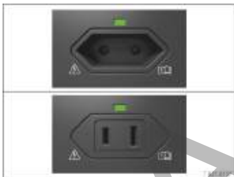
Fig. 183 En el lado izquierdo del maletero: toma de corriente de 230, 115 o 100 voltios.
