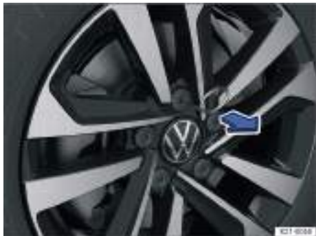
Fig. 257 Retirar las caperuzas de los tornillos de rueda.
