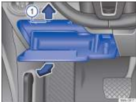
Fig. 224 Junto al volante, en el lado izquierdo: tapa de la caja de fusibles del tablero de instrumentos (vehículos con el volante a la izquierda).
