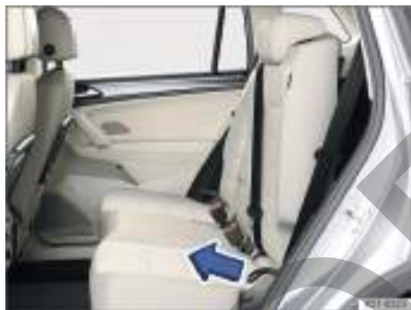
Fig. 88 Asiento trasero: abatir y levantar el respaldo.
