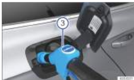
Fig. 213 Detrás de la tapa del depósito de combustible: repostar AdBlue con la pistola de un surtidor (representación esquemática).
