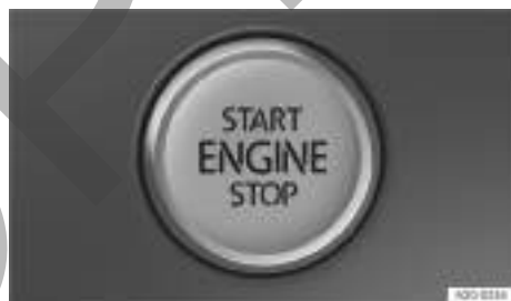
Fig. 131 En la parte inferior de la consola central: pulsador de encendido y arranque para poner el motor en marcha.
