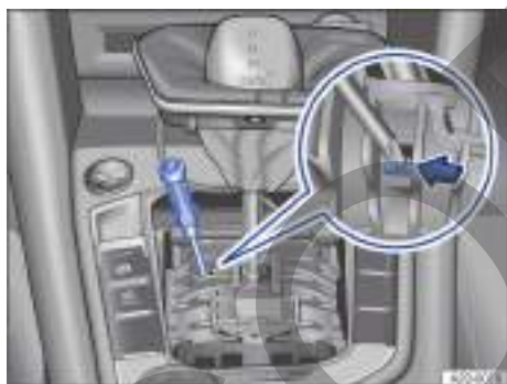
Fig. 137 Realizar un desbloqueo de emergencia de la palanca selectora (variante 1).
