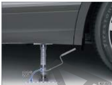
Fig. 264 Alineación correcta del gato.
