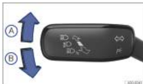
Fig. 109 En el lado izquierdo de la columna de dirección: palanca de los intermitentes y de la luz de carretera.
