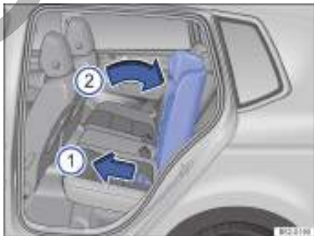
Fig. 87 Ajuste del respaldo del asiento trasero.
