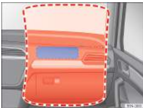
Fig. 38 Ubicación y zona de despliegue del airbag frontal del acompañante.
