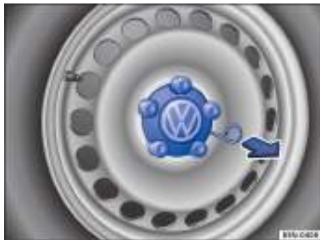
Fig. 255 Desmontar el tapacubos central tirando de él.
