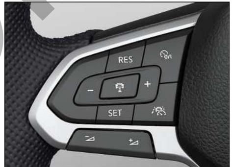
**Fig. 118** Lado izquierdo del volante multifunción (variante 1).
