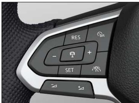
**Fig. 123** Lado izquierdo del volante multifunción (variante 1).
