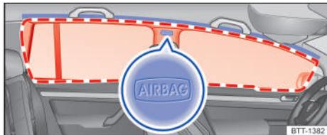
**Fig. 38** En el lado izquierdo del vehículo: ubicación y zona de despliegue del airbag para la cabeza.
