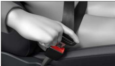
**Fig. 26** Insertar la lengüeta del cinturón de seguridad en su cierre.
