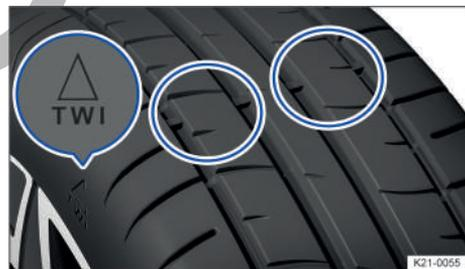
**Fig. 182** Perfil del neumático: indicadores de desgaste.
