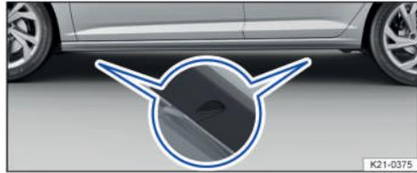
Fig. 192 Puntos de apoyo para el gato (variante 2).
