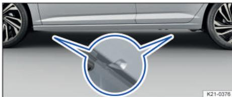
Fig. 191 Puntos de apoyo para el gato (variante 1).
