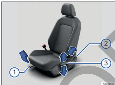
Fig. 67 En el asiento del conductor: mandos.
