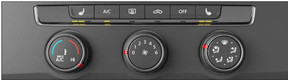
Fig. 93 En la parte superior de la consola central: panel de mandos del climatizador manual.
