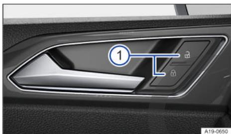
**Fig. 56** En la puerta del conductor: tecla del cierre centralizado.
