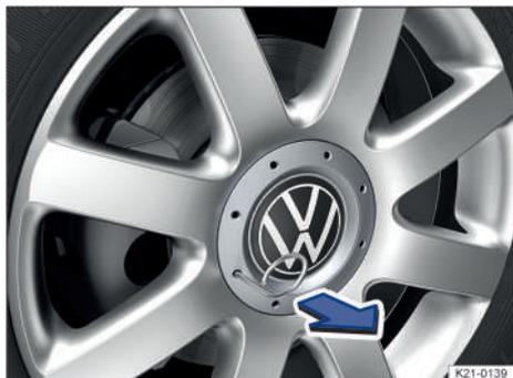
Fig. 184 Desmontar el tapacubos central tirando de él.
