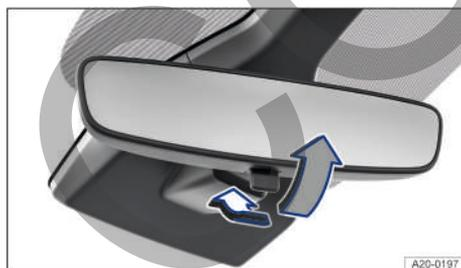
**Fig. 89** En el parabrisas: retrovisor interior antideslumbrante manual.
