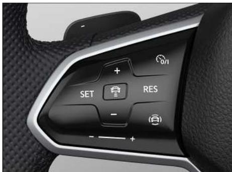
**Fig. 112** Lado izquierdo del volante multifunción (variante 2).
