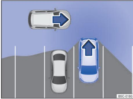
**Fig. 131** Representación esquemática del asistente de salida del aparcamiento: zona vigilada alrededor del vehículo que está desaparcando.
