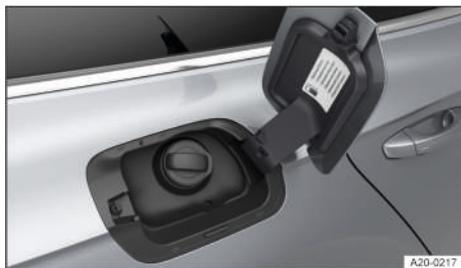
Fig. 144 Detrás de la tapa del depósito de combustible: tapón del depósito (representación esquemática).
