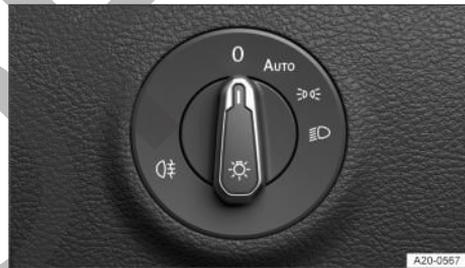
**Fig. 82** Junto al volante: mando de las luces (una variante).
