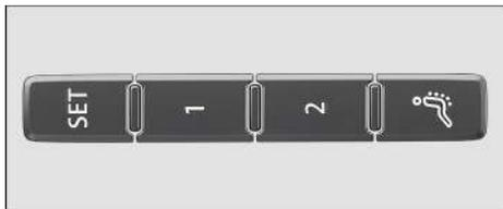
**Fig. 80** En el lateral exterior del asiento del conductor: teclas de memoria.
