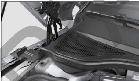
**Fig. 198** Entre el vano motor y el parabrisas: caja de aguas (representación esquemática).
