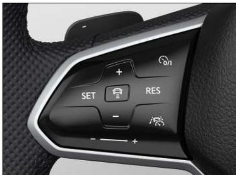
**Fig. 119** Lado izquierdo del volante multifunción (variante 2).
