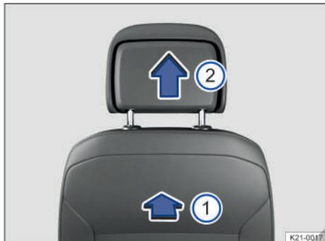
Fig. 74 Apoyacabezas delantero: desmontaje.
