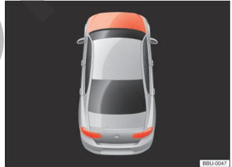
**Fig. 169** En la pantalla del cuadro de instrumentos: capó delantero abierto o no cerrado correctamente (representación esquemática).
