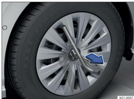
Fig. 185 Desmontar el tapacubos integral.
