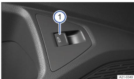
**Fig. 61** En la puerta del conductor: tecla de desbloqueo del portón del maletero.
