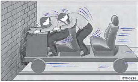
Fig. 23 Un vehículo con los ocupantes sin cinturones de seguridad choca contra el muro.
