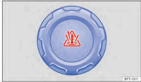
Fig. 194 En el compartimento del motor: tapa del depósito de expansión del líquido refrigerante del motor.
