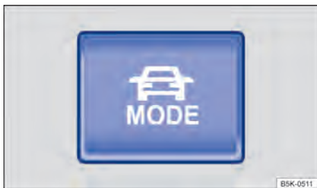
Fig. 95 En la parte superior de la consola central: tecla MODE de selección del perfil de conducción.
