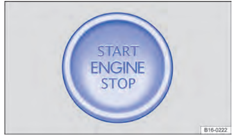
Fig. 87 En la parte inferior de la consola central: tecla de arranque para poner en marcha el motor
