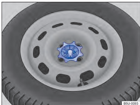
Fig. 202 En el maletero: manivela para fijación de la rueda de emergencia.
