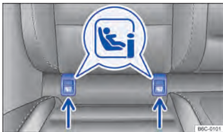
Fig. 41 En el asiento del vehículo: identificación de los puntos de anclaje inferiores de asientos para niños.
