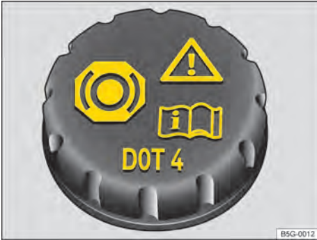
Fig. 195 En el compartimento del motor: tapón de cierre del depósito del líquido de frenos.
