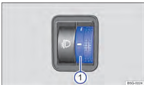
Fig. 71 Al lado del volante: ajustador de alcance de faros ①
