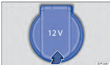
Fig. 125 En la consola central delantera: toma de corriente de 12 V.
