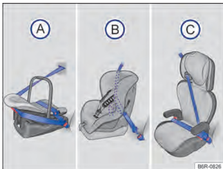
Fig. 39 Las ilustraciones A, B y C muestran la fijación del sistema de retención infantil solo con el cinturón de seguridad del vehículo.
