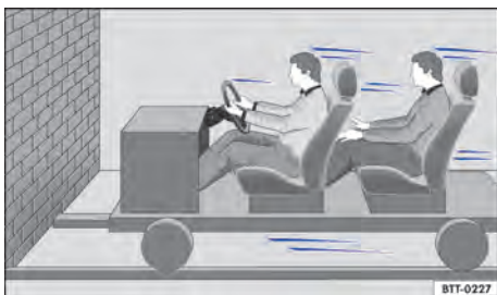
Fig. 22 Un vehículo con los ocupantes sin cinturones de seguridad está camino a chocar contra un muro. ▶
