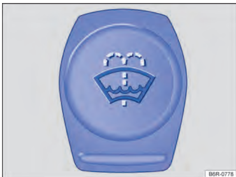
Fig. 190 En el compartimento del motor: tapón de cierre del depósito de agua de los lavacrystales.
