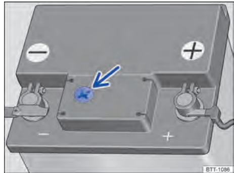
Fig. 196 En el compartimento del motor: ejemplo de posición del visor en el lado superior de la batería del vehículo.
