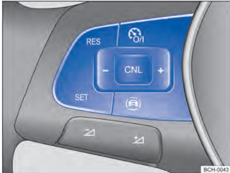
Fig. 96 Lado izquierdo del volante multifunción (variante 1): teclas para controlar el GRA.
