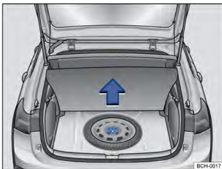
Fig. 170 En el maletero, por debajo del revestimiento del piso: rueda de emergencia y herramientas de a bordo.
