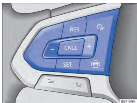
Fig. 99 Lado izquierdo del volante multifunción (variante 2): teclas para controlar el limitador de velocidad.
