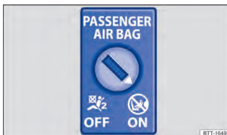
Fig. 35 En el panel de instrumentos en el lado del acompañante delantero: interruptor accionado por la llave para desconectar y conectar el airbag frontal del acompañante delantero.
