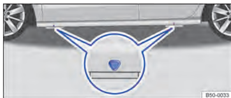
Fig. 205 Puntos de apoyo del gato.
