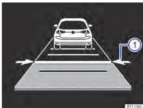
Fig. 105 En la pantalla del cuadro de instrumentos: ajustar la distancia (representación esquemática, el ACC regula).
