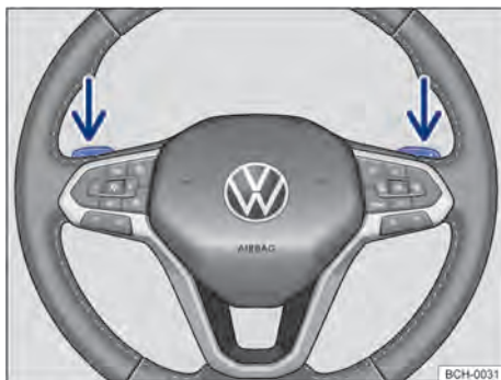
Fig. 93 Volante con selectores basculantes de Tiptronic.
