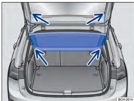
Fig. 166 En el maletero: desmontar y montar la bandeja trasera.
