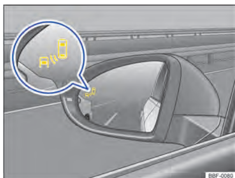
Fig. 109 En los retrovisores exteriores: indicador de detector de ángulo muerto.
