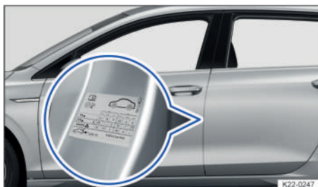
Fig. 185 En el pilar de la puerta del conductor: adhesivo de la presión de los neumáticos (o en la cara interior de la tapa del depósito de combustible).
