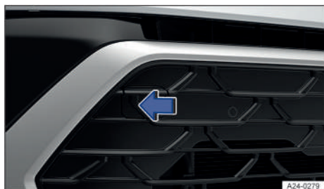
Fig. 166 En el lado derecho del paragolpes delantero: retirar la tapa.
