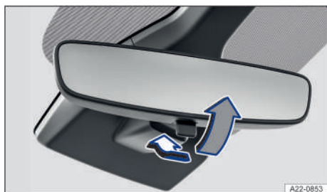
Fig. 81 En el parabrisas: retrovisor interior antideslumbrante manual.
