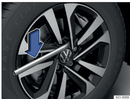
Fig. 197 Desenroscar los tornillos de rueda con la llave de rueda.
