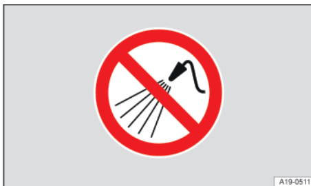
Fig. 200 En el vano delantero: no utilizar ningún equipo de limpieza de alta presión.
