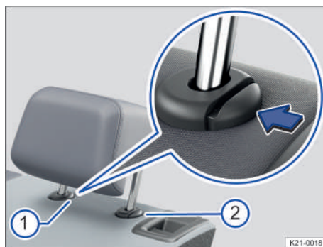
Fig. 68 Desmontaje de los apoyacabezas traseros (representación esquemática).
