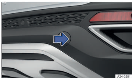
Fig. 168 En el lado derecho del paragolpes trasero: retirar la tapa.
