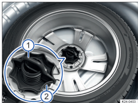
Fig. 191 Debajo del piso del maletero: ruedecilla para fijar la rueda de repuesto.
