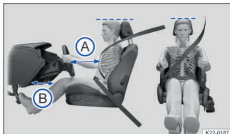
Fig. 24 Distancia correcta entre el conductor y el volante, colocación correcta de la banda del cinturón y ajuste correcto del apoyacabezas (representación esquemática).
