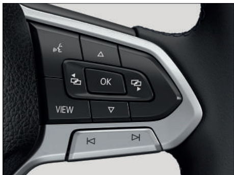
Fig. 10 Lado derecho del volante multifunción: manejo del cuadro de instrumentos digital Pro (representación esquemática).
