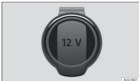
Fig. 132 En el portaobjetos de la parte delantera de la consola central: toma de corriente de 12 voltios con tapa plegable (representación esquemática).
