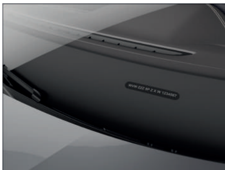
Fig. 207 En el parabrisas: número de identificación del vehículo.
