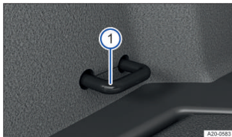
Fig. 139 En el maletero: argollas de amarre (representación esquemática).
