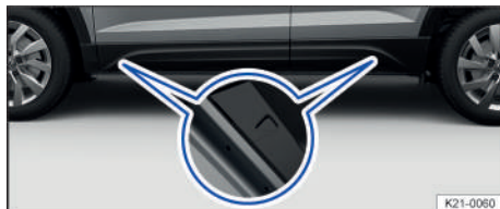
Fig. 194 En el larguero inferior: marcas para los puntos de alojamiento del gato.
