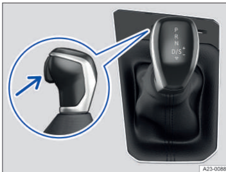
Fig. 91 En la consola central: palanca selectora del cambio automático (representación esquemática).
