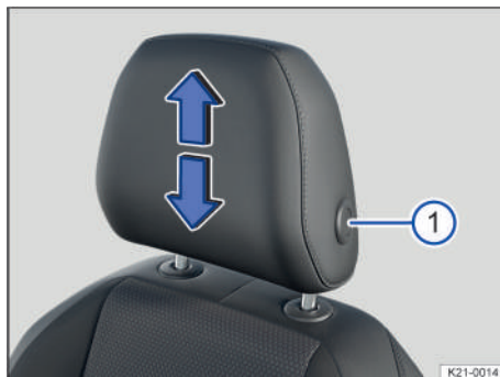
Fig. 65 Desmontaje de los apoyacabezas delanteros (representación esquemática).
