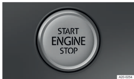
Fig. 88 En la parte inferior de la consola central: pulsador de encendido y arranque.
