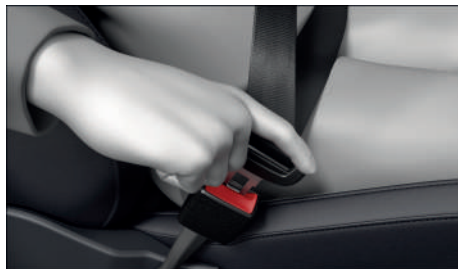
Fig. 25 Insertar la lengüeta del cinturón de seguridad en su cierre (representación esquemática).
