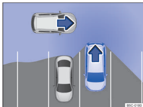
Fig. 126 Zona vigilada alrededor del vehículo que está desaparcando (representación esquemática).
