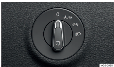
Fig. 73 Junto al volante: mando de las luces.
