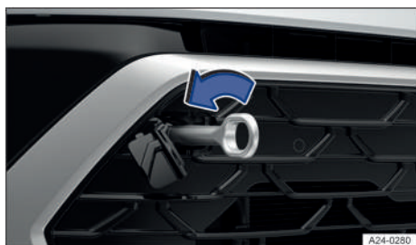
Fig. 167 En el lado derecho del paragolpes delantero: enroscar la argolla de remolque.
