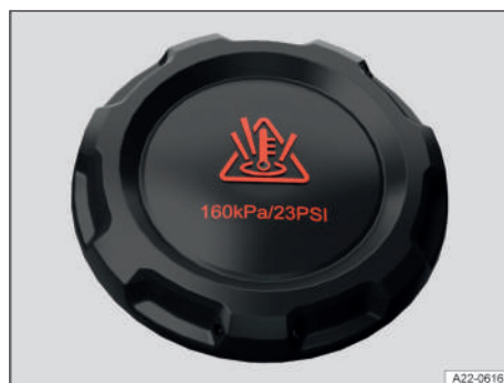
Fig. 179 En el vano delantero: tapa del depósito de expansión del líquido refrigerante (representación esquemática).
