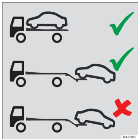
Fig. 165 Transportar con una grúa.
