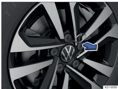
Fig. 192 Retirar las caperuzas de los tornillos de rueda.
