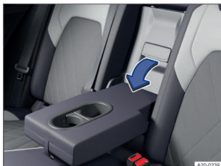
Fig. 141 En el respaldo del asiento trasero: trampilla para cargas largas (representación esquemática).
