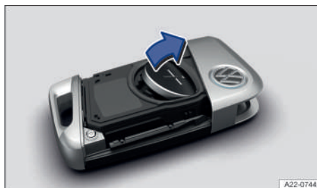
Fig. 46 Llave del vehículo: cambiar la pila de botón.
