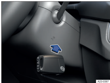
Fig. 89 En el lado derecho de la columna de dirección: función de arranque de emergencia en los vehículos con el sistema de cierre y arranque sin llave "Keyless Access" (representación esquemática).
