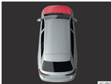
Fig. 173 En la pantalla del cuadro de instrumentos: capó delantero abierto o no cerrado correctamente (representación esquemática).
