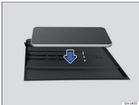
Fig. 133 En la consola central: estera permeable al aire para la función de carga inalámbrica (representación esquemática). La potencia de carga es de 15 W.
