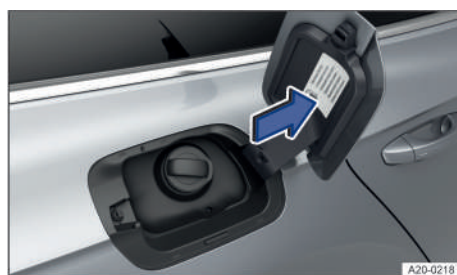
Fig. 143 En la cara interior de la tapa del depósito de combustible: adhesivo del combustible (representación esquemática).
