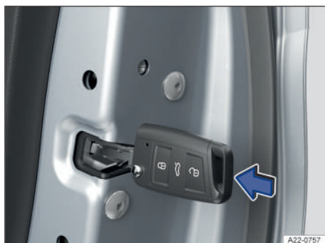
Fig. 53 En el frontal de la puerta trasera: bloqueo de emergencia del vehículo con el paletón de la llave o la llave de emergencia (variante 2).
