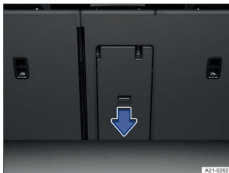
Fig. 142 En el maletero: parte trasera de la trampilla para cargas largas (representación esquemática).
