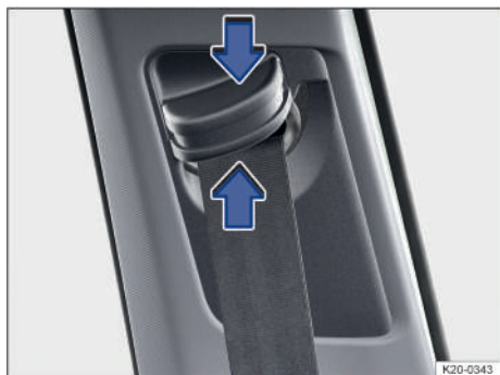
Fig. 29 Junto a los asientos delanteros: regulador de la altura del cinturón.
