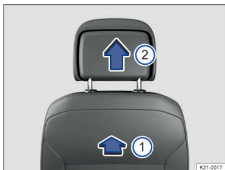
Fig. 67 Desmontaje de los apoyacabezas delanteros (representación esquemática).
