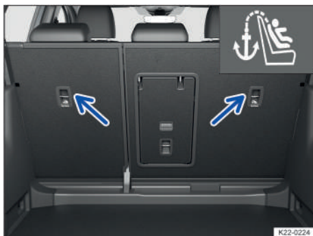
Fig. 39 En la parte posterior de los asientos traseros: anclajes Top Tether para el cinturón de fijación superior Top Tether (representación esquemática).
