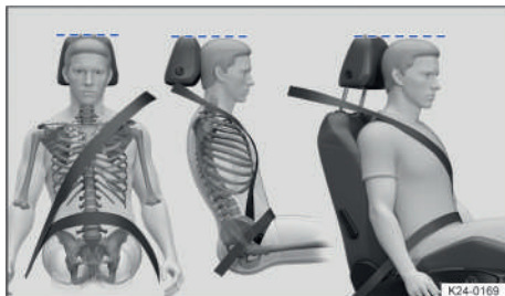
Fig. 27 Colocación correcta de la banda del cinturón y ajuste correcto del apoyacabezas (representación esquemática).
