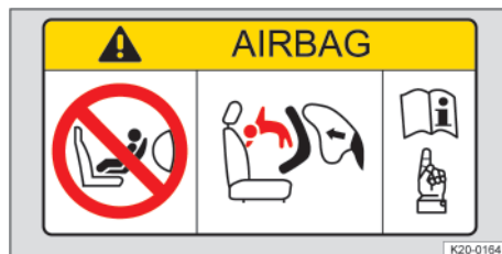
Fig. 36 En el parasol: etiqueta adhesiva relativa al airbag (representación esquemática).
