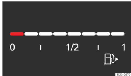
Fig. 14 En el cuadro de instrumentos digital Basic: indicador del nivel de combustible (representación esquemática).
