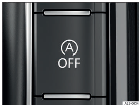
Fig. 90 En la parte inferior de la consola central o, en función del equipamiento, en el sistema de infotainment: tecla del sistema Start-Stop.
