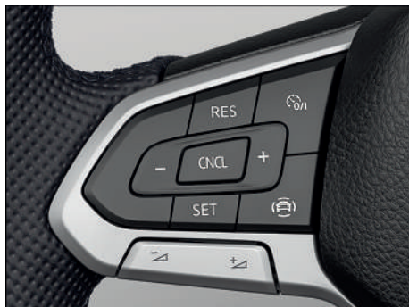
Fig. 104 Lado izquierdo del volante multifunción.
