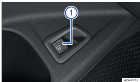
Fig. 149 En la puerta del conductor: tecla de desbloqueo de la tapa del depósito de combustible (representación esquemática).
