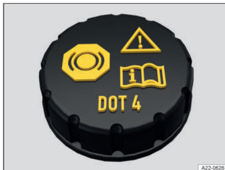
Fig. 181 En el vano delantero: tapa del depósito del líquido de frenos.
