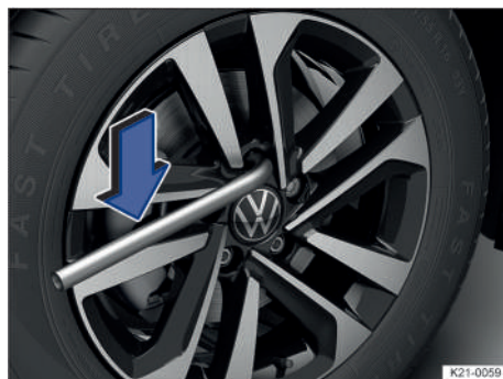
Fig. 193 Aflojar los tornillos de rueda.
