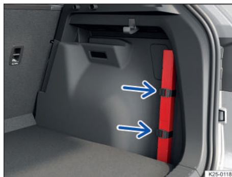
Fig. 41 En el lado derecho del maletero: soporte del triángulo de preseñalización.
