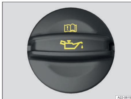
Fig. 177 En el vano delantero: tapa de la boca de llenado del aceite del motor (representación esquemática).
