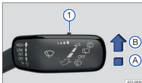
Fig. 79 En el lado derecho de la columna de dirección: palanca del limpiacristales.
