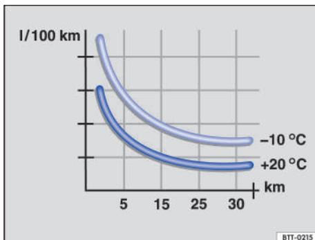
Fig. 103 Consumo de combustible en l/100 km a dos temperaturas ambiente diferentes.
