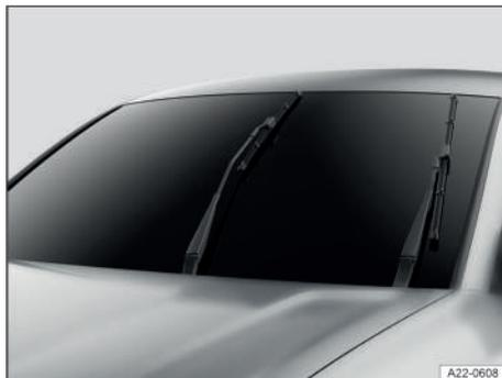
Fig. 142 Limpiacristales en posición de servicio (representación esquemática).
