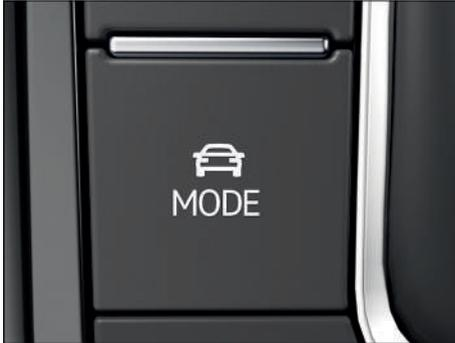
**Fig. 100** En la consola central: tecla MODE para seleccionar los perfiles de conducción.
