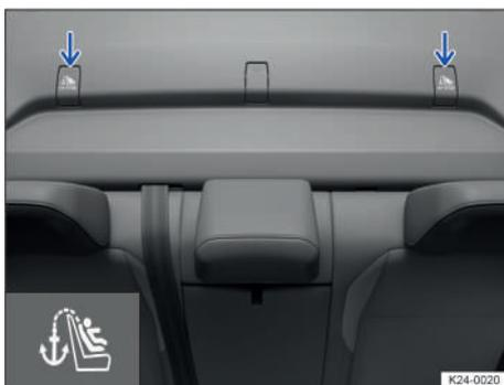
**Fig. 37** En la bandeja situada detrás de los asientos traseros: anclajes Top Tether para el cinturón de fijación superior (Top Tether).
