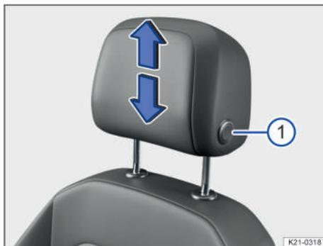
**Fig. 66** Desmontaje de los apoyacabezas delanteros (representación esquemática).
