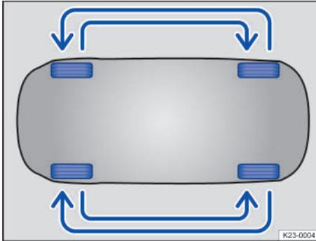
Fig. 179 Esquema para el intercambio de las ruedas (representación esquemática).
