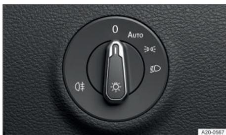
**Fig. 76** Junto al volante: mando de las luces (una variante).
