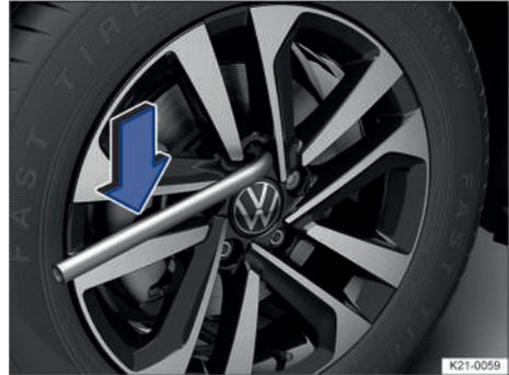
Fig. 185 Aflojar los tornillos de rueda.
