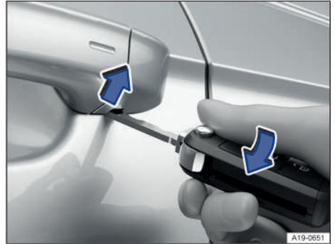
Fig. 50 Manilla de la puerta del conductor: desprender la caperuzca haciendo palanca.
