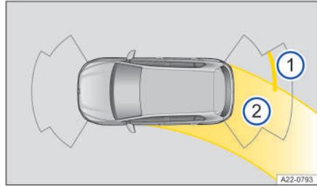
Fig. 120 Sistema de infotainment: visualización de la ayuda de aparcamiento con sensores traseros y delanteros (en función del equipamiento).
