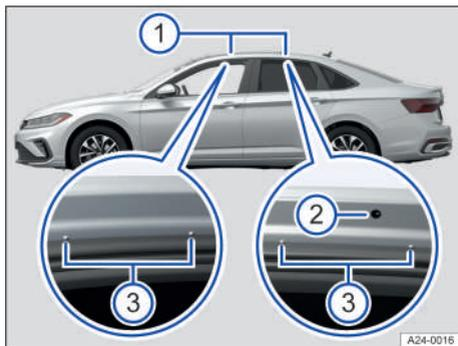
Fig. 133 Puntos de fijación para los soportes básicos.
