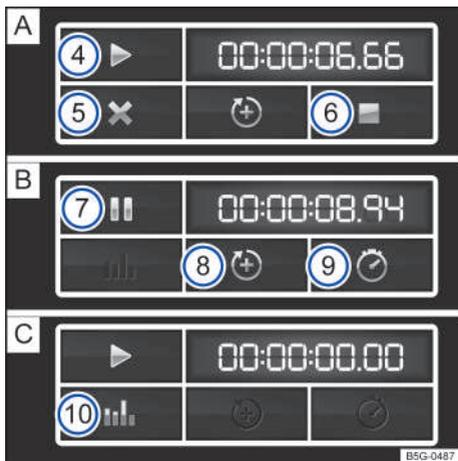
**Fig. 18** Botones de función en la pantalla del sistema de infotainment: cronometraje en caso de una vuelta **A** detenida, **B** en curso y **C** finalizada.
