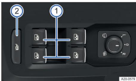
Fig. 57 En la puerta del conductor: teclas de los elevavinas.
