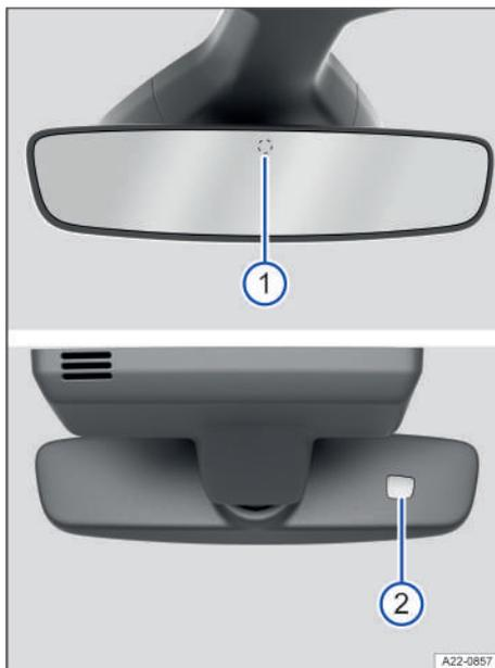
**Fig. 83** En el parabrisas: retrovisor interior antideslumbrante automático.
