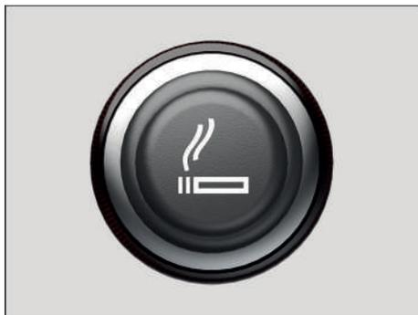
**Fig. 126** En la parte inferior de la consola central: encendedor (en función del equipamiento).
