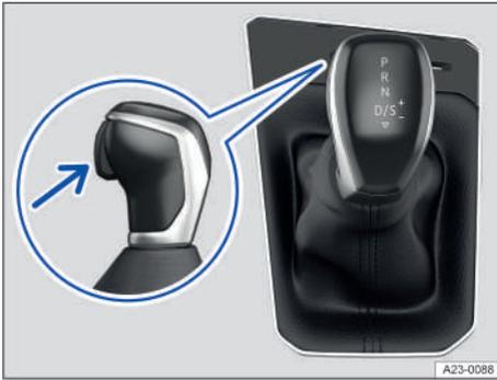
**Fig. 95** En la consola central: palanca selectora del cambio automático (representación esquemática).
