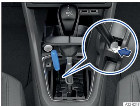
**Fig. 98** En la consola central: realizar un desbloqueo de emergencia de la palanca selectora (variante 1).
