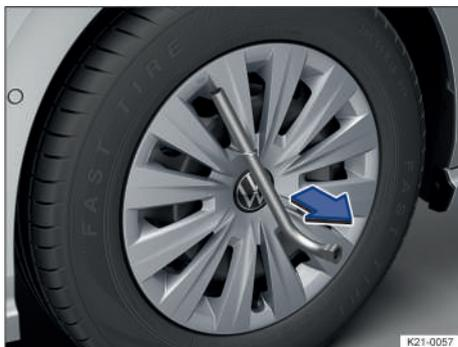
Fig. 183 Desmontar el tapacubos integral.
