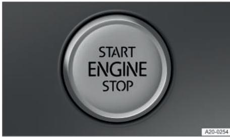
**Fig. 91** En la parte inferior de la consola central: pulsador de encendido y arranque.
