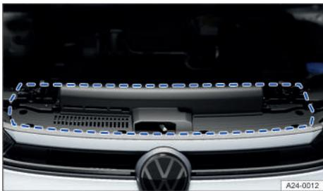
**Fig. 167** Zona para el adhesivo relativo al aceite del motor (representación esquemática).
