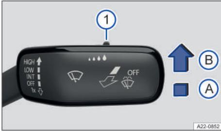
**Fig. 82** En el lado derecho de la columna de dirección: palanca del limpiacrystalles.
