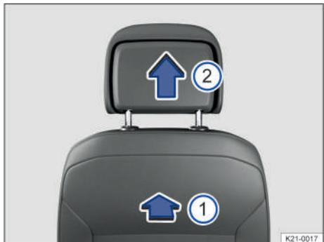
**Fig. 68** Desmontaje de los apoyacabezas delanteros (representación esquemática).
