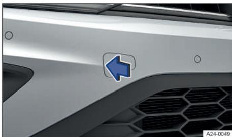
Fig. 155 En el lado derecho del paragolpes delantero: retirar la tapa, variante 2.
