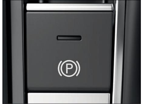
**Fig. 117** En la consola central: tecla del freno de estacionamiento electrónico.
