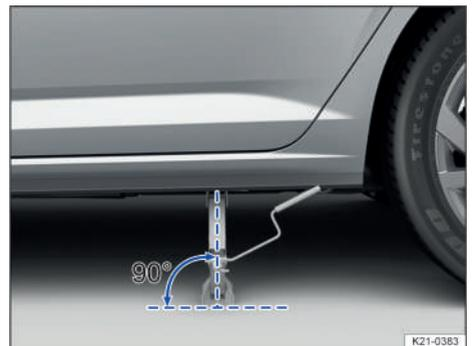
Fig. 190 Alineación correcta del gato (variante 2).
