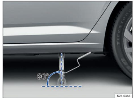
Fig. 188 Alineación correcta del gato (variante 1).
