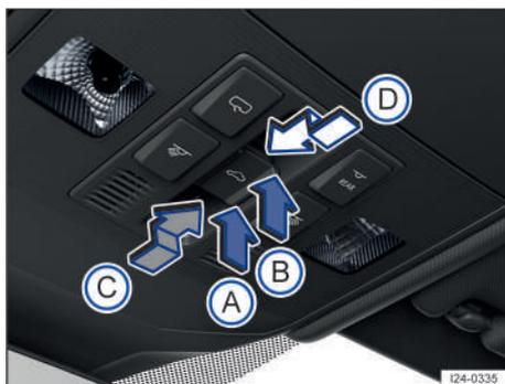
Fig. 58 En el revestimiento interior del techo: tecla del techo de cristal.
