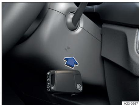
**Fig. 92** En el lado derecho de la columna de dirección: función de arranque de emergencia en los vehículos con el sistema de cierre y arranque sin llave "Keyless Access" (representación esquemática).
