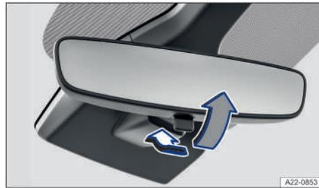
**Fig. 84** En el parabrisas: retrovisor interior antideslumbrante manual.
